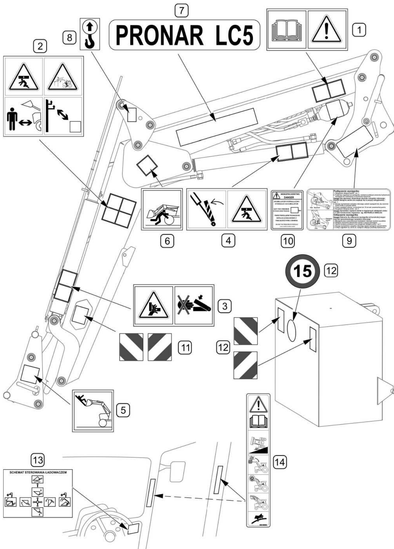
RYSUNEK 2.1 Rozmieszczenie naklejek informacyjnych i ostrzegawczych
