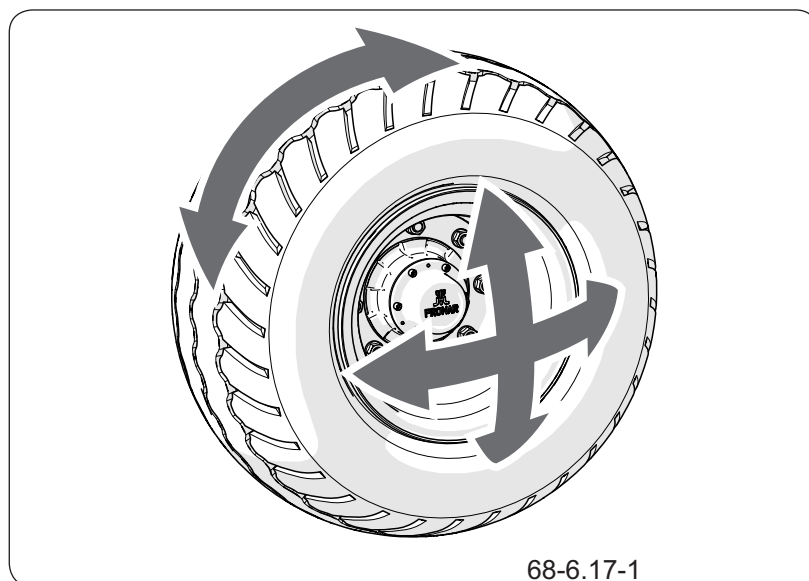
Рисунок 6.6 Проверка люфта подшипников
