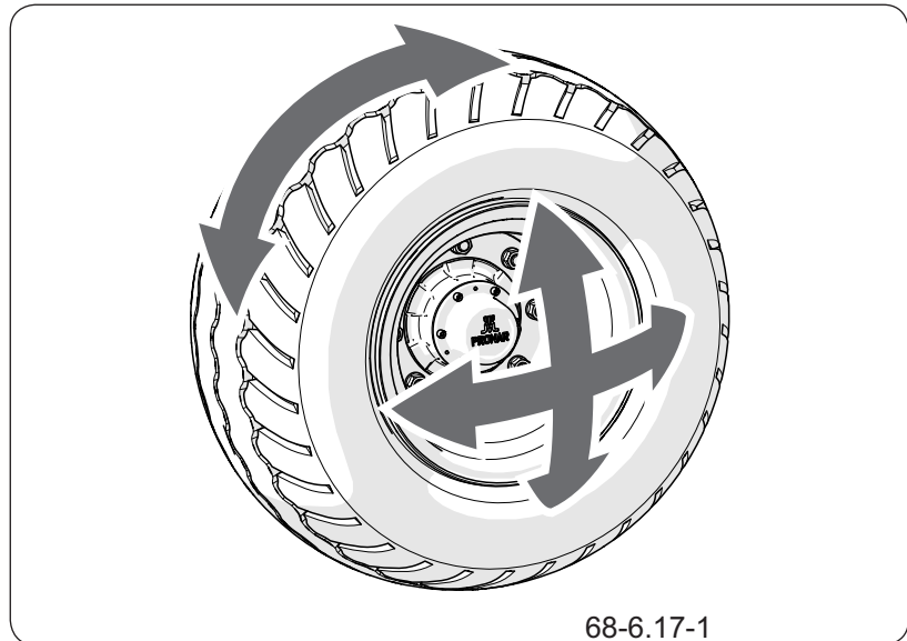
Figure 6.6 Contrôle du jeu des roulements
