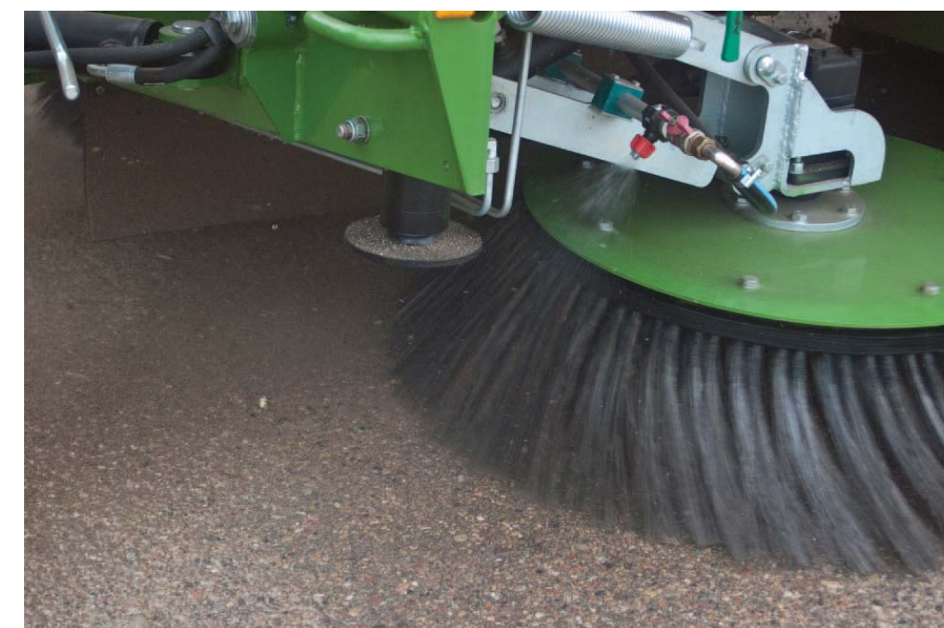
W ZMC 3.0 zamontowano system zraszania zamiatanej powierzchni
