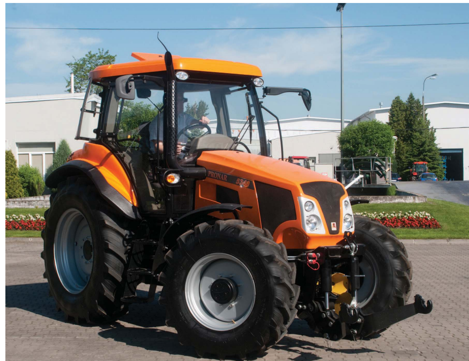
Przedni podnośnik (TUZ) daje wiele dodatkowych możliwości wykorzystania ciągnika nie tylko do prac związanych z rolnictwem, ale także przy pracach komunalnych
