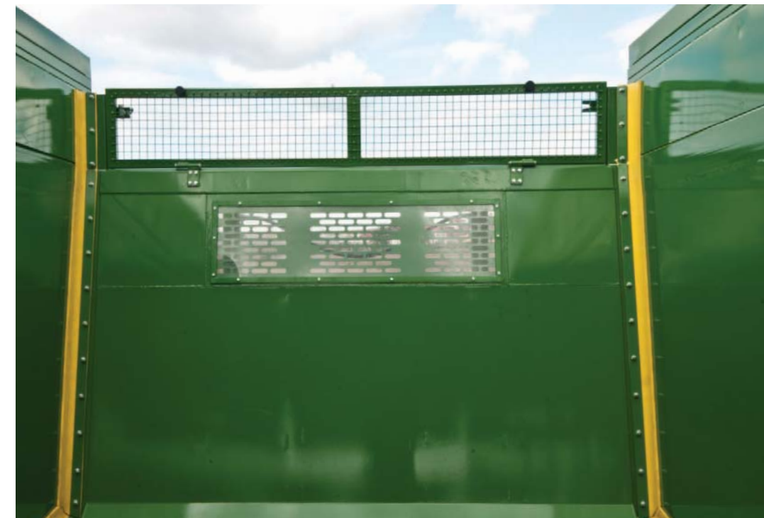
Funkcję przesuwnej ściany (power push) przewidziano do prac z wszelkiego rodzaju ładunkami
