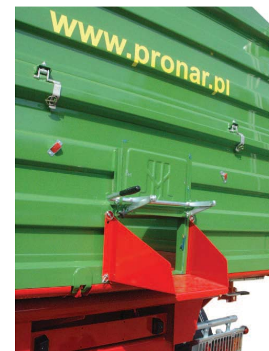
Szyber zsygowy do ziarna w ścianie tylnej
