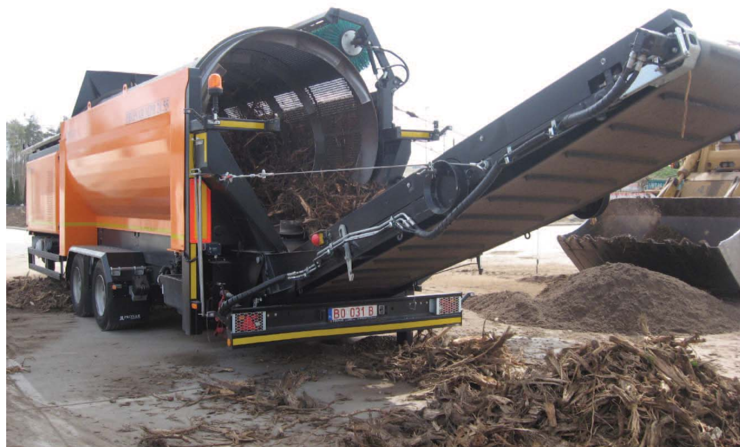
W procesie kompostowania wykorzystywane są mobilne przesiewacze PRONAR, jako maszyny do przesiewania i przetrzucia biostabilizatu
