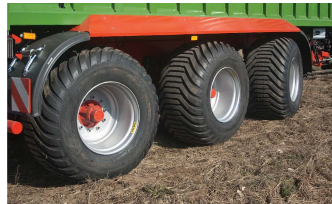
Przyczepa dzięki skrętnej osi przedniej i tylnej pojazdu podąża dokładnie za ciągnikiem
