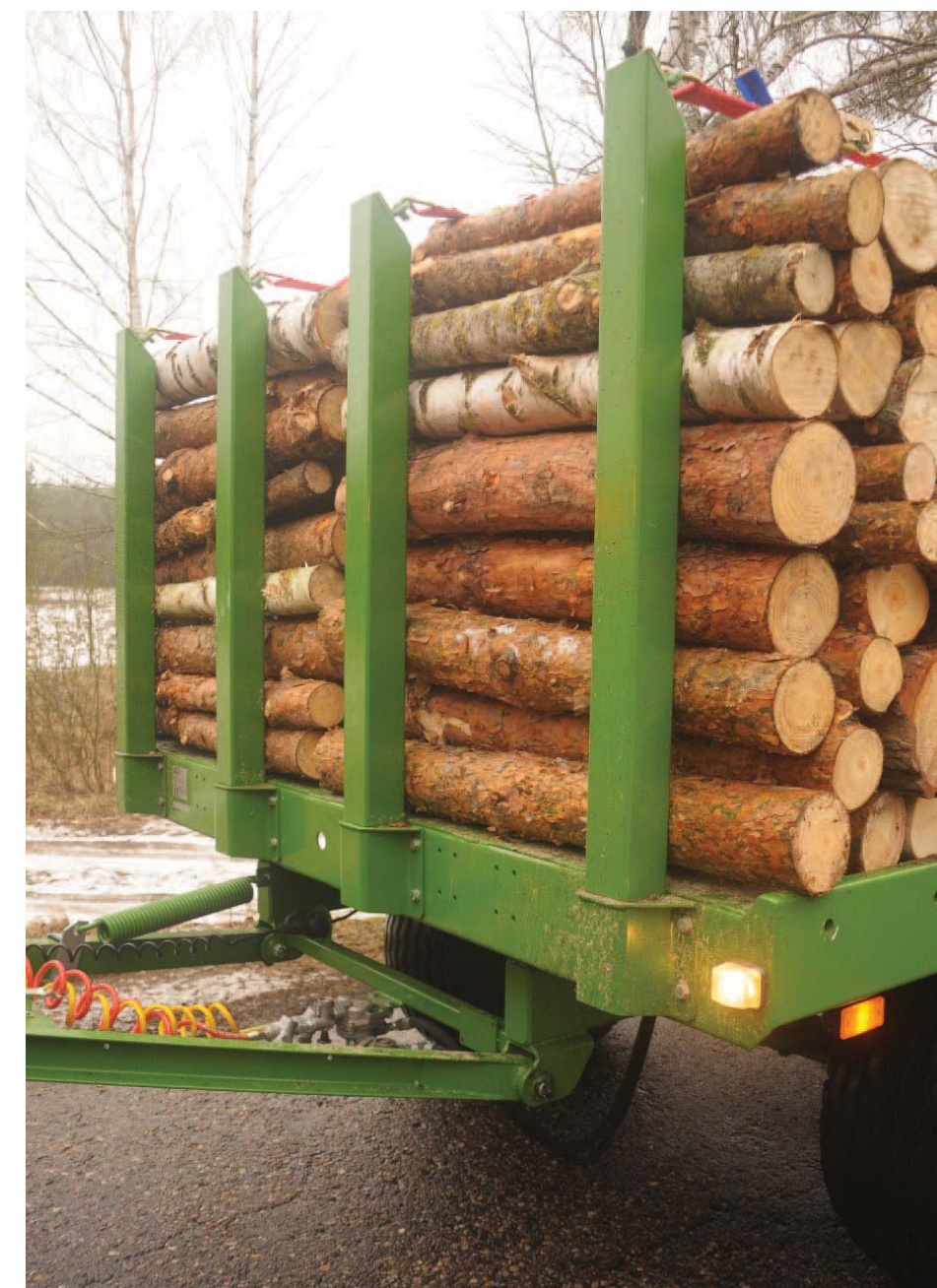
Przyczepę PRONAR T026KM można wyposażyć w 4 kłonicy tylne
