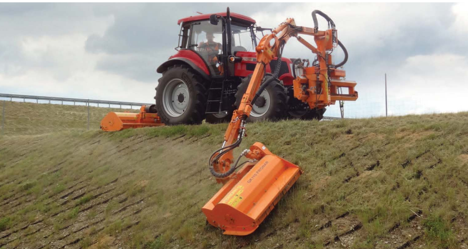
Ciągnik PRONAR 5340 z wysięgnikiem wielofunkcyjnym WWP500, głowicą koszącą GK110 i tylną kosiarką bijakową BK160
