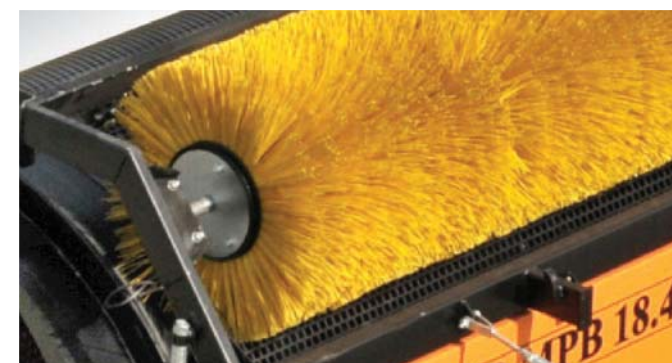
Szczotka czyszcząca bęben - podnoszona i opuszczana hydraulicznie
