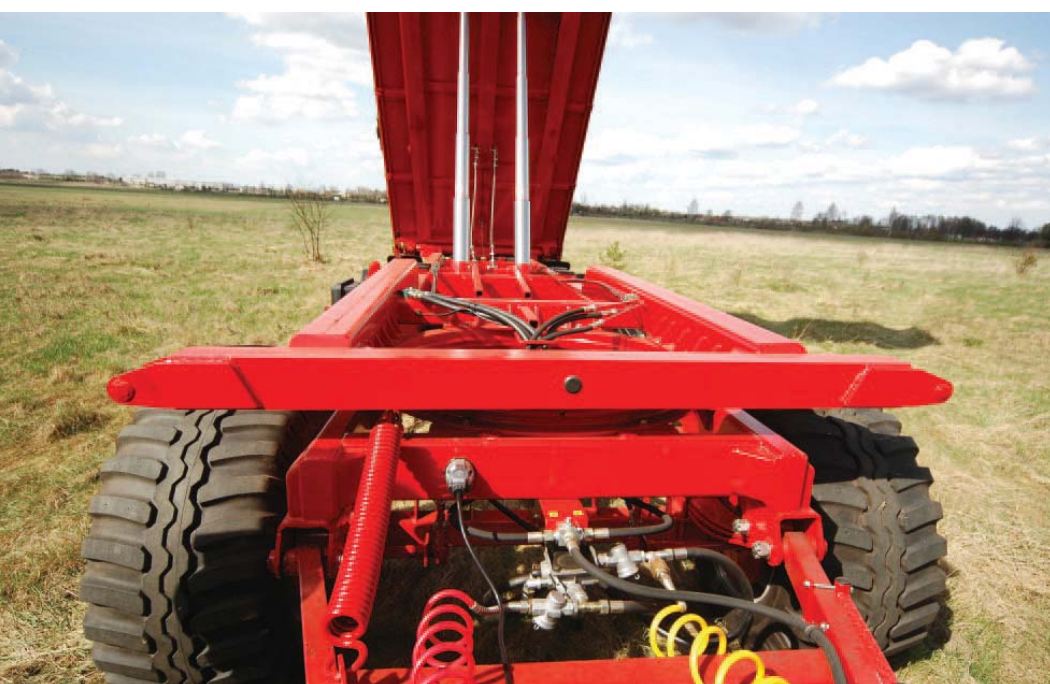
Przyczepa PRONAR T780 jest standardowo wyposażona w instalację hydrauliczną z dwoma cylindrami teleskopowymi
