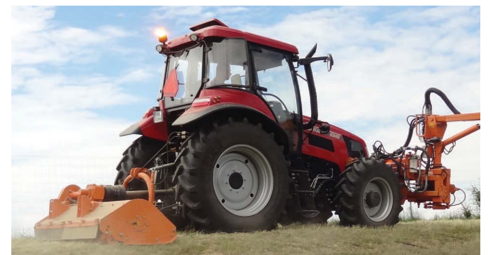
Kosiarka bijakowa BK160 montowana z tyłu ciągnika zwiększa wydajność zestawu
