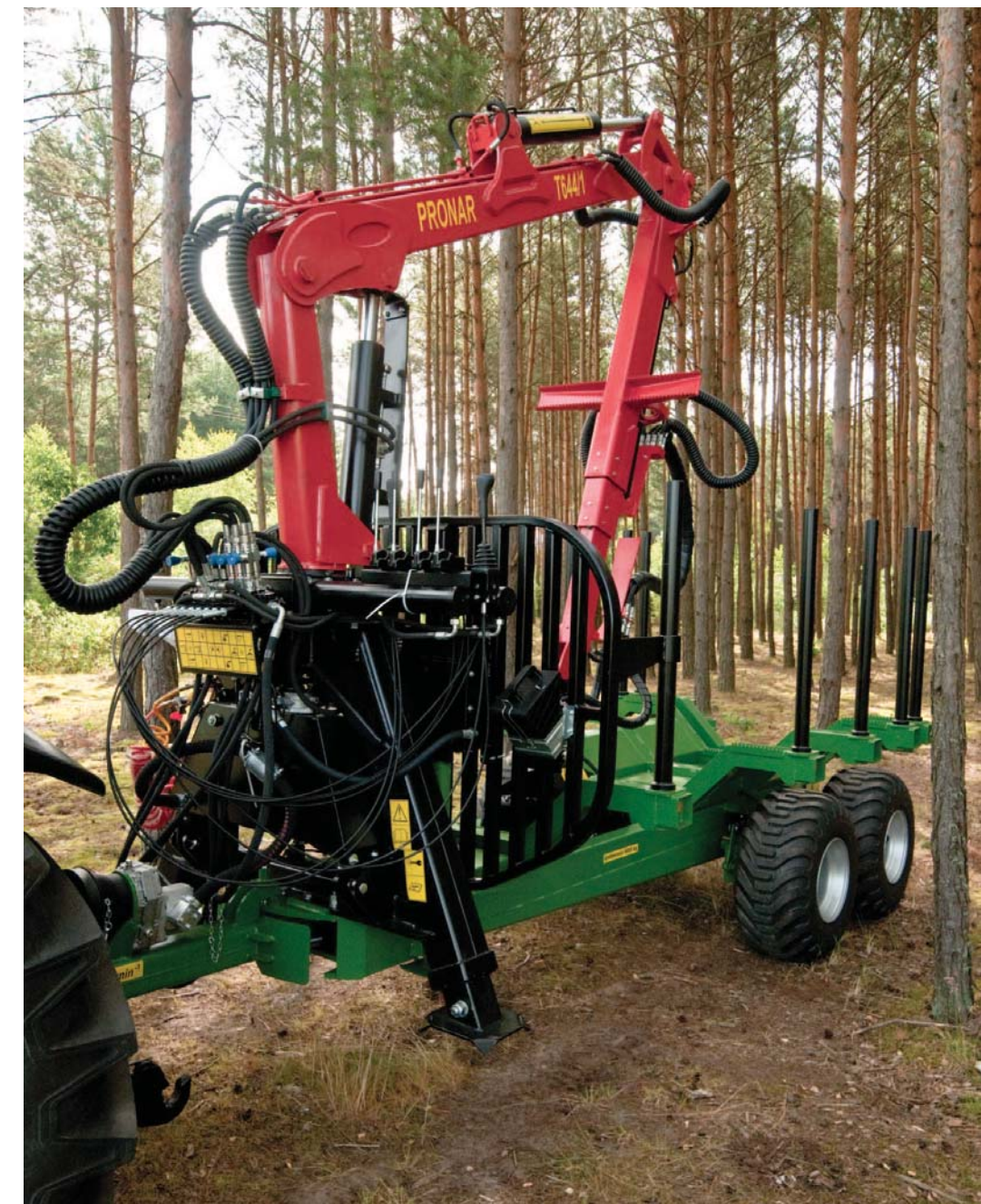
Atutem przyczepy jest zastosowanie hydraulicznie łamanego dyszla, który znacznie zmniejsza promień skrętu całego zestawu
