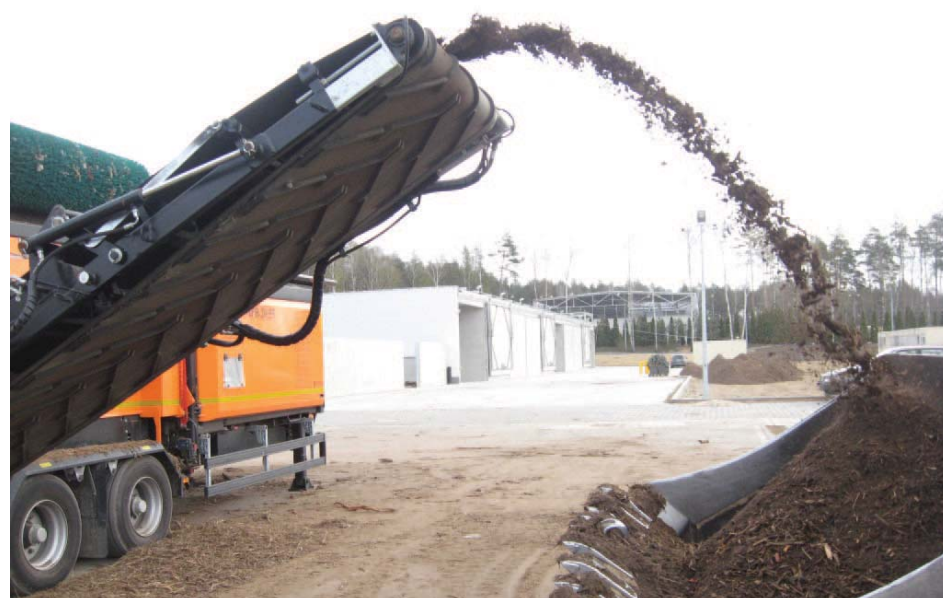
Odseparowaną frakcję można wykorzystać jako warstwę filtrującą zanieczyszczone powietrze z bioreaktora
