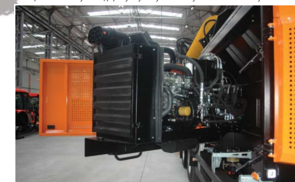
Silnik i układ hydrauliczny umieszczone są na obrotowej ramie, co zapewnia łatwy dostęp przy wykonywaniu czynności serwisowych
