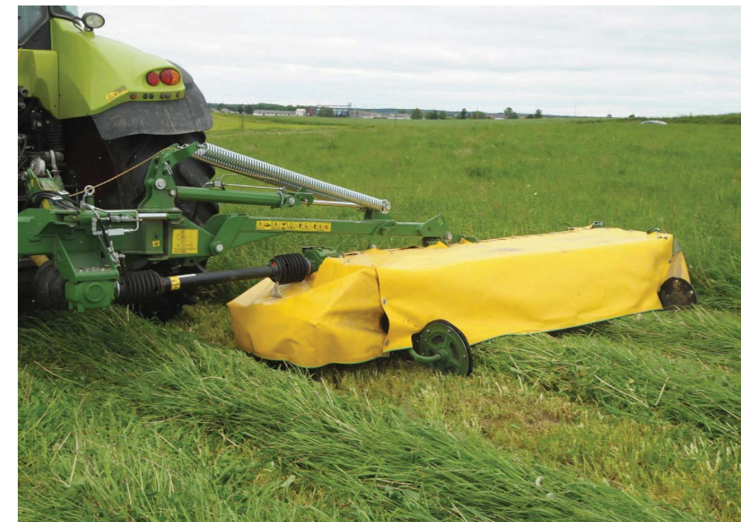
Mechanizm centralnego zawieszenia kosiarki PDT300 sprawdza się doskonale na nierównych łąkach
