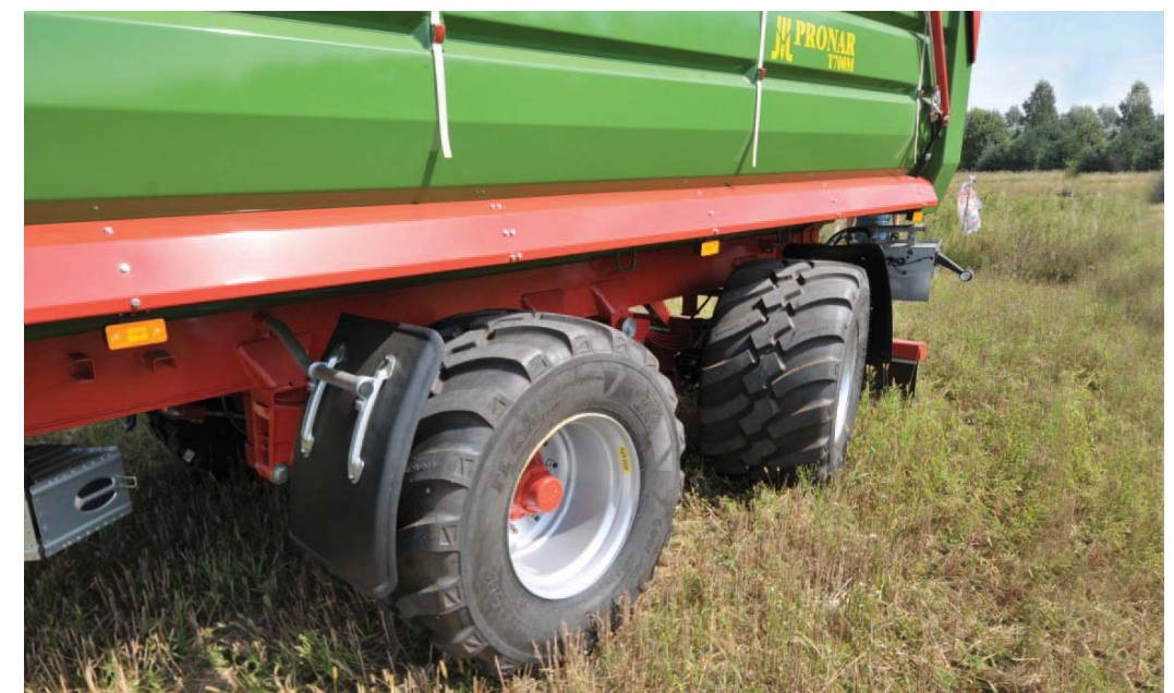
W przyczepie PRONAR T700M zastosowano bardzo mocne 24-tonowe zawieszenie tandem z resorami parabolicznymi, osiami o przekroju 150 mm i hamulcami bębnowymi przystosowanymi do prędkości 60 km/h
