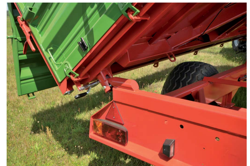
Dzięki zamontowanemu mechanizmowi trójsłonnego wywrotu przyczepa PRONAR T671 charakteryzuje się wysokim poziomem funkcjonalności
