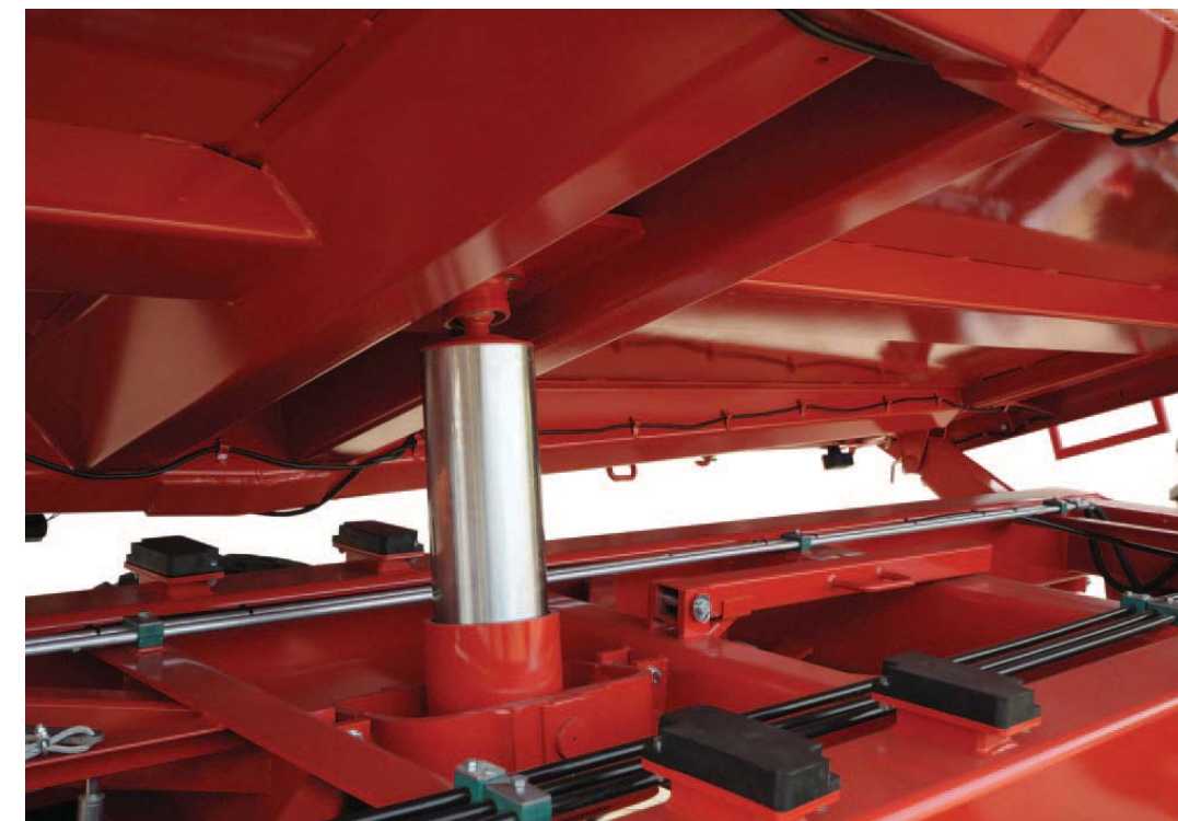
Jednym z istotnych elementów mechanizmu wywrotu trójsłupowego w przyczepie PRONAR T683 jest cylinder teleskopowy o ciśnieniu 200 barów
