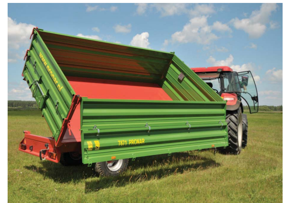
Dzięki zamontowanemu mechanizmowi trójsłonnego wywrotu przyczepa PRONAR T671 charakteryzuje się wysokim poziomem funkcjonalności
