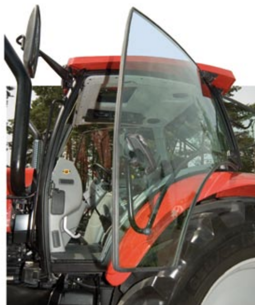
Wygodne, szerokie wejście – to kolejna zaleta kabiny czterostupkowej
