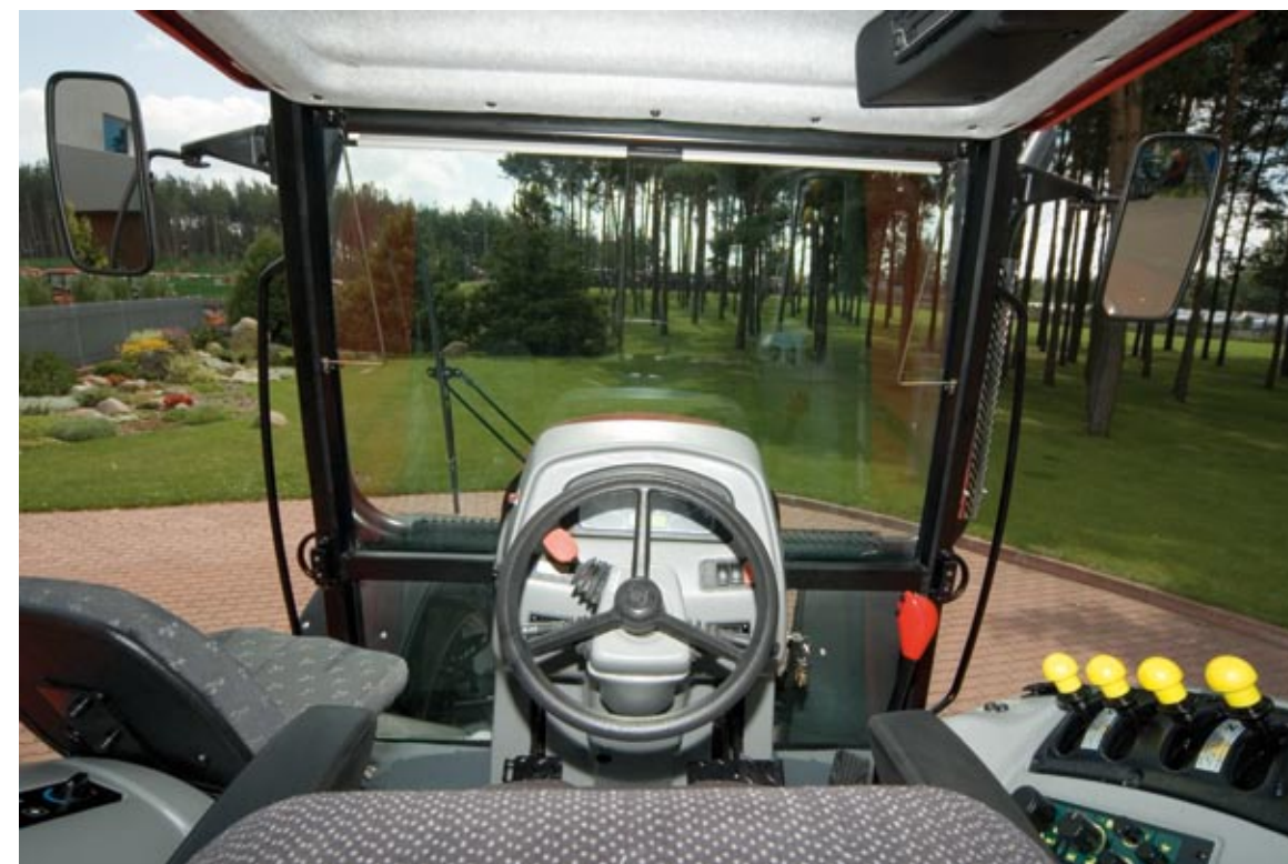
Brak słupków bocznych środkowych zapewnia doskonałą widoczność
