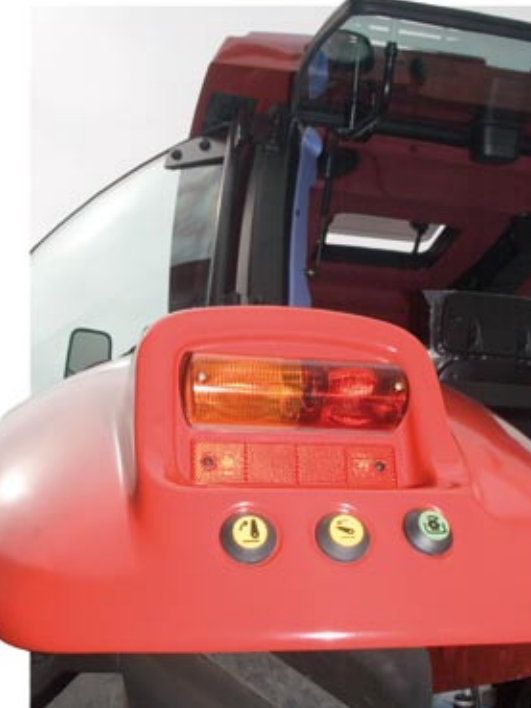
Umieszczone na zewnątrz przyciski ułatwiają podłączenie maszyny bez konieczności wsiadania i wysiadania z ciągnika
