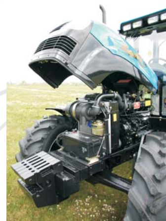
Szeroko otwierana maska ciągnika ułatwia dostęp do suchego filtra powietrza
