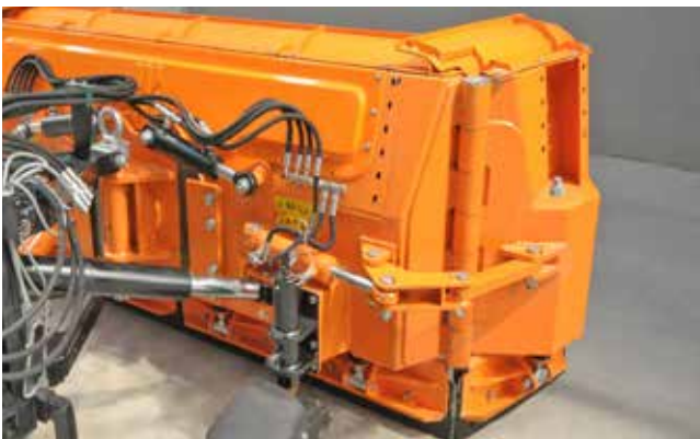
"Гідравлічне регулювання положення крила в діапазоні -60° до +90 градусів."
