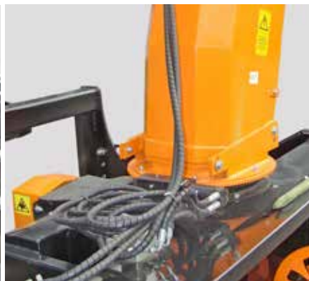
Гідравлічний поворот димаря і регулювання відстаней викиду
