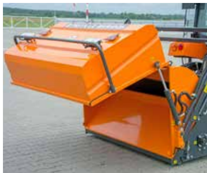
Можливість низького вивантаження
