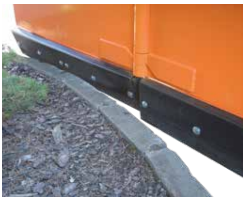
Пружинний захист (відхильні лемеші)
