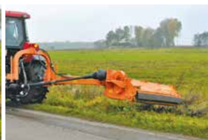
Гідравлічний підйом косарки 1820 мм дозволяє всією шириною працювати поза обрисом трактора
