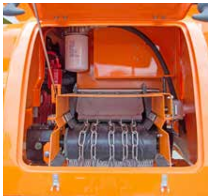
Матеріал транспортується стрічковим конвеєром до засипної системи
