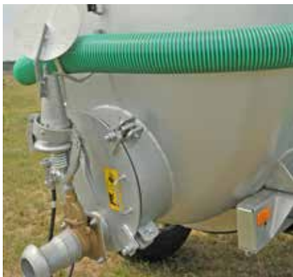
Спускний патрубок у найнижчій точці резервуара.
