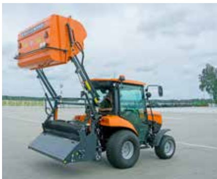
Високе вивантаження 2000 мм
