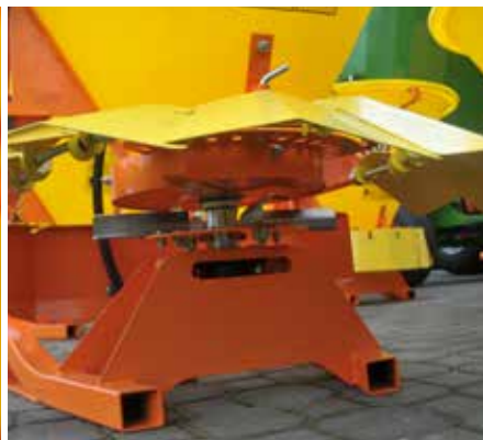
Диск для посипання з нержавіючої сталі
