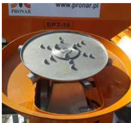
Диск для розсіювання з нержавіючої сталі
