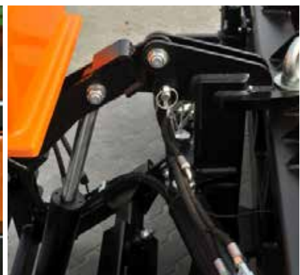
Гідравлічний привід для підйому / опускання
