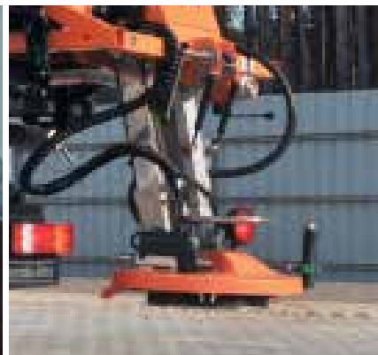
Регульована висота адаптера для розсіювання
