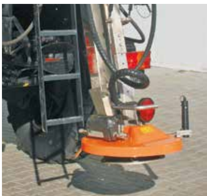
Регульована висота адаптера для розсіювання
