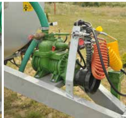
Лопаткова ротаційна вакуумна помпа.
