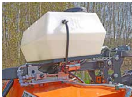
Резервуар для води об'ємом 200 літрів
