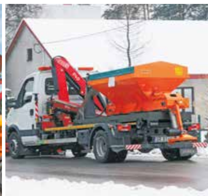
Можливість агрегації з крюковим навантажувачем
