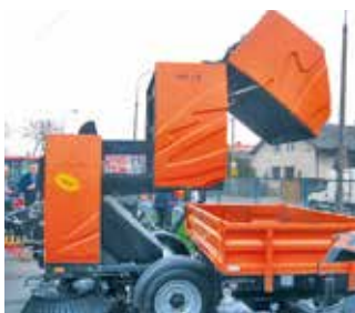
Гідравлічна система випорожнення кошика
