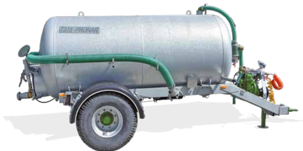
Спускний патрубок у найнижчій точці резервуара.
