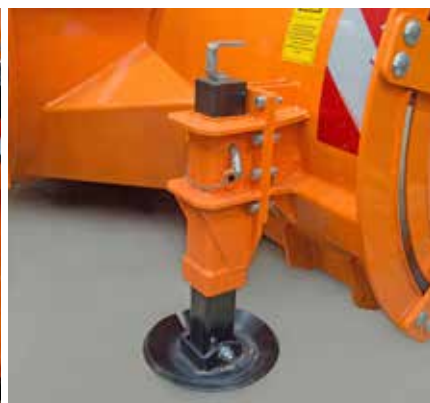
Ковзаючі елементи зі зносостійкої сталі, або опорні колеса
