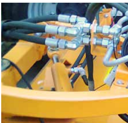
Гідравлічний поворот щітки \pm 30^\circ
