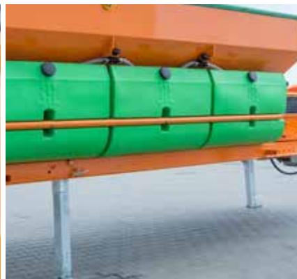
Опорні ніжки регульованої висоти для завантаження машини на самоскид без використання додаткових пристроїв (система RORO)
