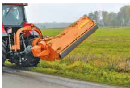
Можливість регулювання кута роботи в діапазоні +94 градусів - 65 градусів
