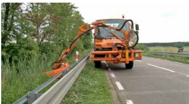
Косіння важкодоступного узбіччя за допомогою стріли WWP500U та головки GK 110
