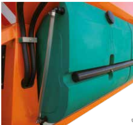
Резервуар для соляного розчину
