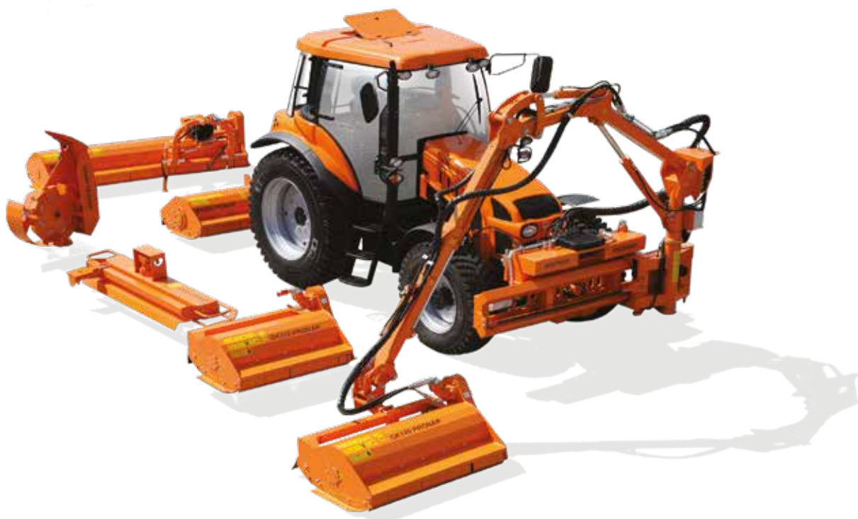
Гідравлічний рух стріли по напрямній, що дозволяє вибрати відповідне робоче положення
