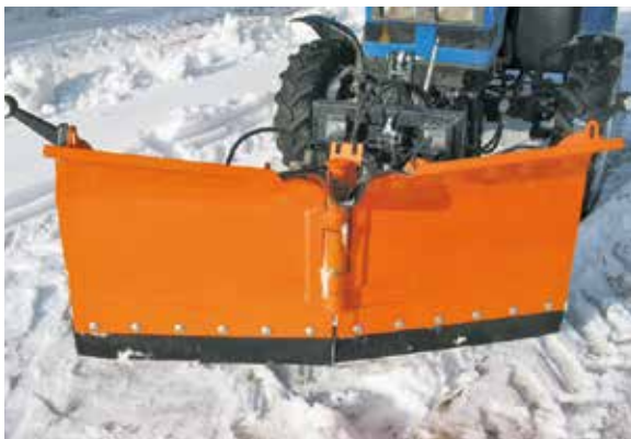
Можливість налаштування 4 робочих позиції
