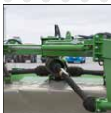
● центральний дишель дозволяє косити праворуч або ліворуч від трактора
