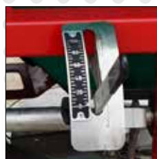
● важіль регулювання дози та напрямку посіву
