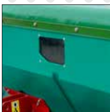
● ревізійні отвори в двокамерному резервуарі
