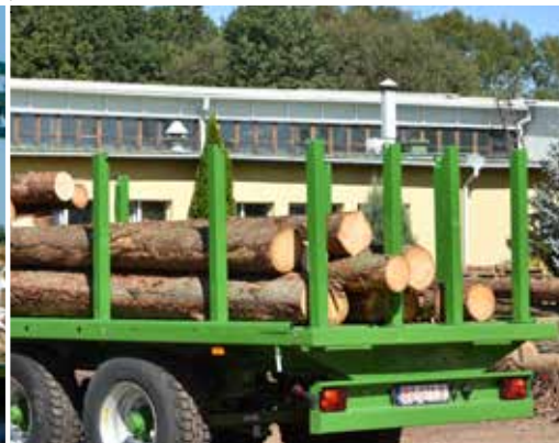
Стойки для транспортування деревини з гачками для кріплення натяжних ременів
