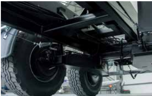
Підвіска танDEM жорсткого типу «boogie»
