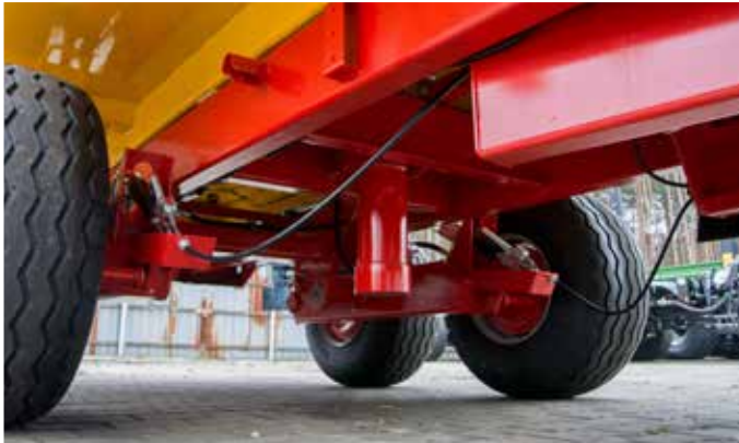
ТанDEMна підвіска з поздовжніми важелями; з напівосями, оснащеними барабаними гальмами
