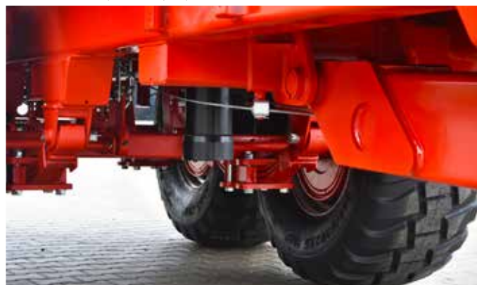
Підвіска танDEM на параболічних ресорах
