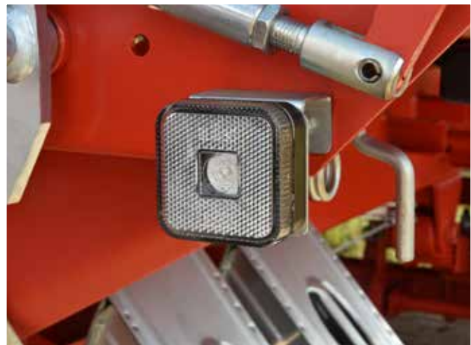
Установка освітлення зі світлодіодними лампами
