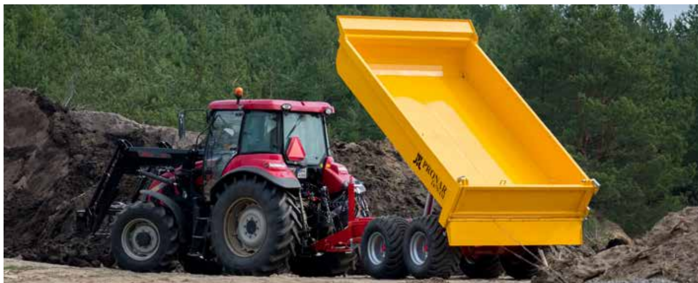
Т679/4М - Вантажний кузов з міцною обудовою (будівельна версія); бічна стіна і половина підлоги, виготовлені з одного листа листового металу
