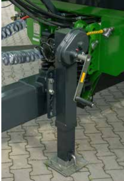
Телескопічна опора дишла з одноступінчастою трансмісією
