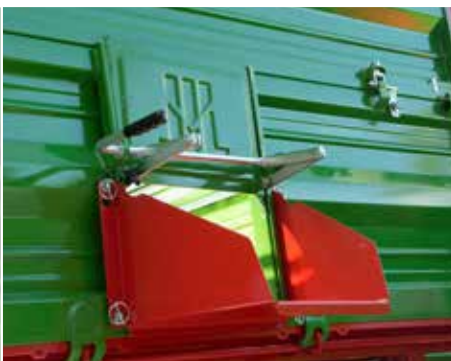
Висипний люк з блокуванням і жолобом для точного розвантаження
