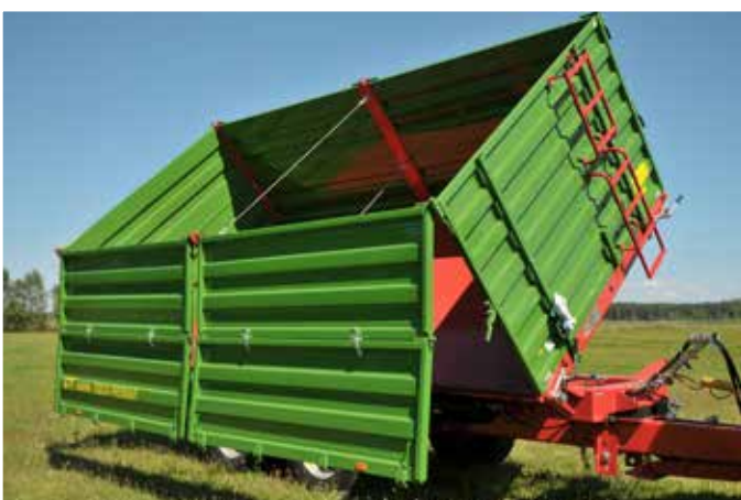
Вантажний кузов з універсальною, важельною, системою відкриття стін зі стабільними задніми і середніми стовпами (Т683)
