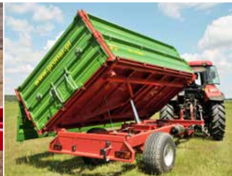
Система тристороннього вивороту кузова з задніми кульовими шарнірами з оптимальною відстанню
