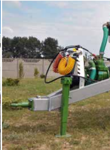
Опора дишла: проста механічна телескопічна
