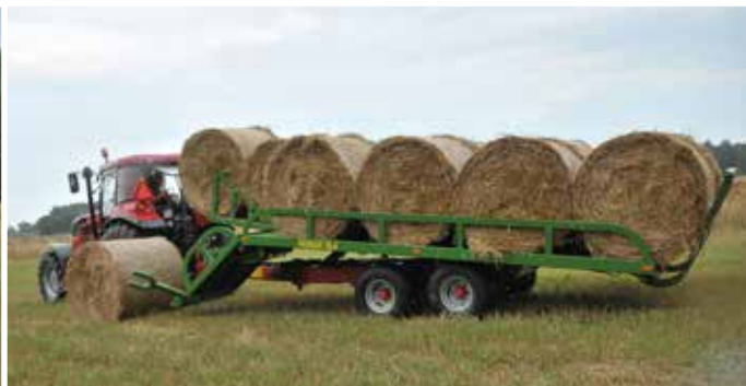
Широка вантажна платформа (2550 мм) дозволяє завантажити тюки в два ряди
