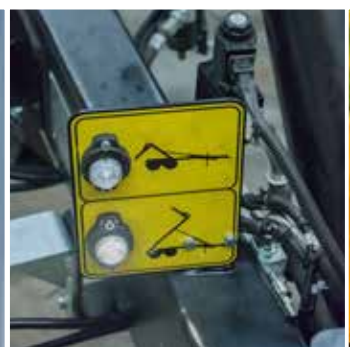
Автоматичне перемикання функції гаківик-самоскид
