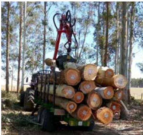
Кран на телескопічних опорах з поворотним захоплювачем.
