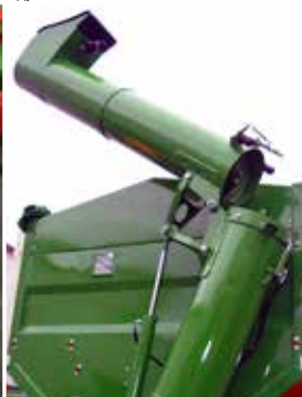
Двосегментний конвеєр шнековий передній, що розкладається гідравлічно
