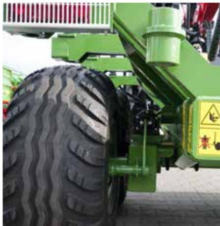
Підвіска тандем з 2 поздовжніми важелями
