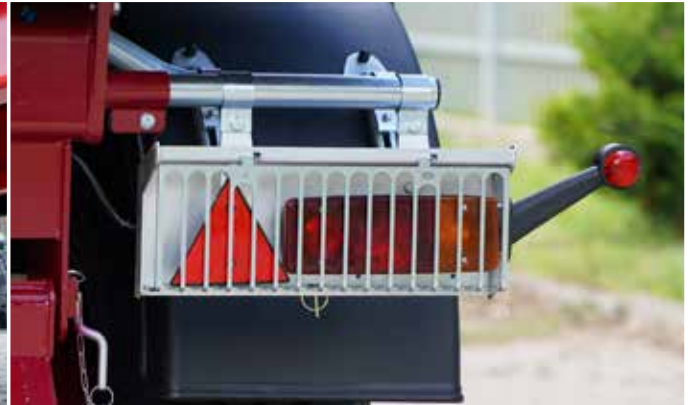
Задні фари освітлення з решітками для захисту від пошкоджень
