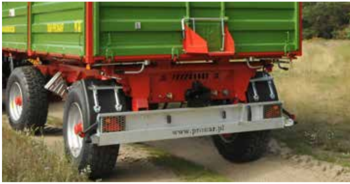
Сильна задня траверса і освітлення з світлодіодними лампами, з решітками захисту від пошкоджень
