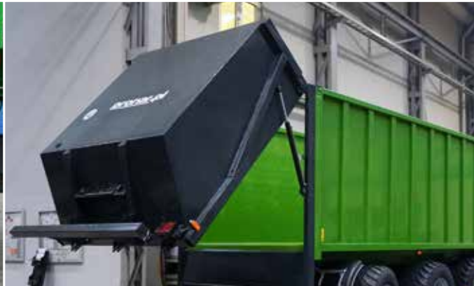
Гідравлічно піднімаєма задня кришка з автоматичним притисканням і фіксуванням
