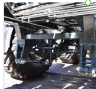
Підвіска тандем на параболічних ресорах
