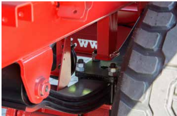
Підвіска на параболічних ресорах зі сталевим відвіником
