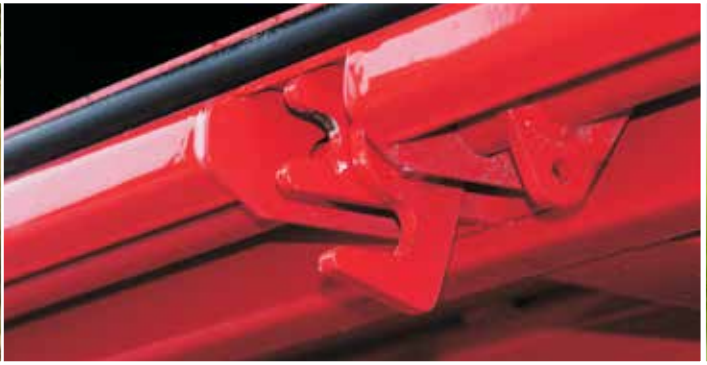
Надійна система блокування стін біля підлоги
