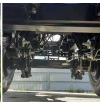
Підвіска типу тандем на 4 параболічних ресорах
