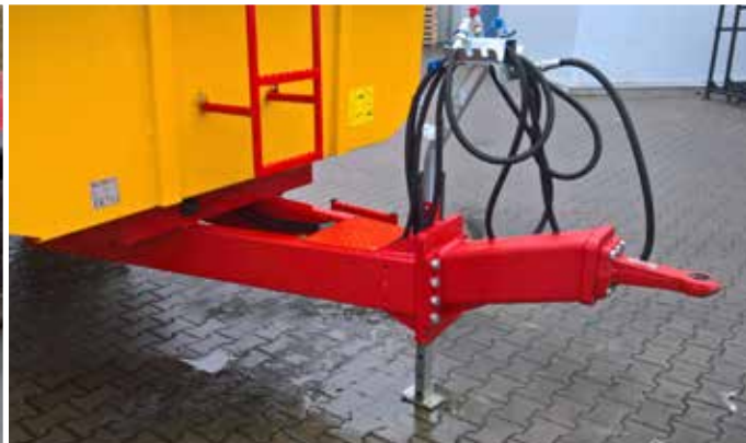
Універсальне жорстке дішло для з'єднання з нижнім або верхнім зчіпним пристроєм трактора
