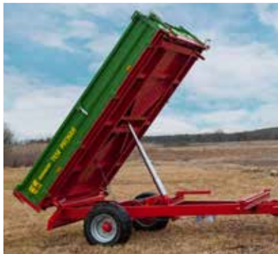
Система тристороннього вивороту з телескопічним циліндром і шарнірним кріпленням.
