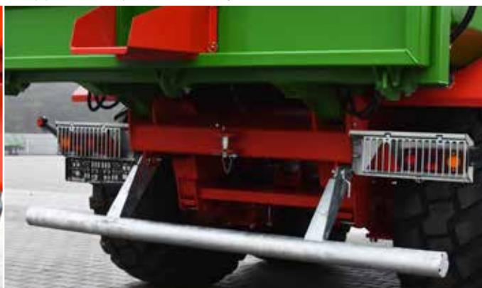
Задні фари освітлення з решітками для захисту від пошкоджень
