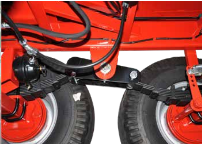
Підвіска танDEM на 4 пр'яних ресорах
