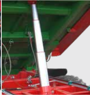
Телескопічний тристоронній вивірт вантажного кузова з шарнірною підвіскою
