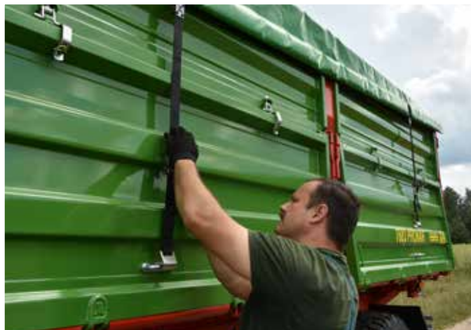
Рулонний брезент з сильними натяжними пристроями ремнів
