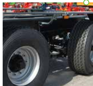
Підвіска з задньою поворотною віссю, керованою пасивно
