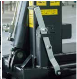
Мануальне перемикання функції гаковик-підйомник
