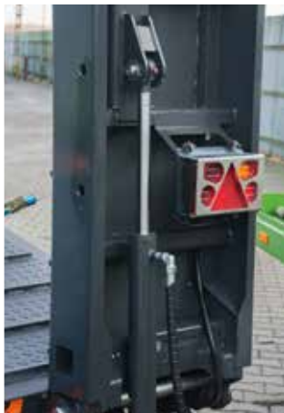
Механічна система опускання/піднесення заїзних трапів
