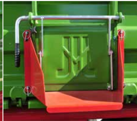
Висипний люк з блокуванням і жолобом для точного розвантаження
