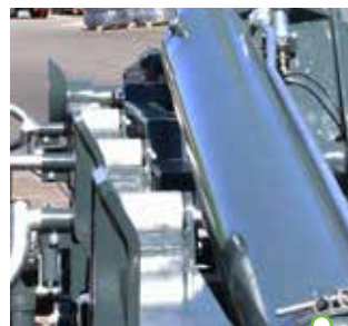
Рама шасі високої міцності з роликами, що підтримують контейнер.
