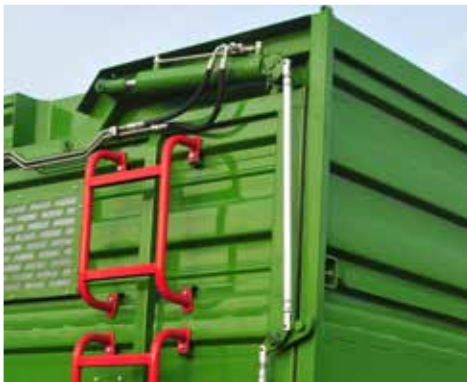
Гідравлічна система фіксування та підйому бічної стіни (Т683Н)
