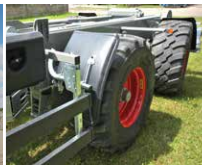
Задня вісь пасивно керована в T285/1
