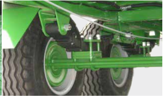
Підвіска тандем на пір'яних ресорах в T046/1
