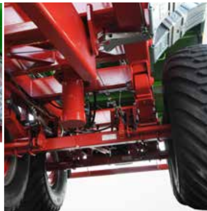
Міцне і тверде шасі на параболічних ресорах полегшує транспортування в складній місцевості
