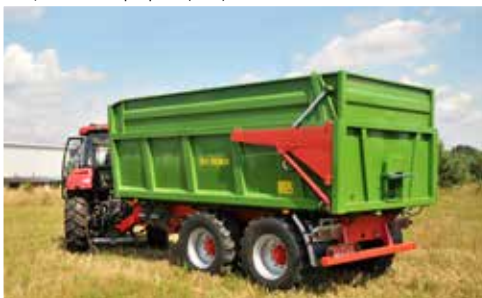
Вантажний кузов з міцною обшивкою з вертикальними зміцнювальними ребрами (Т679)
