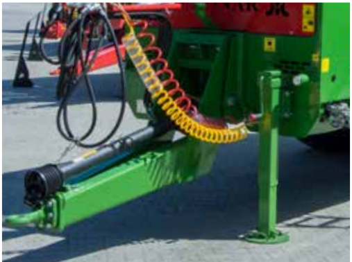
Телескопічна опора дишла з одноступінчастою трансмісією Гальмівна установка
