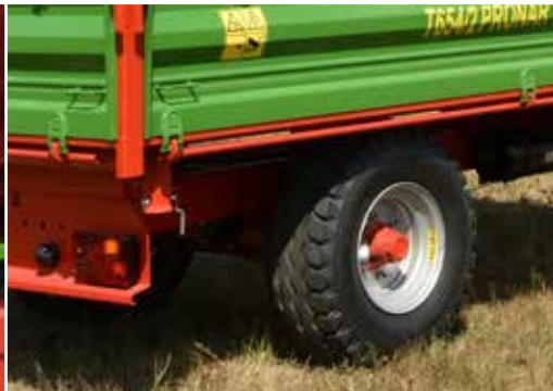
Полегшене завантаження завдяки низько розташованому вантажному кузову.
