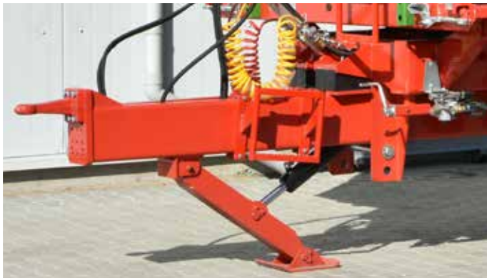
Універсальне жорстке дишло для з'єднання з нижнім або верхнім зчіпним пристроєм трактора, амортизовані гумовими ресорами
