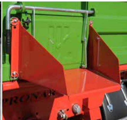
Висипний люк для зерна, з блокуванням, в задній стіні
