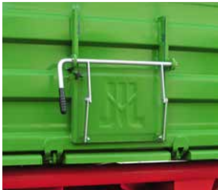
Висипний люк для зерна, з блокуванням, в задній стінці
