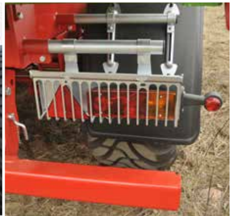
Заднє освітлення причепа захищено від пошкоджень спеціальними решітками
