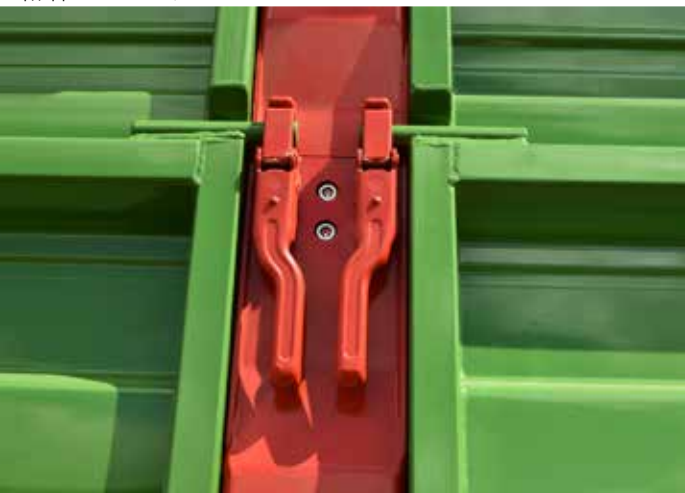
Тверді фірмові замки стін, засновані на кованих частинах
