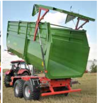
T700 - Гідравлічно піднімаєма задня стіна з автоматичним фіксуванням
