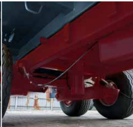
Підвіска тандем з параболічними ресорами в Т679/2 і Т701
