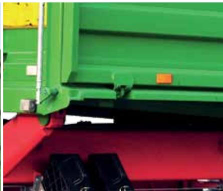
Гідравлічна система фіксування та підйому бічної стіни (Т683Н)
