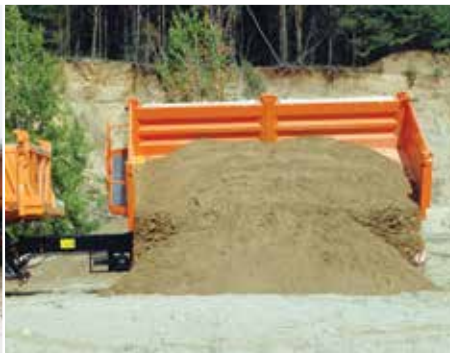
PC2100/1- розвантаження причепа. Лівий боковий борт відкривається і закривається за допомогою гідравлічних циліндрів
