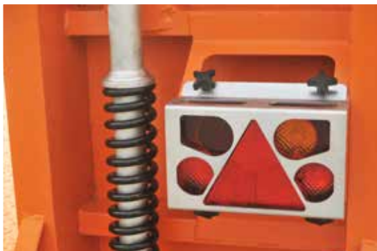
Механічна або (опціонально) гідравлічна система опускання заїзних трапів
