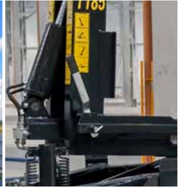
Мануальне перемикання функції гаківик-підйомник
