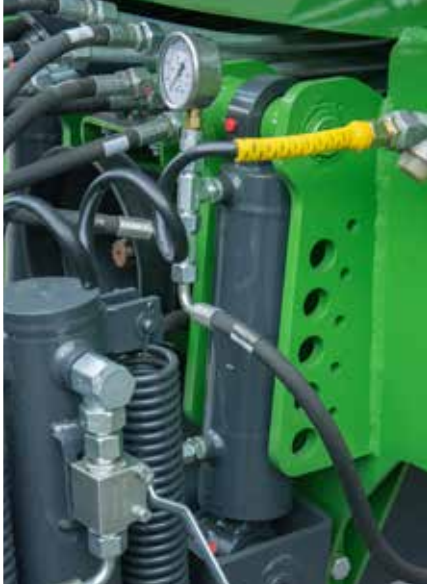
Регульоване гідравлічно дишло вдосконалено амортизує машину
