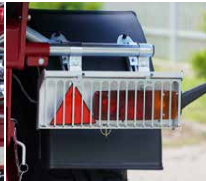
Задні фари освітлення з решітками для захисту від пошкоджень
