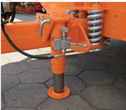
Амортизоване механічно дишло і гідравлічна опорна нога
