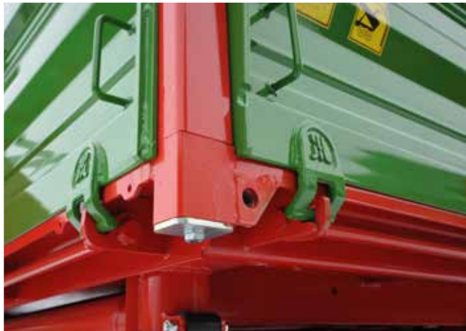
Центральне блокування біля підлоги бічних стін і задньої стіни
