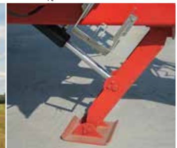
Гідравлічна ножицна опора дишла з рухомою стопою та гідравлічним замком
