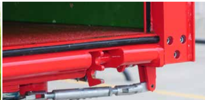
Змінні гумові ущільнення, розміщені на краю підлоги, що забезпечують абсолютну герметичність кузова (T680U)
