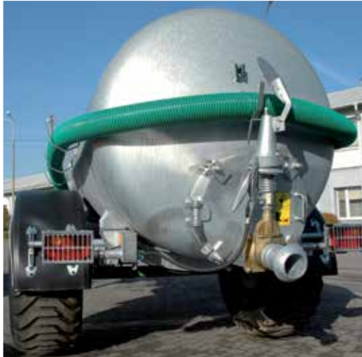
Спускний патрубок у найнижчій точці резервуара.
