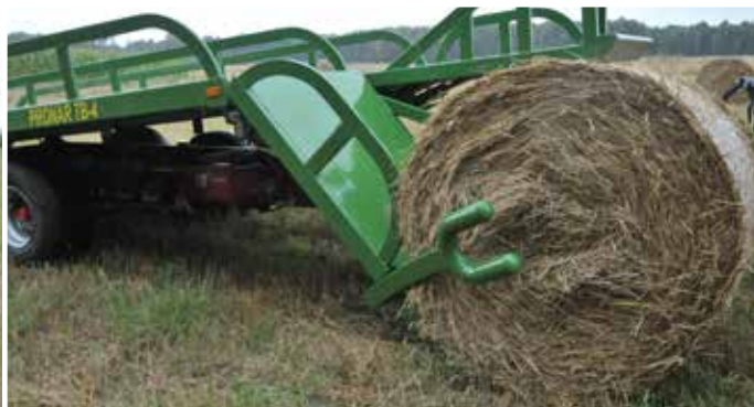
Широка вантажна платформа (2550 мм) дозволяє завантажити тюки в два ряди
