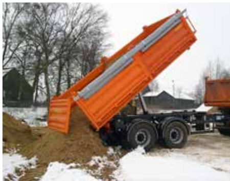
PC2100- розвантаження причепа. Задній відхильний борт відкривається автоматично в момент вивороту.
