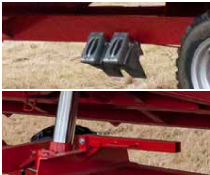
Клини під колеса з кишенями в стандартному обладнанні та сервісна опора вантажного кузова
