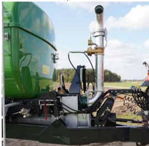
Система наповнення живиться ефективним насосом
