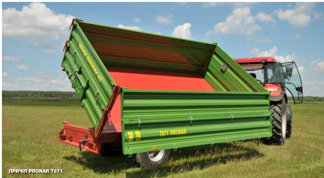
Система тристороннього вивороту з телескопічним циліндром і шарнірним кріпленням.
