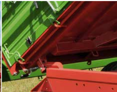
Система вивороту з кульовими шарнірами ззаду.
