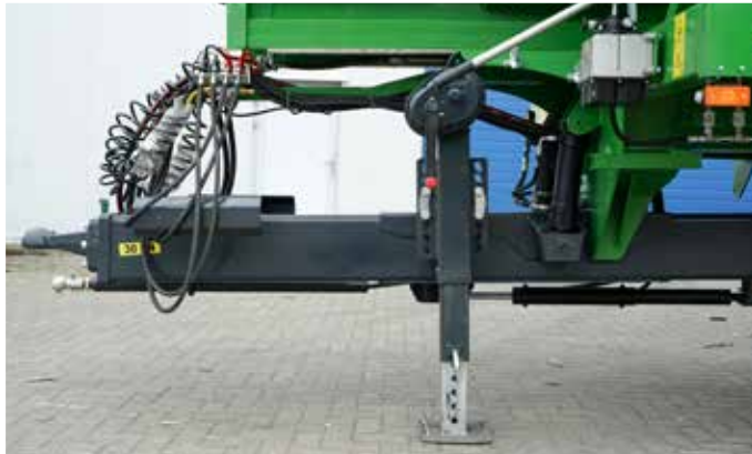
Універсальне тверде амортизоване гідравлічно дишло
