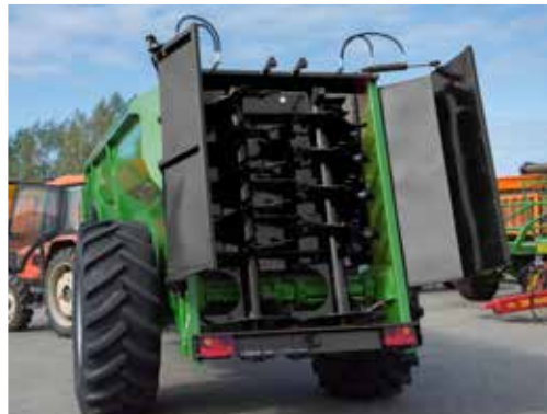
Розкидуючий 2-вальцевий вертикальний адаптер
