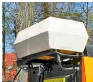
Додатковий резервуар для води (200 дм)
