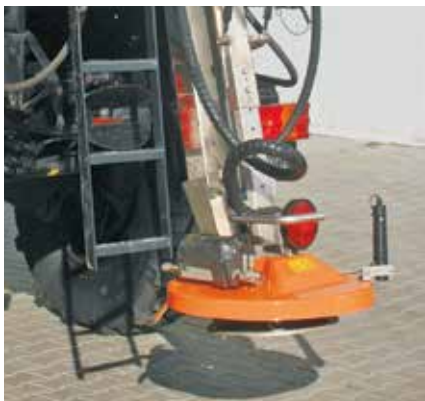
Регульована висота адаптера для розсіювання
