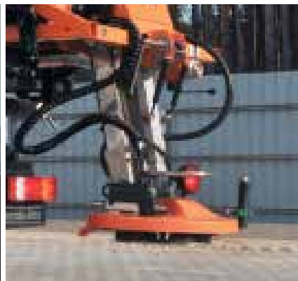
Регульована висота адаптера для розсіювання
