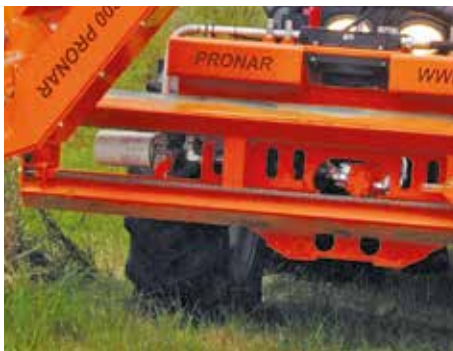
Гідравлічний рух стріли по напрямній, що дозволяє вибрати відповідне робоче положення
