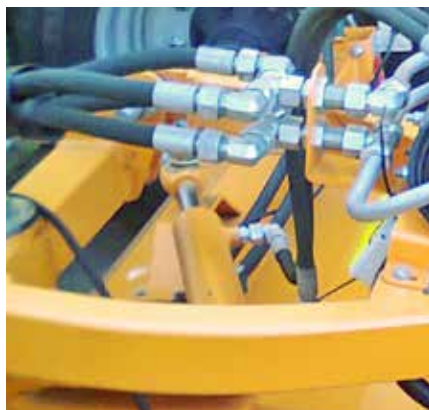
Гідравлічний поворот щітки \pm 30^\circ
