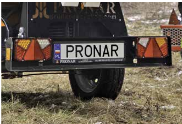
Дорожні ліхтарі є обов'язковими для того, щоб транспортний засіб рухався по дорогах громадського транспорту
