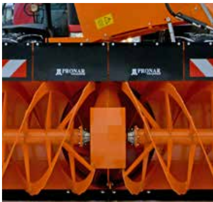
Фрезерний шнек для різання замерзлого снігу і льоду. Робоча висота 1,2м
