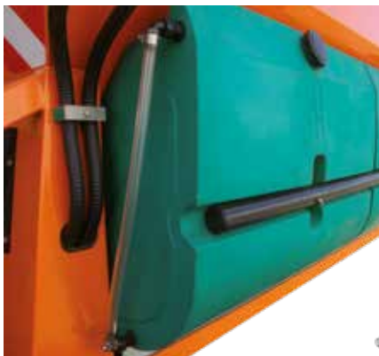
Резервуар для соляного розчину
