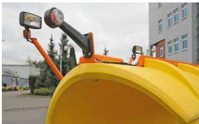
Дорожнє та контурне освітлення
