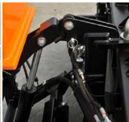
Гідравлічний привід для підйому / опускання
