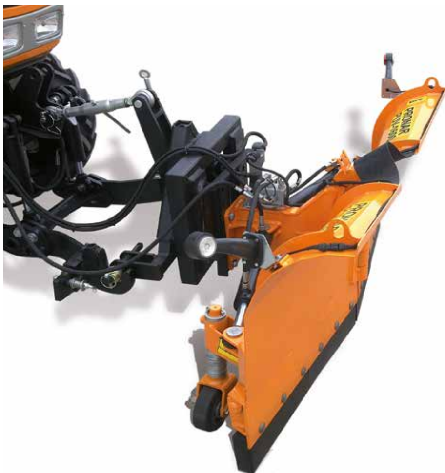
Можливість налаштування 4 робочих позиції
