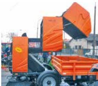
Гідравлічна система випорожнення кошика
