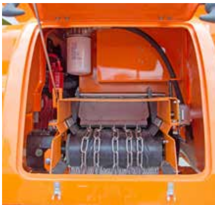
Матеріал транспортується стрічковим конвеєром до засипної системи
