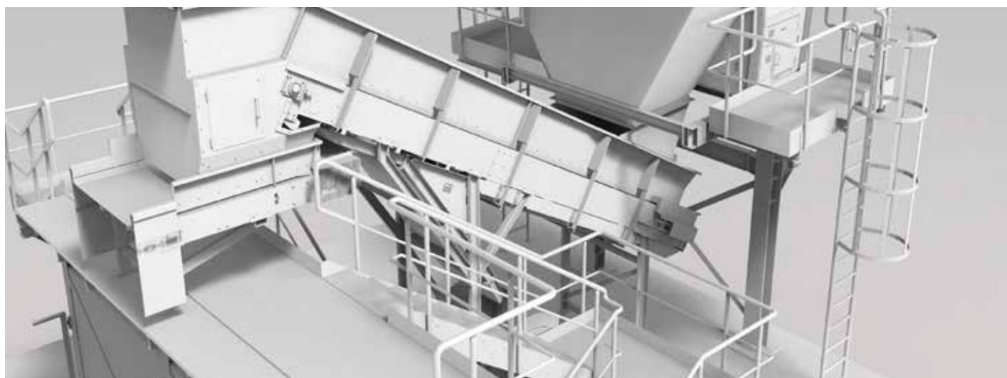
↑ Фрагмент проекта линии, предназначенной для сортировки смешанных отходов, представляющий разгрузку барабанного сита на наклонный ленточный конвейер, транспортирующий отходы на сортировочную конвейерную ленту
