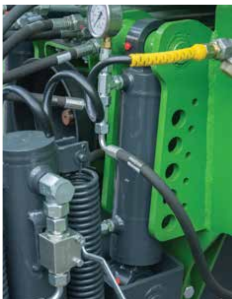
↑ Дышло с гидравлической регулировкой отлично амортизирует машину
