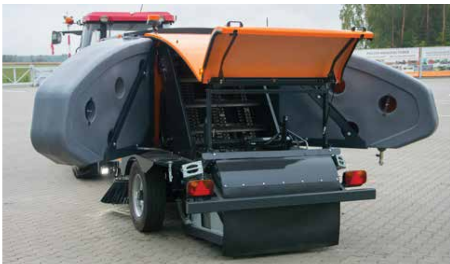
↑ Наклонные резервуары облегчают доступ при обслуживании конвейера и цилиндрической щетки
