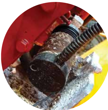
↑ Поврежденная ржавчиной катушка регулировки оборотов
