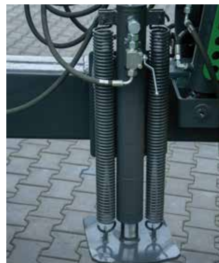
↑ Гидравлическая опора дышла
