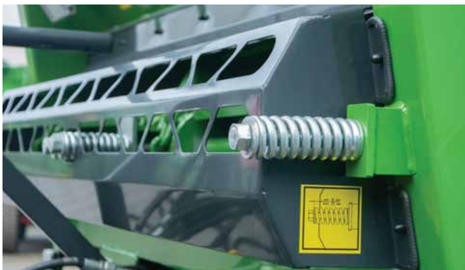
↑ Перфорированная защита обеспечивает хорошую видимость конвейерного механизма
