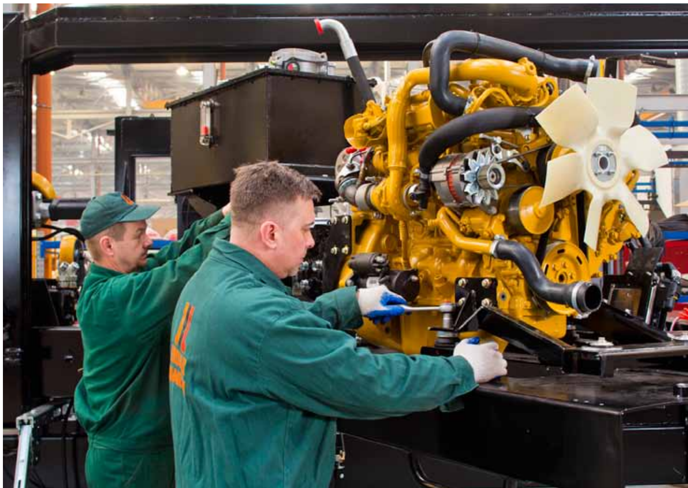
↑ Установка двигателя просеивателя
