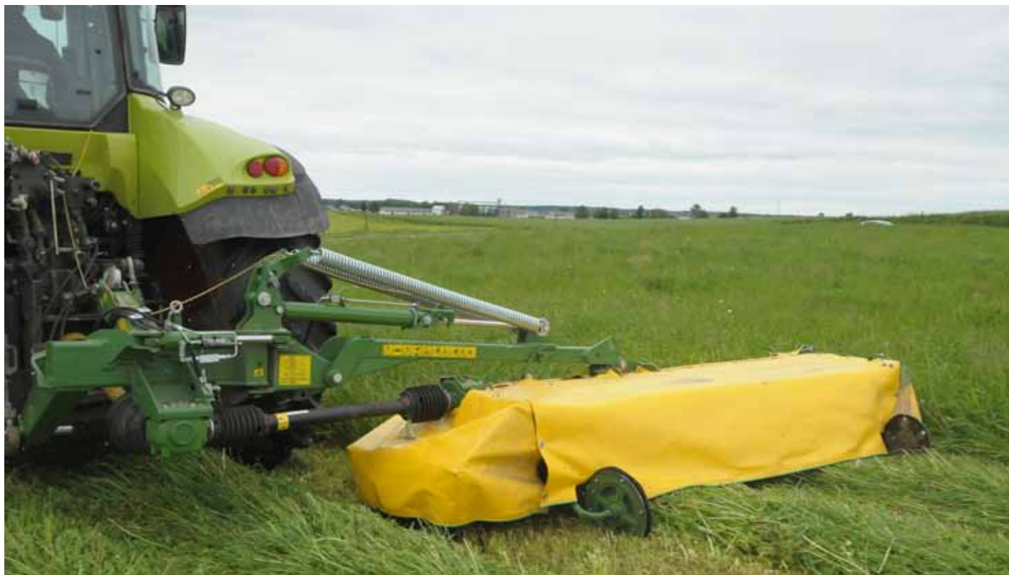
↑ Луг дисковой косилки широкой и тонкий, поэтому высыхает равномерно и легко ворошится
