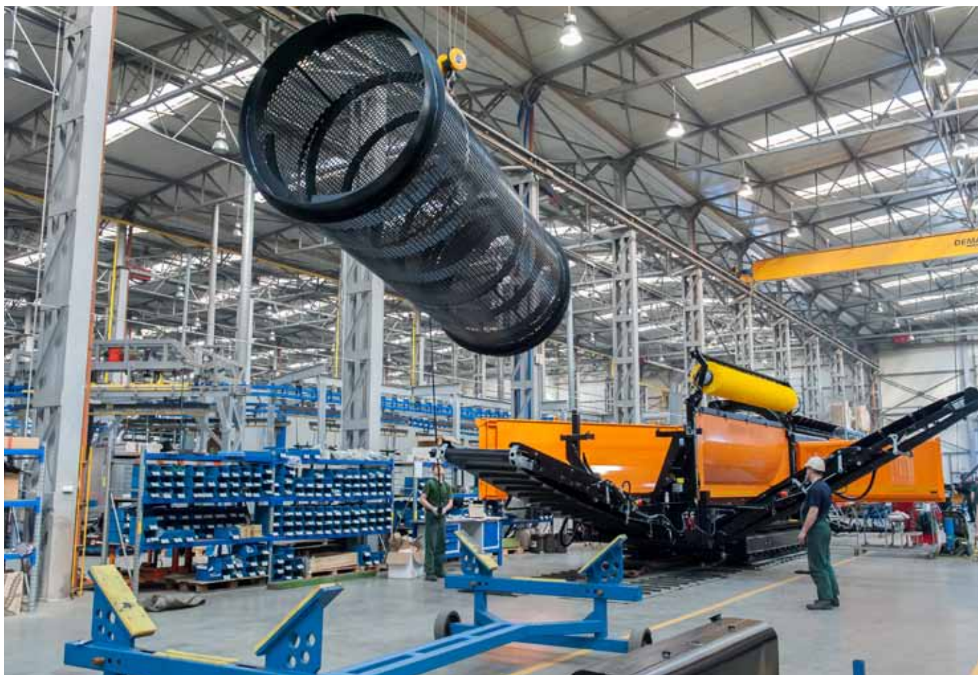
↑ Одним из самых важных элементов просеивателя является стальное барабанное сито
