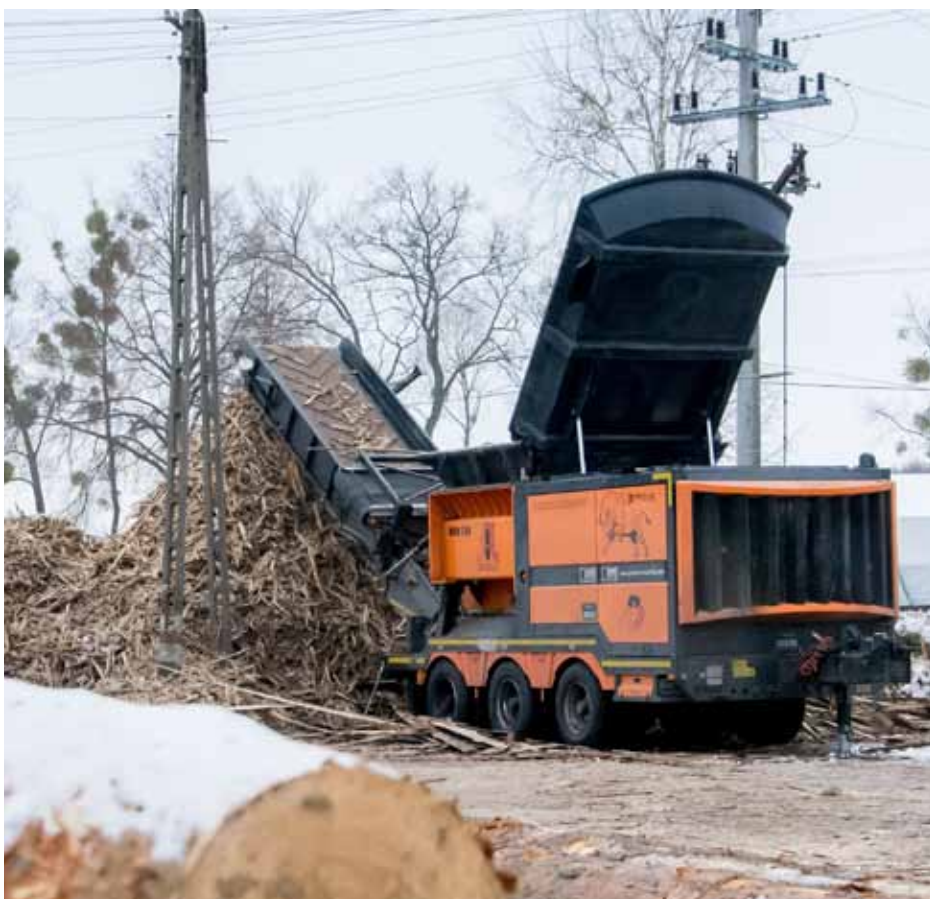
↑ Низкоскоростной измельчитель PRONAR MRW 2.85
