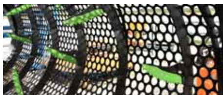
Разрывающие ножи могут быть установлены во всех барабанах просеивателей
