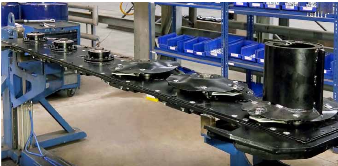
↑ Режущие брусы в дисковых косилках это проект инженеров Пронара
