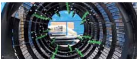
Разрывающие ножи могут быть установлены во всех барабанах просеивателей
