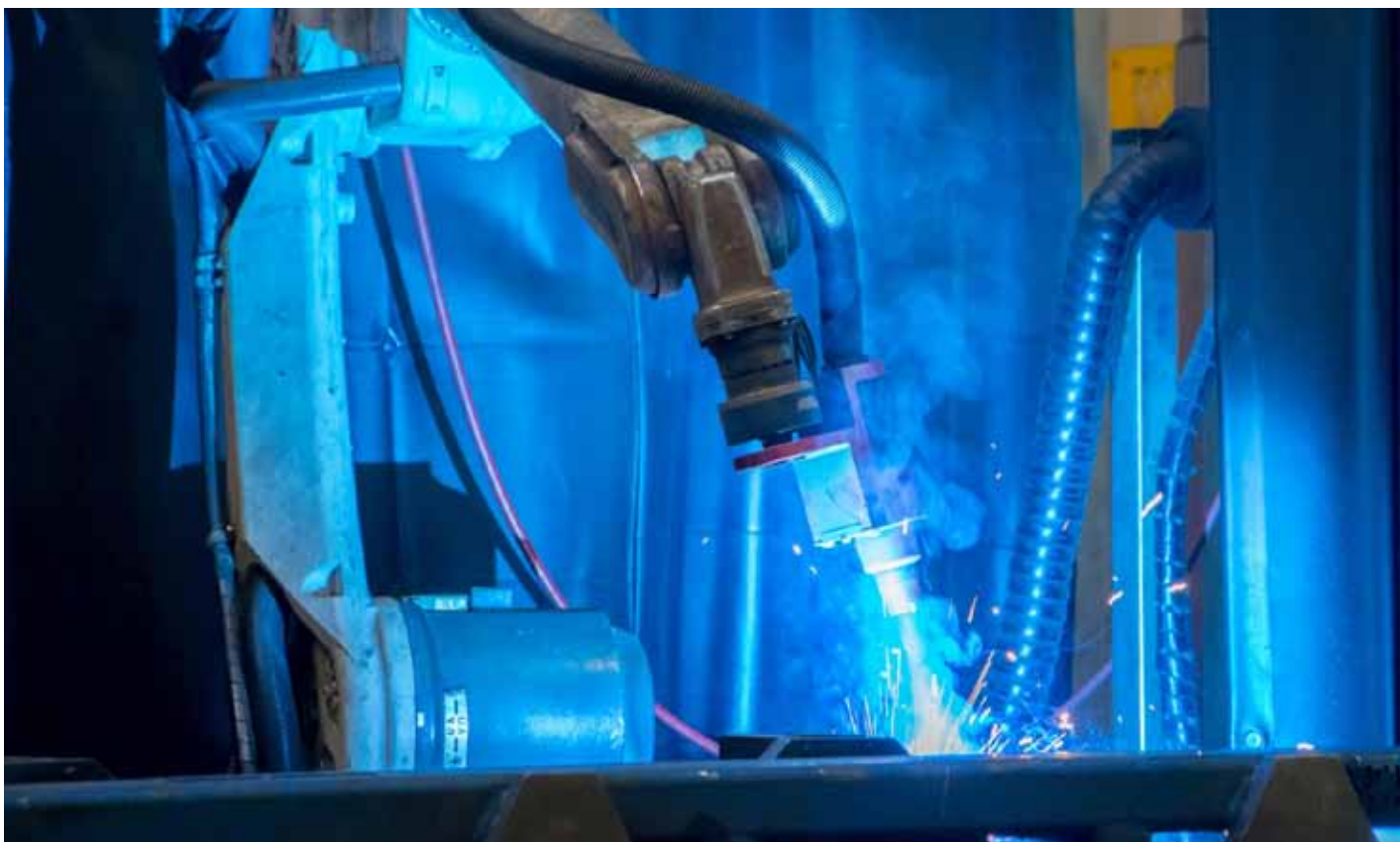
↑ Основные компоненты дисковой косилки свариваются с помощью сварочных роботов.
