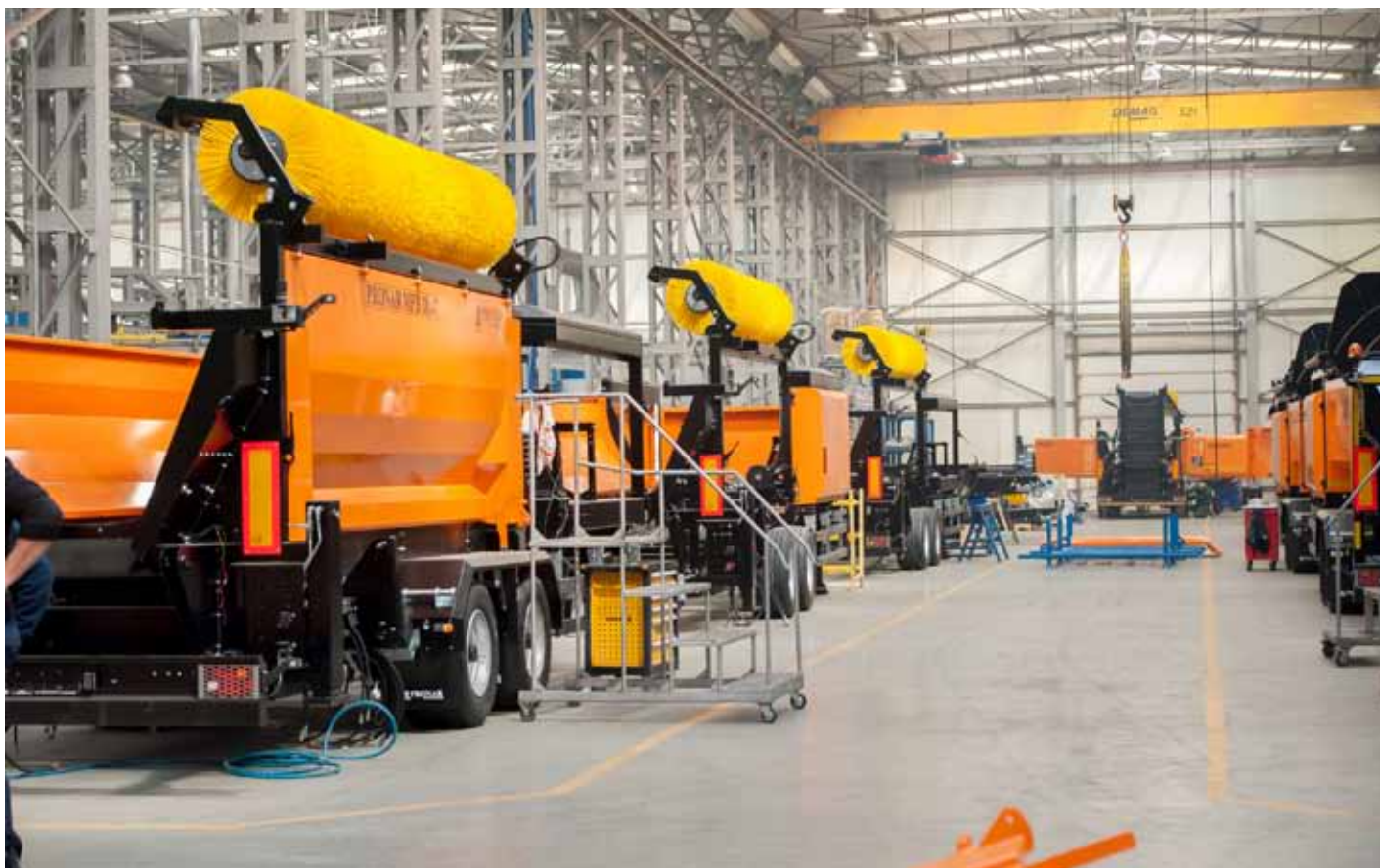
↑ Сборочная линия мобильных барабанных просеивателей PRONAR MPB 18.47
