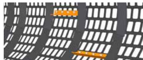
Пороги в барабанах просеивателей помогают в тщательной очистке материала
