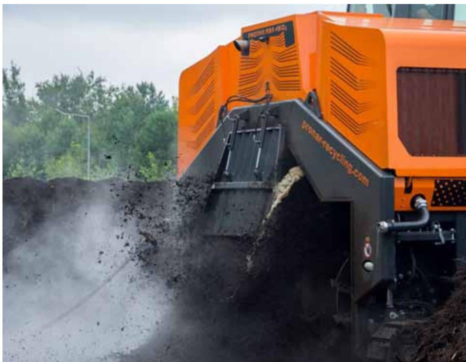
↑ Оросительная система ворошительного материала помогает ускорить созревание
