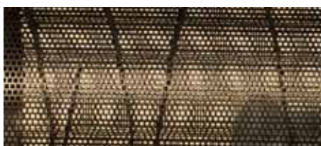
Благодаря сетке, опоясывающей барабан, имеется возможность изготовления сита с перфорацией менее 10 мм
