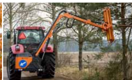
WWT700T, WWT800T - большой диапазон работы благодаря раздвигающемуся с помощью телескопического цилиндра плечей
