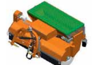
Гидравлический привод щётки и посыпающего вала пескоразбрасывателя
