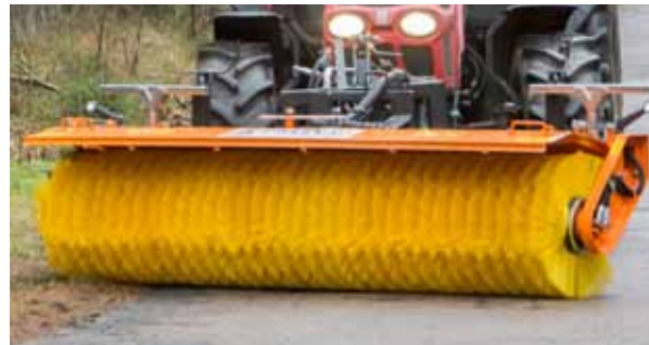
Доступные 8 типов вальцевой щетки (4 твердости щетки и 2 типа колец - плоские или "пластр" меда")
