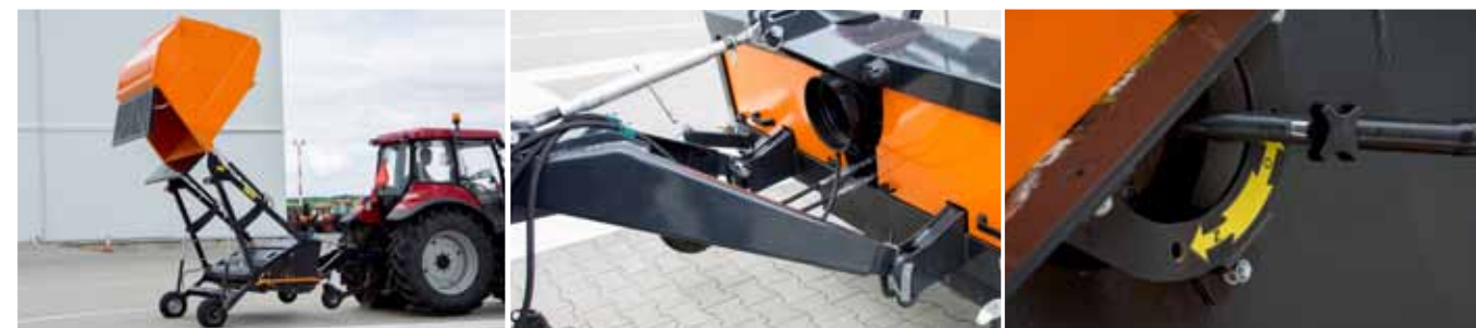
Гидравлическая разгрузка на прицеп высоты до 2,1 м
