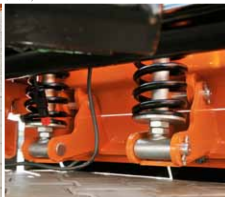
Защитный пружинный механизм (подвижные ножи отвала)
