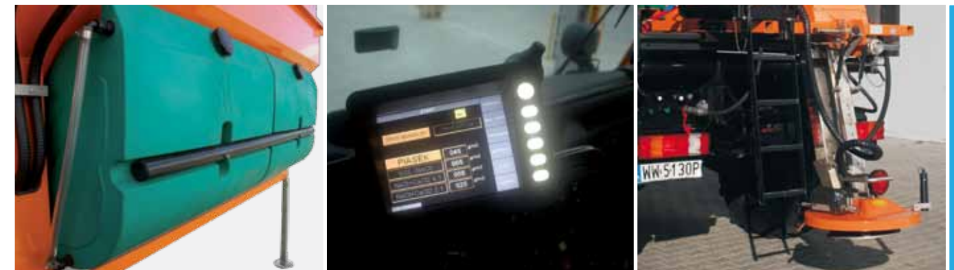
Регулируемая высота положения разбрасывающего адаптера
