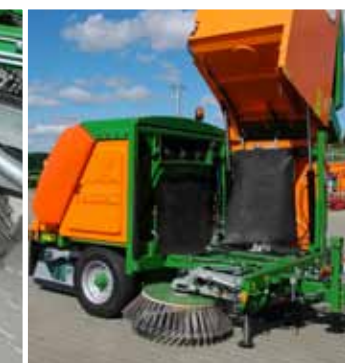
Опустошение бункера гидравлически.
