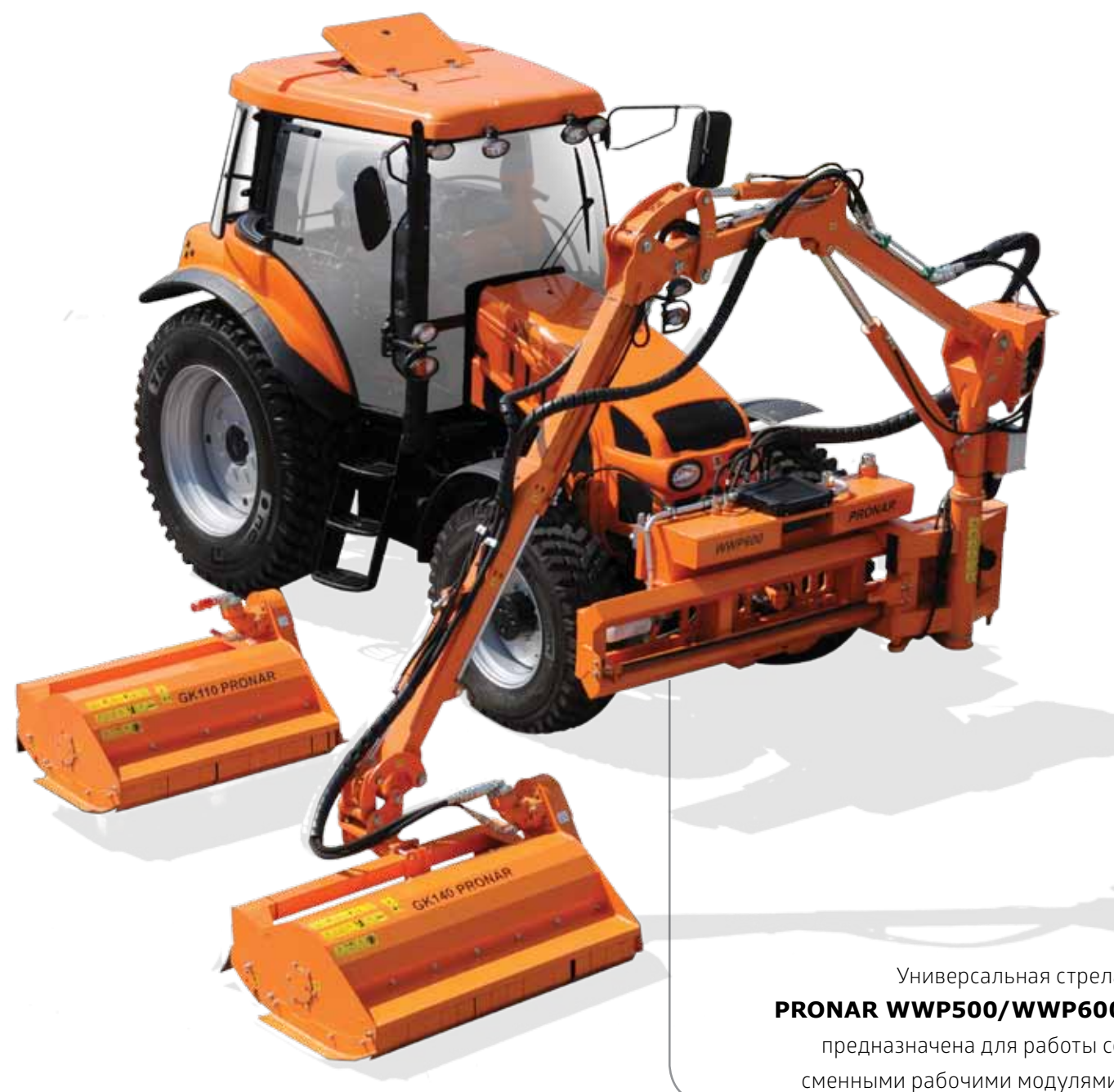
Стрела WWP600 – перемещение рабочего плеча по направляющей при помощи гидравлики.
