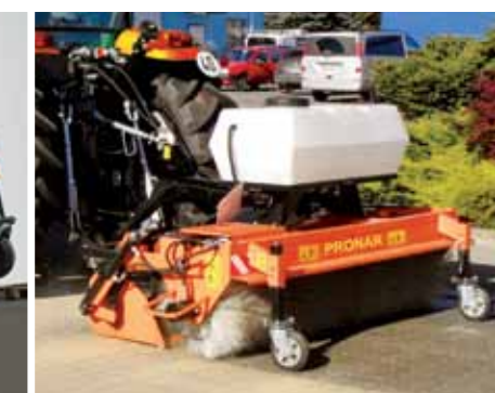
Система орошения для уменьшения пыле- и грязеобразования.
