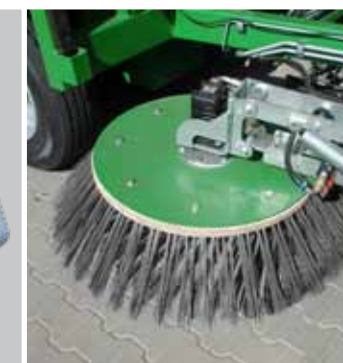
Регулирование положения дисковых щеток гидравлически.
