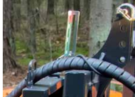
Указатель рабочей позиции облегчает подбор оптимальной высоты системы навески носителя
