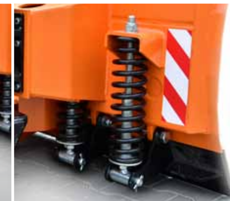
Пружинная защита ножей отвала.
