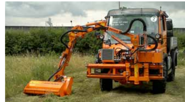
Стрела WWP500U с модулем для кошения GK110 на Unimog U500.
