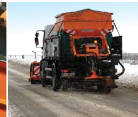
Автомобильный разбрасыватель песка из серии РТ имеет привод от пассивного колеса.
