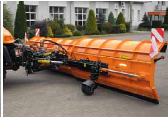
Способ крепления - коммунальная плита DIN 76060 тип А
