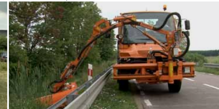
Обкашивание труднодоступных мест при помощи стрелы WWP500U и модуля для кошения GK110.
