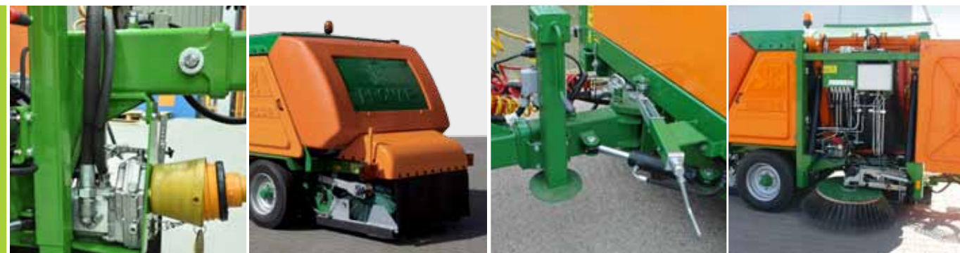
Откидные щитки для сервисного обслуживания.
