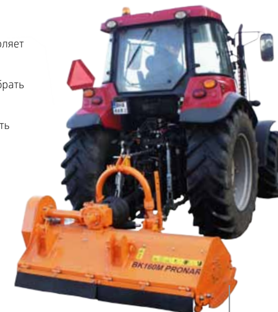
регулировка угла атаки скользящих полоз позволяет легче преодолевать препятствия
