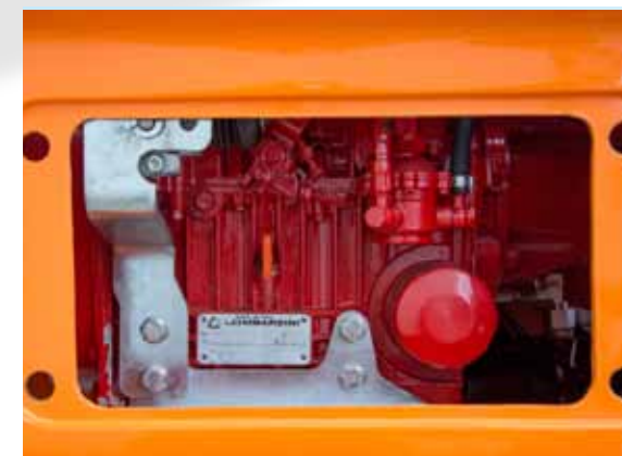
Двигатель внутреннего сгорания объемом 100 см 3 и мощности 16,2 кВт
