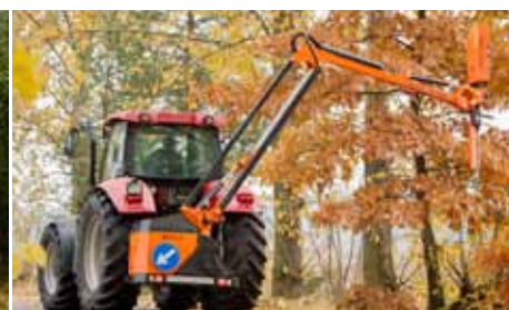
WWT600P - прямо позволяет удерживать угол наклона модуля по отношению к земле во время движения плечей
