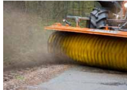
Резиновый фартук и регулируемая защита для направления отметаемого материала
