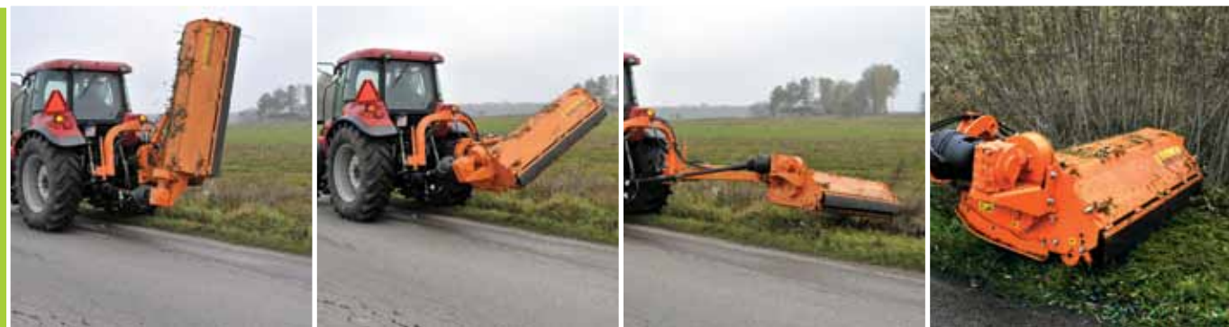
Мульчер работает с правой стороны трактора - вертикальная транспортировка
