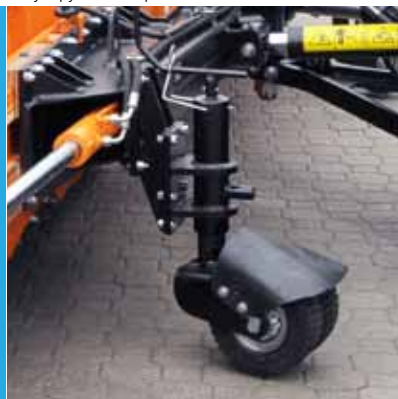
Регулируемые опорные колеса в опции
