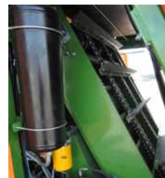
Скребок транспортер для подачи мусора в накопительный бункер
