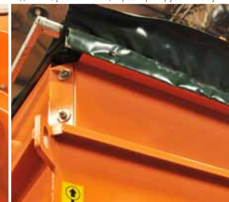
Надставки, увеличивающие размер загрузочного бункера
