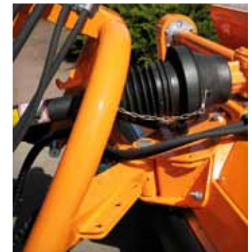
Гидравлический привод щётки и посыпающего вала пескоразбрасывателя
