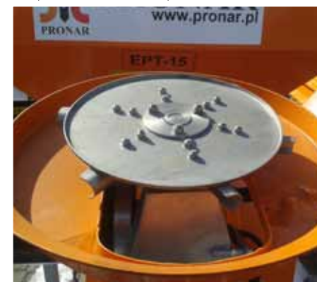
Разбрасывающий диск из нержавеющей стали
