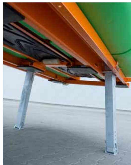
Система для облегчения загрузки пескоразбрасывателей РТ70 на платформу грузовика
