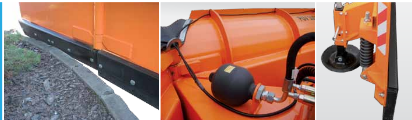
Защитный пружинный механизм (подвижные ножи отвала)
