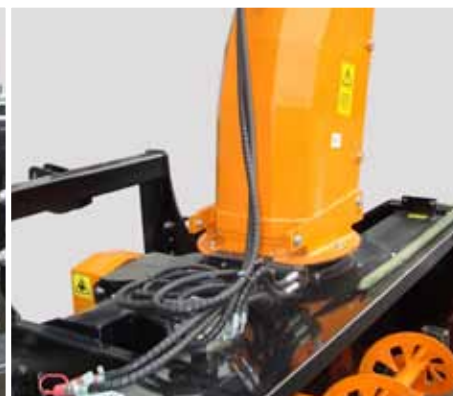
механическая передача с двумя окончаниями ВОМ (540/1000) управление метателем и регулирование дальности отброса снега при помощи гидравлики
