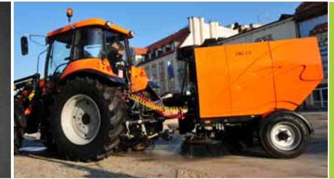
Гидравлически поворотное дышло.
