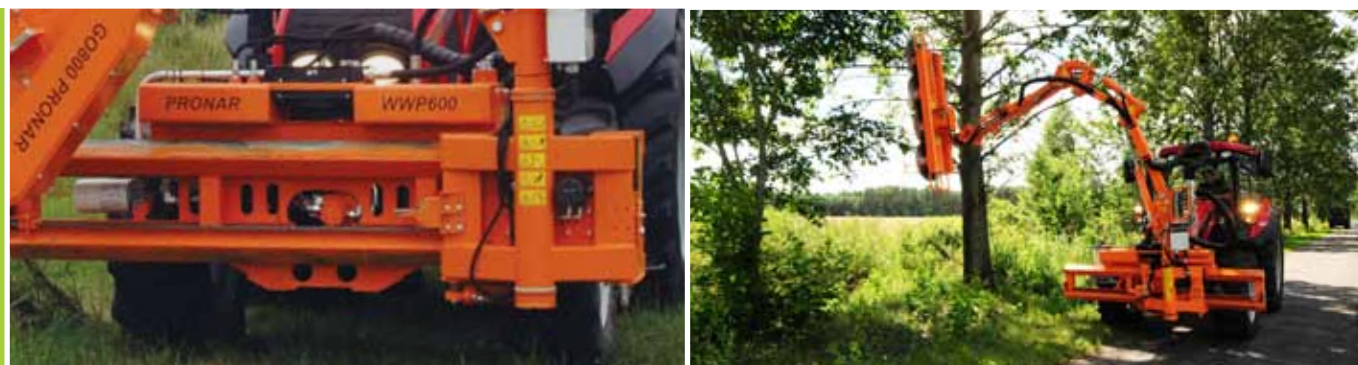
Стрела WWP600 – перемещение рабочего плеча по направляющей при помощи гидравлики.
