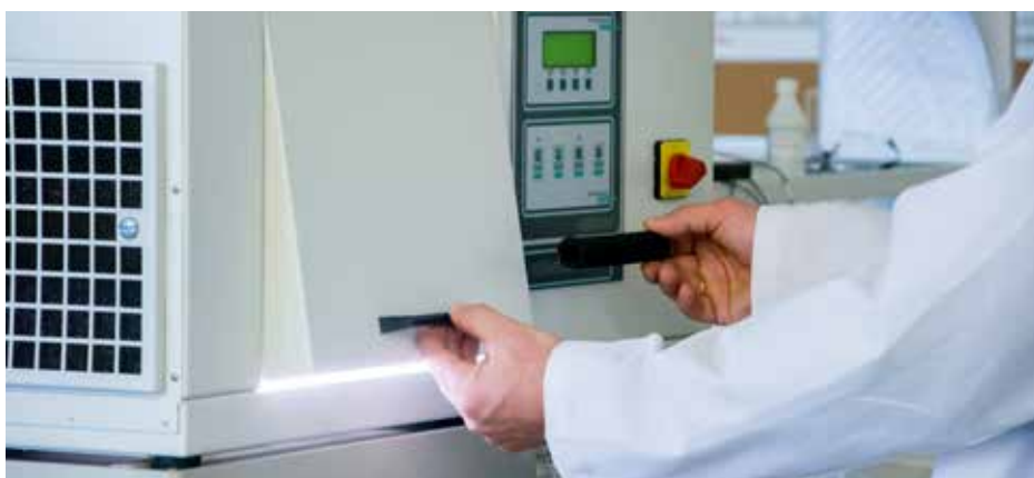
Камера УФ позволяет симулировать изменяющиеся погодные условия, в частности, температуру, УФ-излучения и влажности
