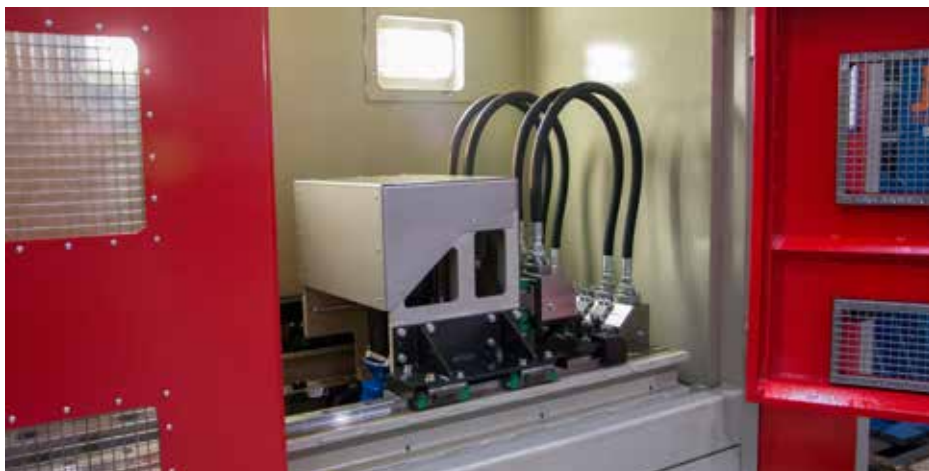
Стенд для испытаний позволяет проверить проводку и разъемы гидравлической системы в эксплуатационных условиях без необходимости установки их в конечном продукте.
