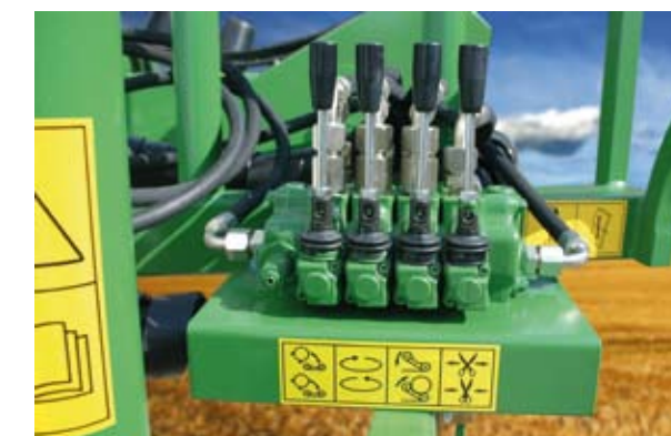
Sterowanie owijkarką odbywa się za pomocą przenośnego rozdzielacza hydraulicznego, który podczas pracy owijkarki można umieścić w kabinie ciągnika
