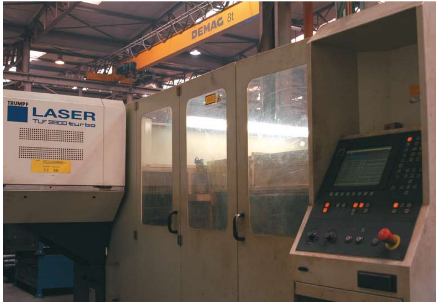
Laser TRUMPF TFL 3800 turbo, z prawej strony panel sterujący umożliwiający precyzyjne ustawienie parametrów wypalania. Obok drzwi do komory w której odbywa się proces palenia. Po lewej stronie pompa wirowa - najważniejsza część maszyny
