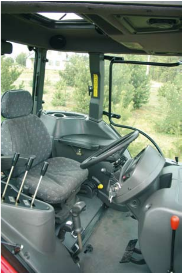
Regulacja siedziska z Pronaru (opcjonalnie - Grammer) oraz układ dźwigni sterujących ciągnika pozwalają na optymalne dopasowanie do każdego użytkownika oraz na wygodną pracę
