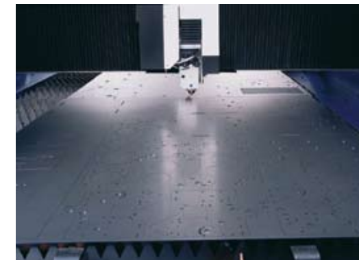
Laser TRUMPF TFL 3800 turbo - komora w której wypalane są detale wykorzystywane w produkcji kabin do ciągników PRONAR
