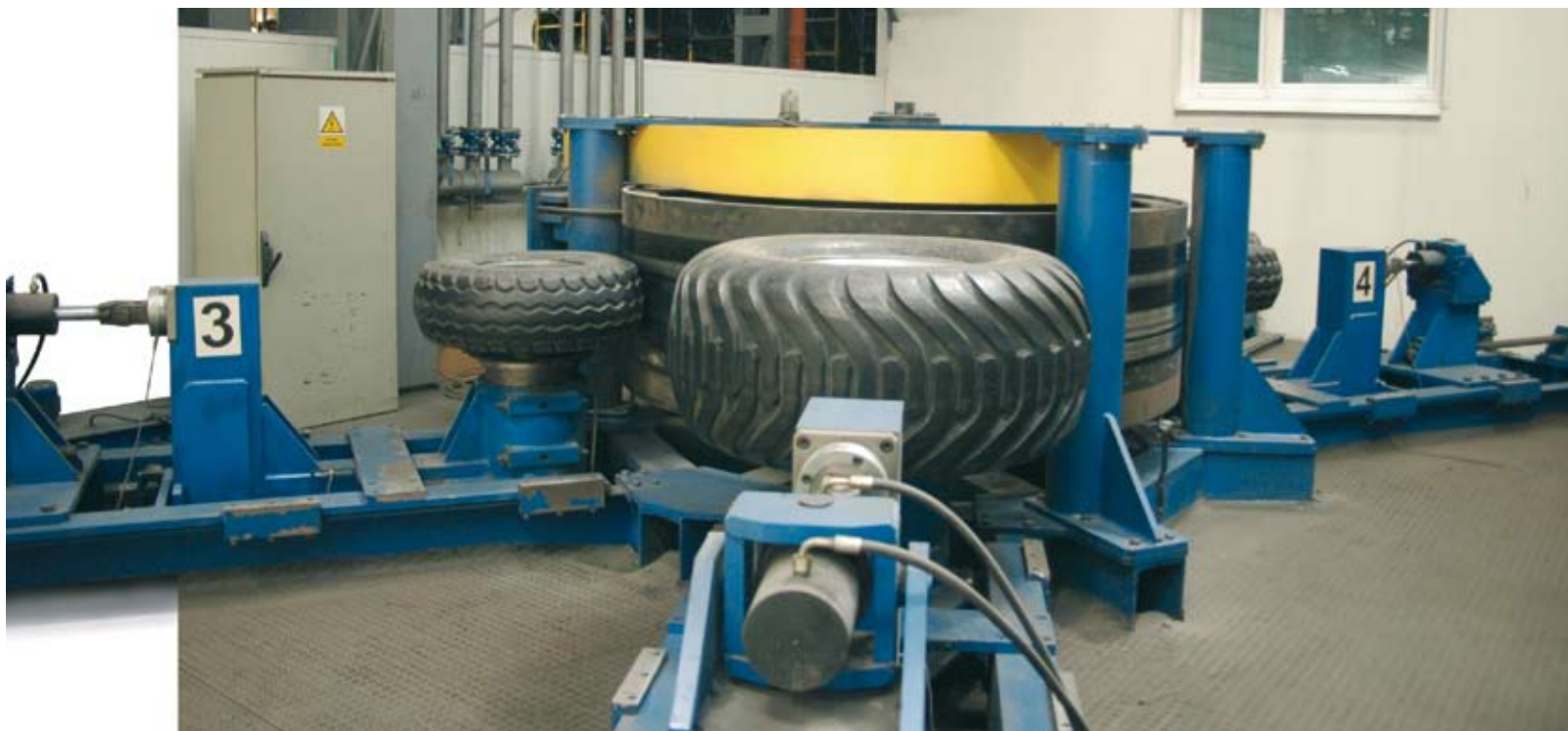
Skonstruowane i wykonane w firmie Pronar urządzenie do badań wytrzymałościowych kół tarczowych i ogumienia rolniczego. Na zdjęciu: badanie trwałości opony rozmiaru 550/60-22,5
