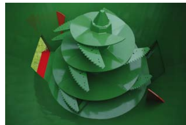
Mieszadło ślimakowe wyposażone w dziewięć regulowanych noży docinających
