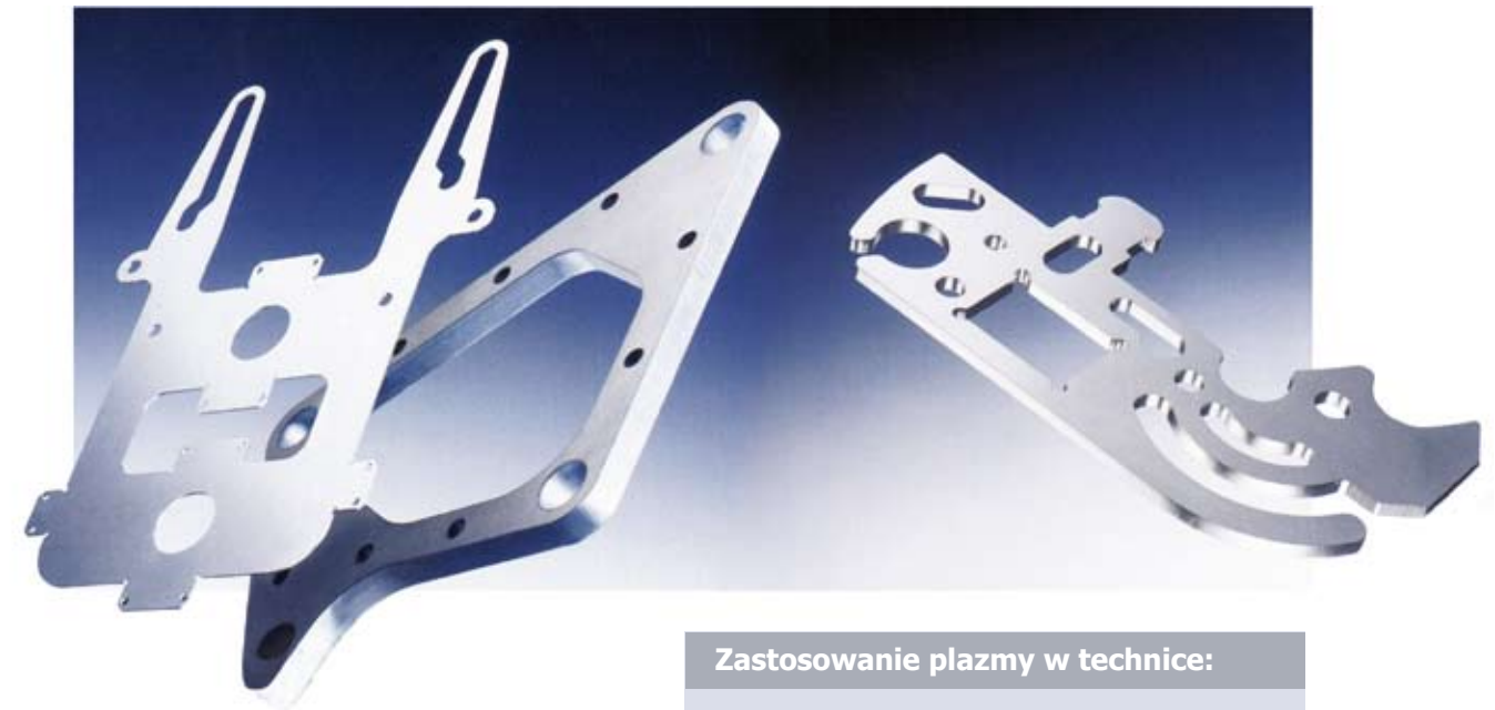
Laserowe cięcie metali stanowi nowoczesną metodę obróbki o podobnych parametrach wymiarowych jak klasyczna obróbka mechaniczna. Na zdjęciu: detale wykorzystywane do produkcji ciągników
