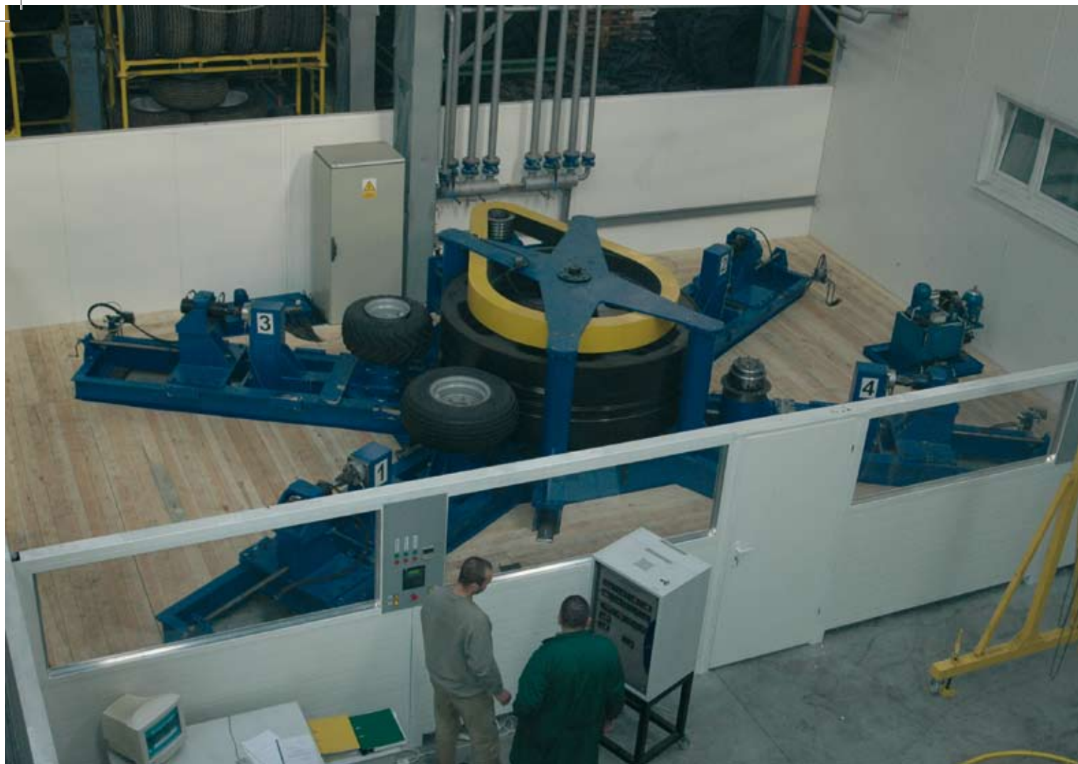
Laboratorium badawcze – badanie koła na obciążenia promieniowe
