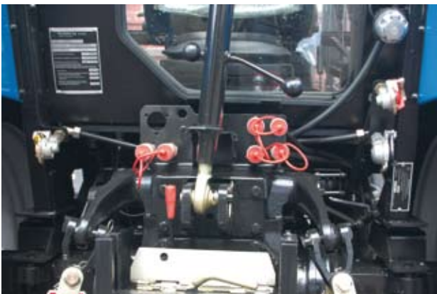
Trzy pary szybkozłącznych hydraulicznych oraz trzy sztuki pneumatycznych
