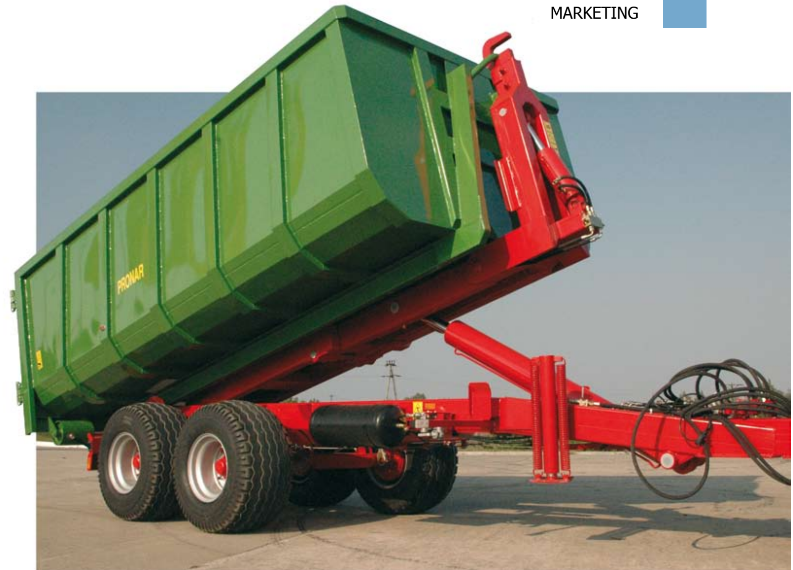
PRONAR T185 - pojemność kontenera w przyczepie T185 to prawie 15 m 3 , przyczepa posiada hakowy mechanizm załadunku wyposażony w hydrauliczną blokadę zawieszenia przy wyładunku i załadunku kontenera
