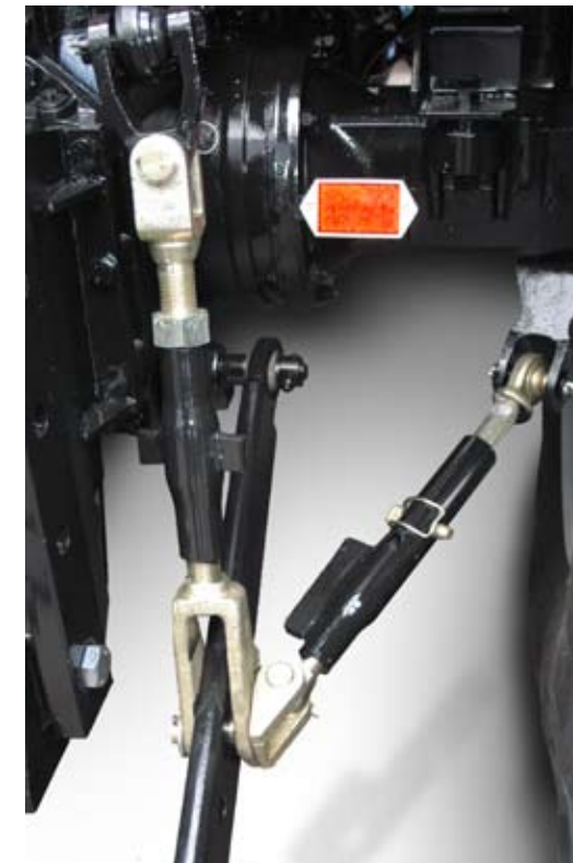
Czop zawieszenia cięgł dolnych oraz stabilizator
