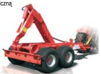
PRONAR T185 - dzięki hakowi umieszczonemu na podwoziu przyczepy kąt wywrotu kontenera wynosi aż 46°
