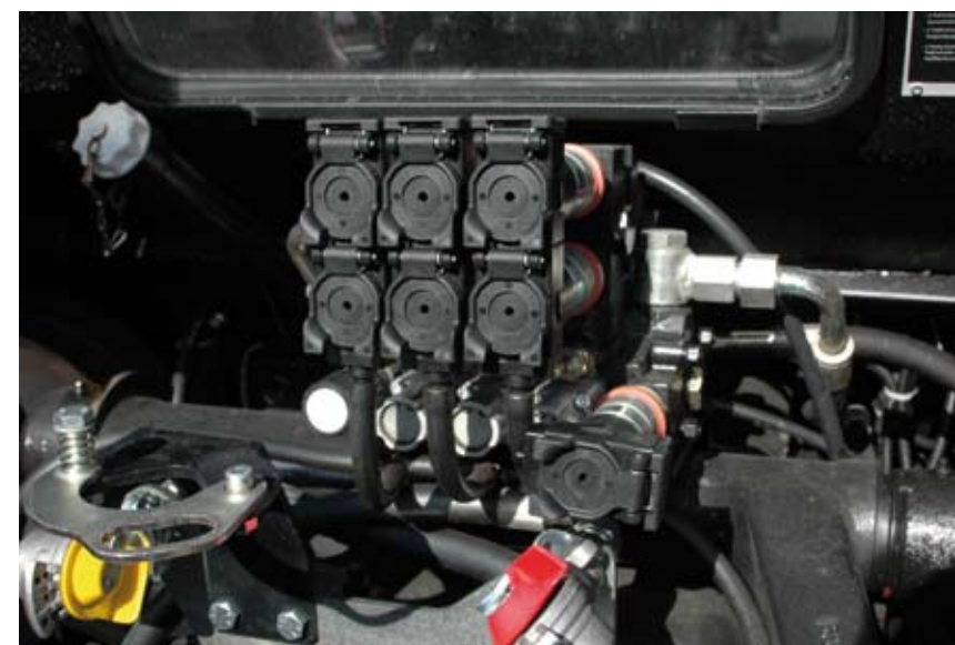
Tylne wyjścia hydrauliki zewnętrznej z ociekaczami, służące do podłączenia maszyn sterowanych hydraulicznie
