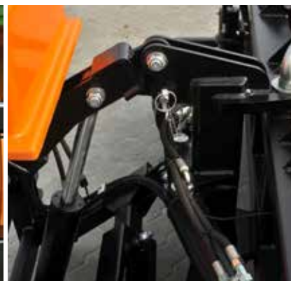
Attuatore idraulico per sollevamento / abbassamento
