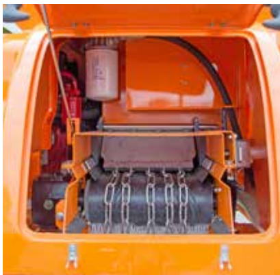
Il materiale viene trasportato da un nastro trasportatore al sistema di alimentazione
