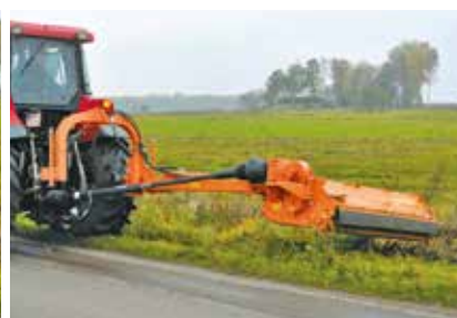
Lo spostamento idraulico della falciatrice di 1820 mm consente di lavorare con tutta la larghezza al di fuori del profilo del trattore
