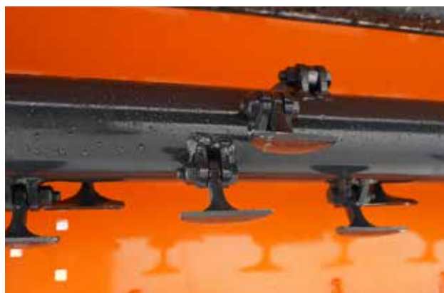
Rullo di taglio con lame intercambiabili
