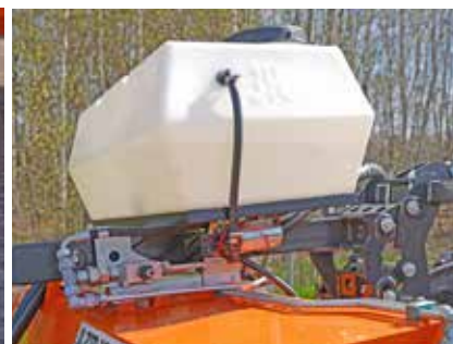
Serbatoio d'acqua con capacità di 200 litri
