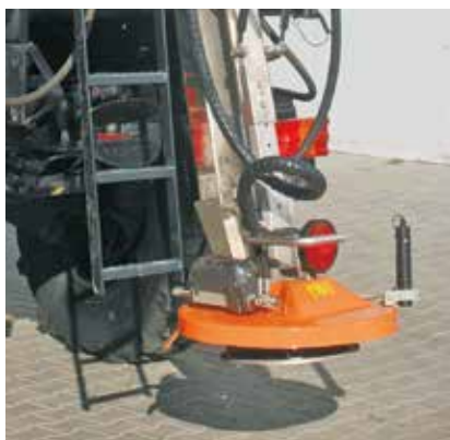
Altezza regolabile dell'adattatore spargitore
