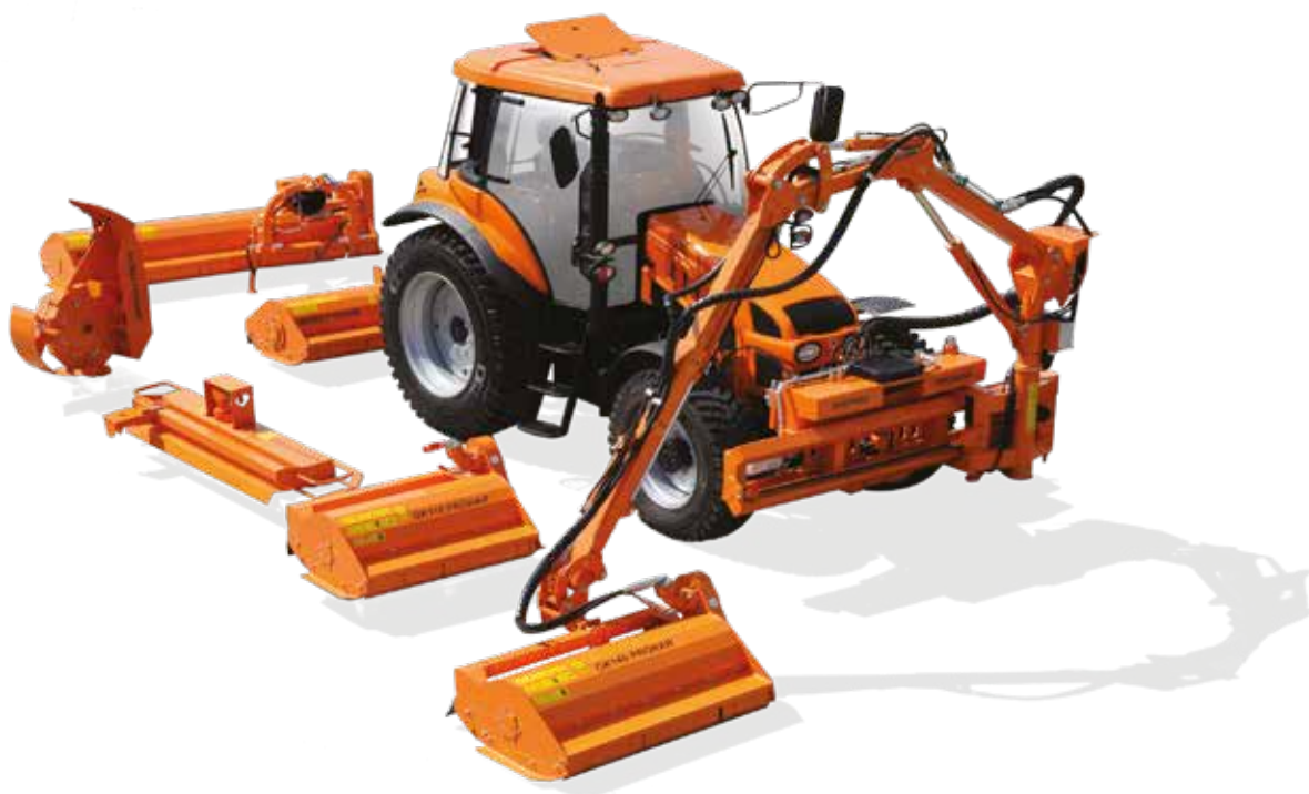
Scorrimento idraulico del braccio sulla guida che consente di scegliere la posizione di lavoro appropriata
