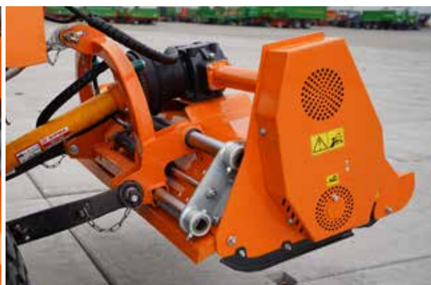
Sospensione mobile (scorrimento trasversale idraulico 350 mm)
