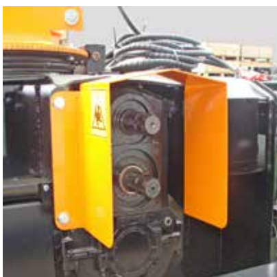
Trasmissione con due estremità PTO (540/1000 giri/min)
