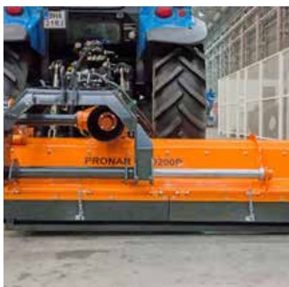
Spostamento idraulico della falciatrice 440 mm
