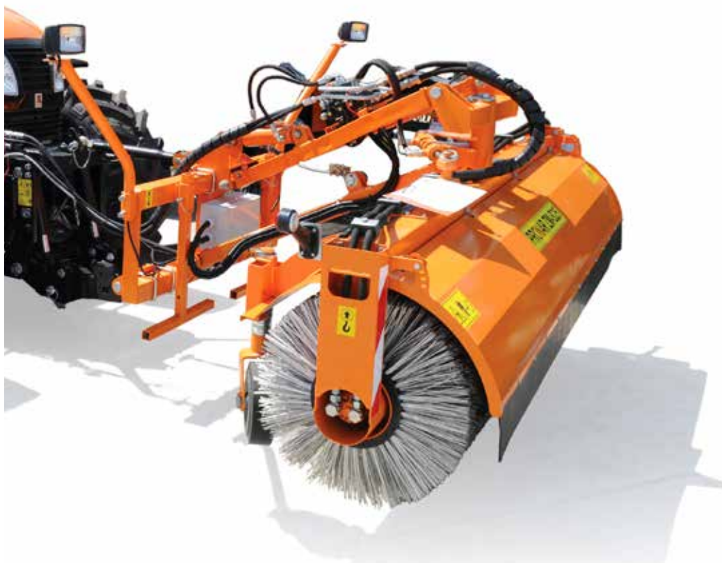
Sterzo idraulico della spazzola \pm 30^\circ
