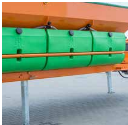
Gambe di supporto a regolazione in altezza che consentono il carico della macchina su un ribaltabile senza l'uso di dispositivi aggiuntivi (sistema RORO)
