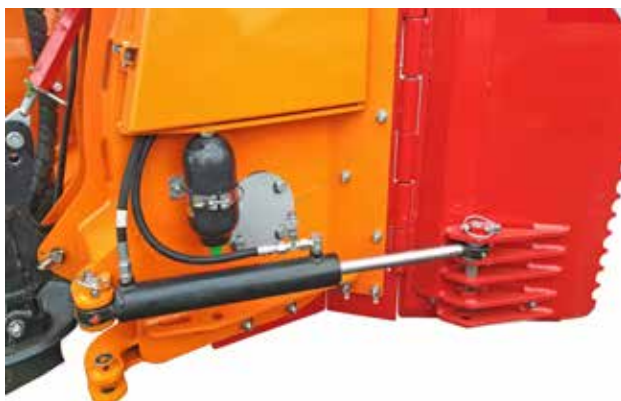
Controllo idraulico delle estensioni
