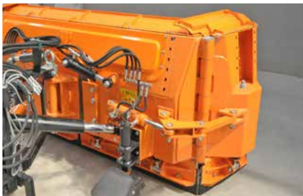
Regolazione idraulica della posizione dell'ala nell'intervallo da -60° a +90°.
