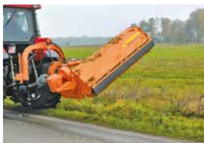
Possibilità di regolare l'angolo di lavoro da -65° a +94°
