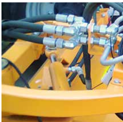
Sterzo idraulico della spazzola \pm 30^\circ
