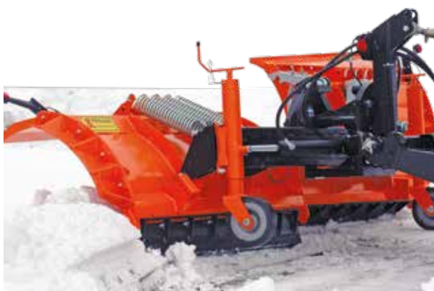
Vomere spezzato con protezione a molla
