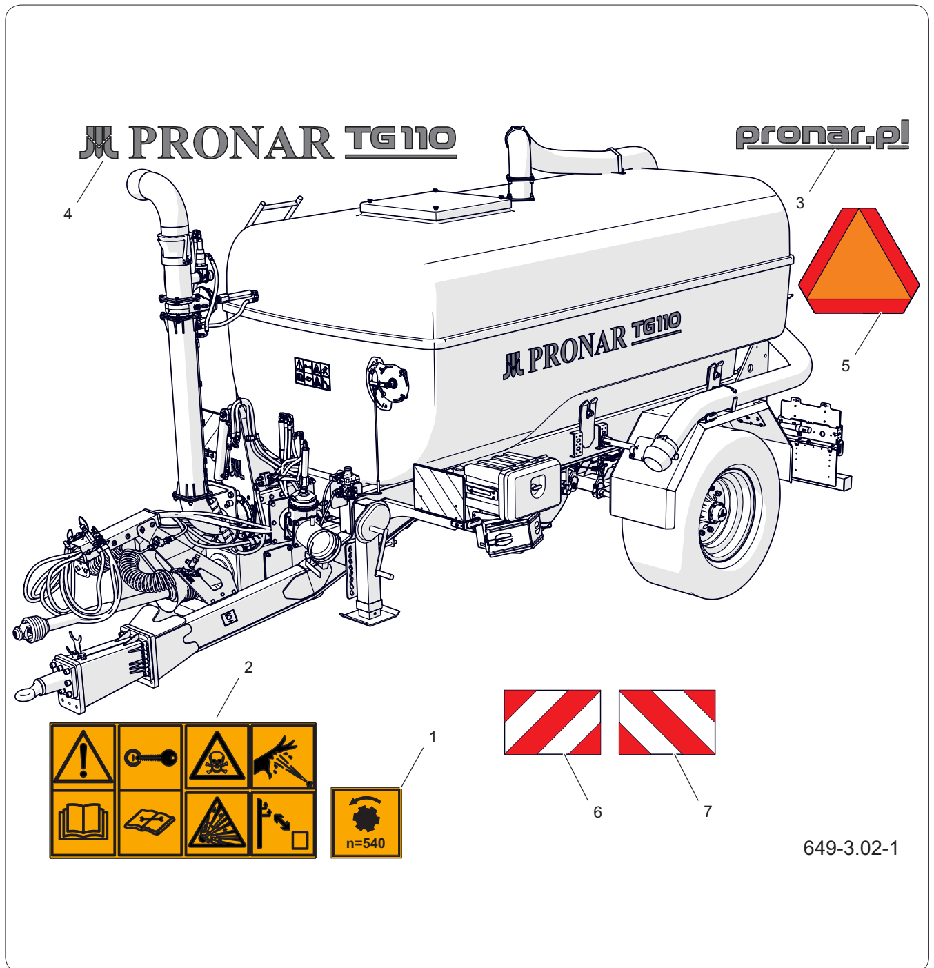
Rysunek 3.3 Rozmieszczenie nalepek informacyjnych i ostrzegawczych
