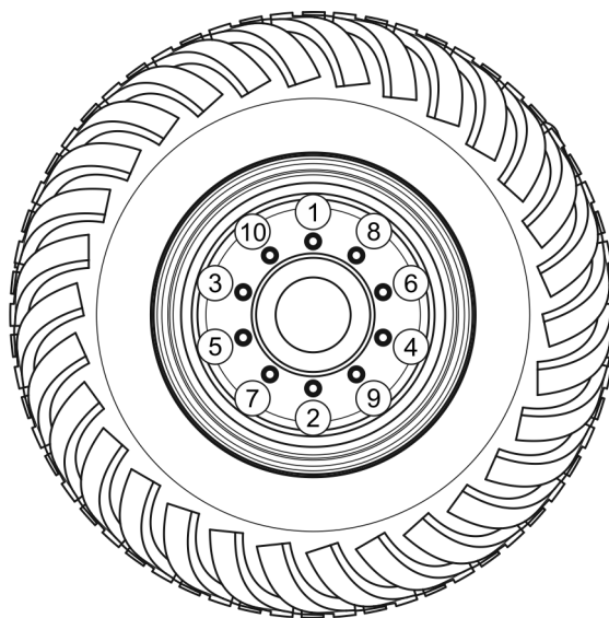
DISEGNO 5.4 Sequenza serraggio e svitamento dadi
