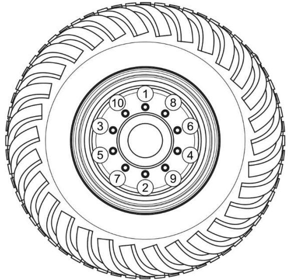
**ABBILDUNG 5.4** Reihenfolge für das Lösen und Anziehen der Muttern.
