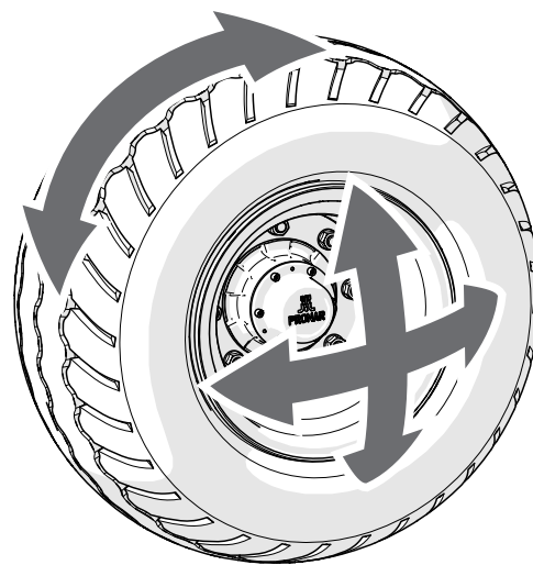
Рисунок 5.9 Проверка зазора в подшипниках
