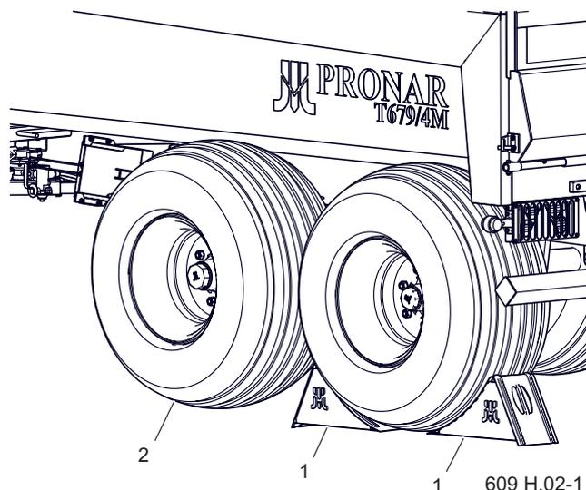
**Abbildung 4.2** Korrekte Positionierung der Keile
