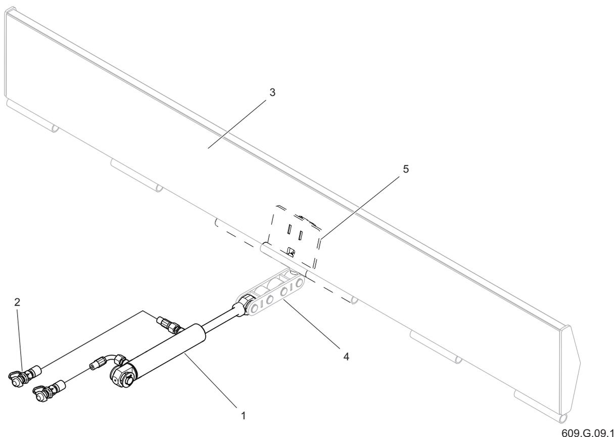
**Abbildung 3.11** Hydrauliksystem der Heckklappe
