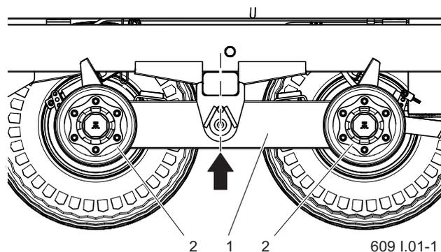
**Abbildung 5.1** Empfohlene Hebepunkte
