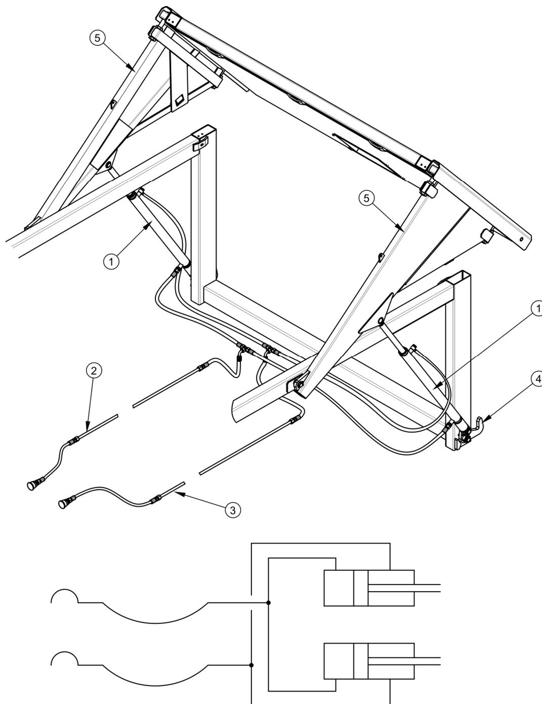
**РИСУНОК 3.11 Устройство и схема гидравлической системы заднего борта**
