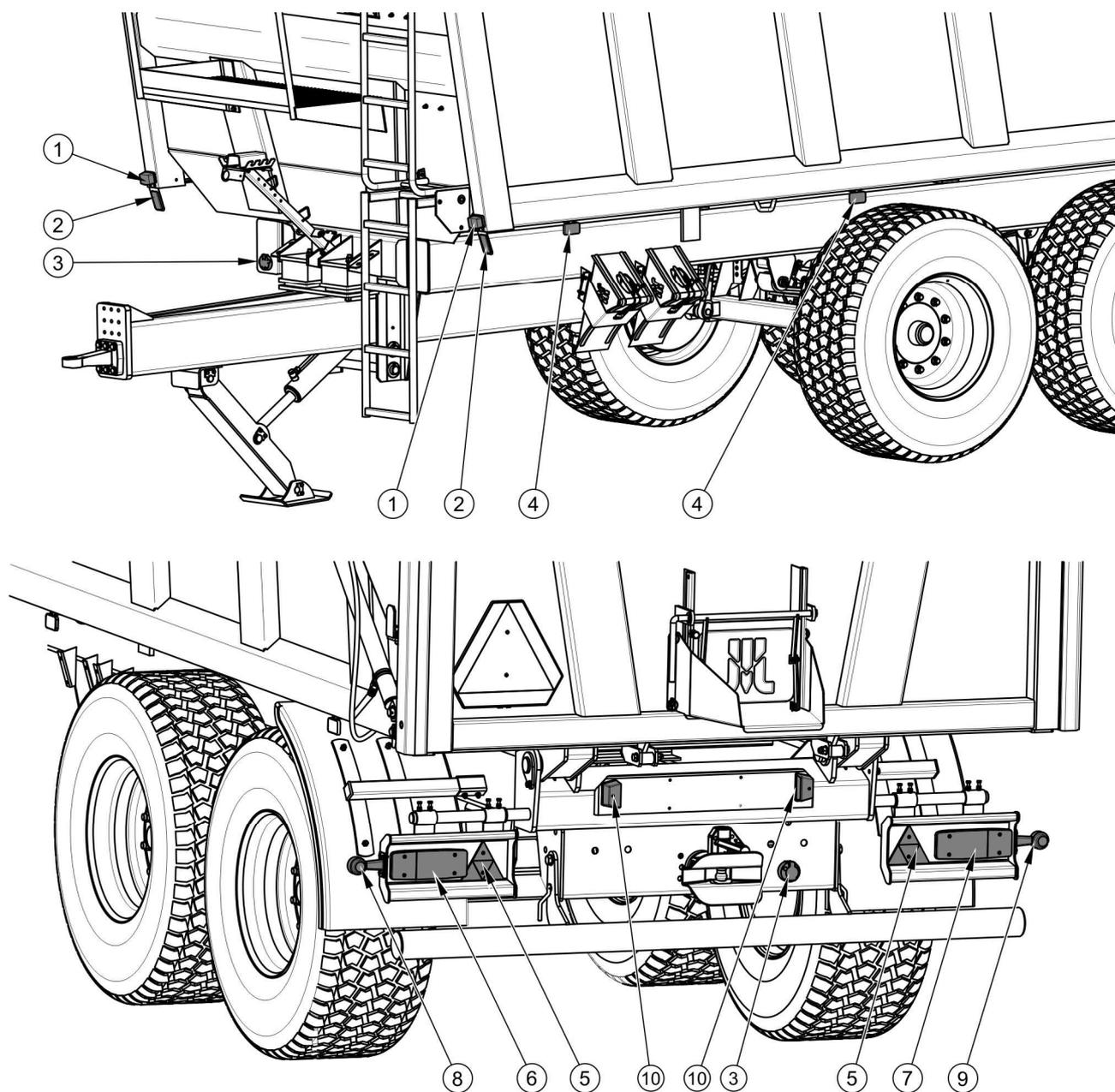
**РИСУНОК 3.14** Размещение элементов электрической системы и светоотражающей сигнализации
