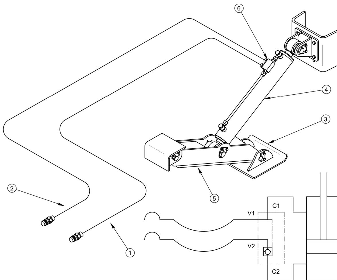
**РИСУНОК 3.10 Устройство и схема гидравлической системы ножевой опоры**
