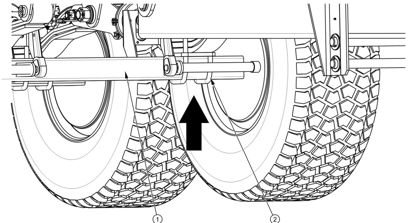
**РИСУНОК 5.2** Точка поддомкрачивания
