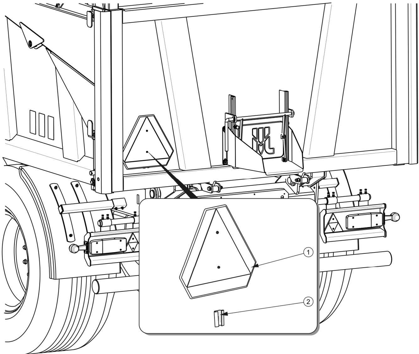
**РИСУНОК 2.2** Размещение треугольного знака медленно движущегося транспортного средства.
