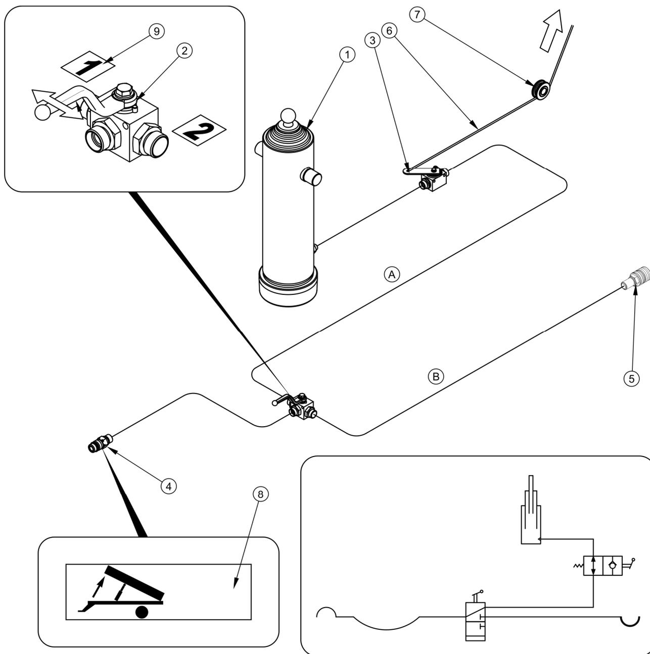
**РИСУНОК 3.9 Устройство и схема гидравлической системы опрокидывания**
