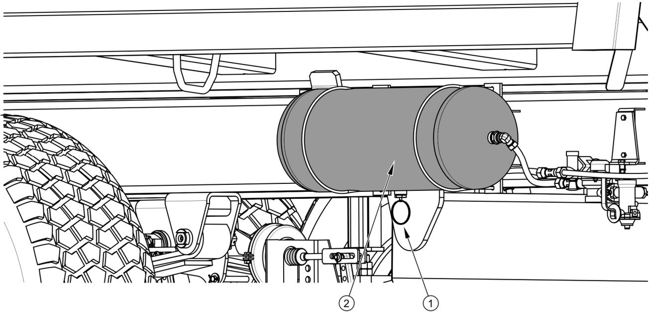
**РИСУНОК 5.9 Отвод конденсата из емкости для сжатого воздуха**
