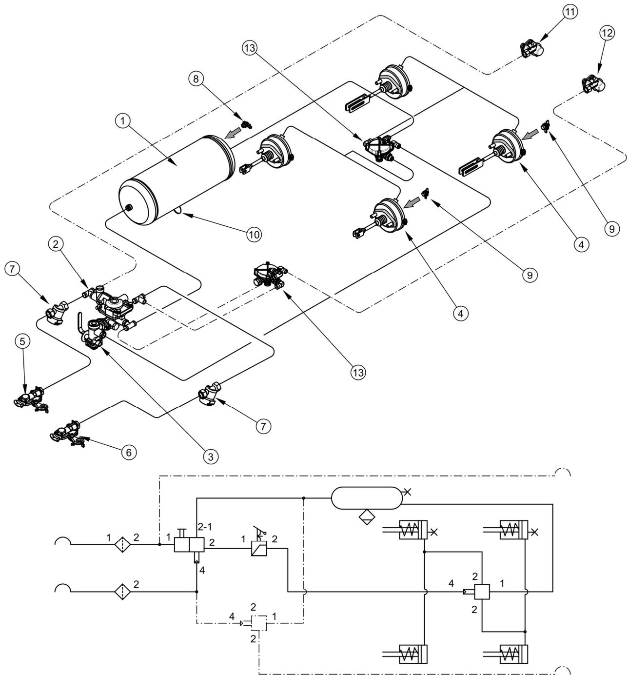
**РИСУНОК 3.5 Устройство и схема пневматической двухпроводной тормозной системы**
