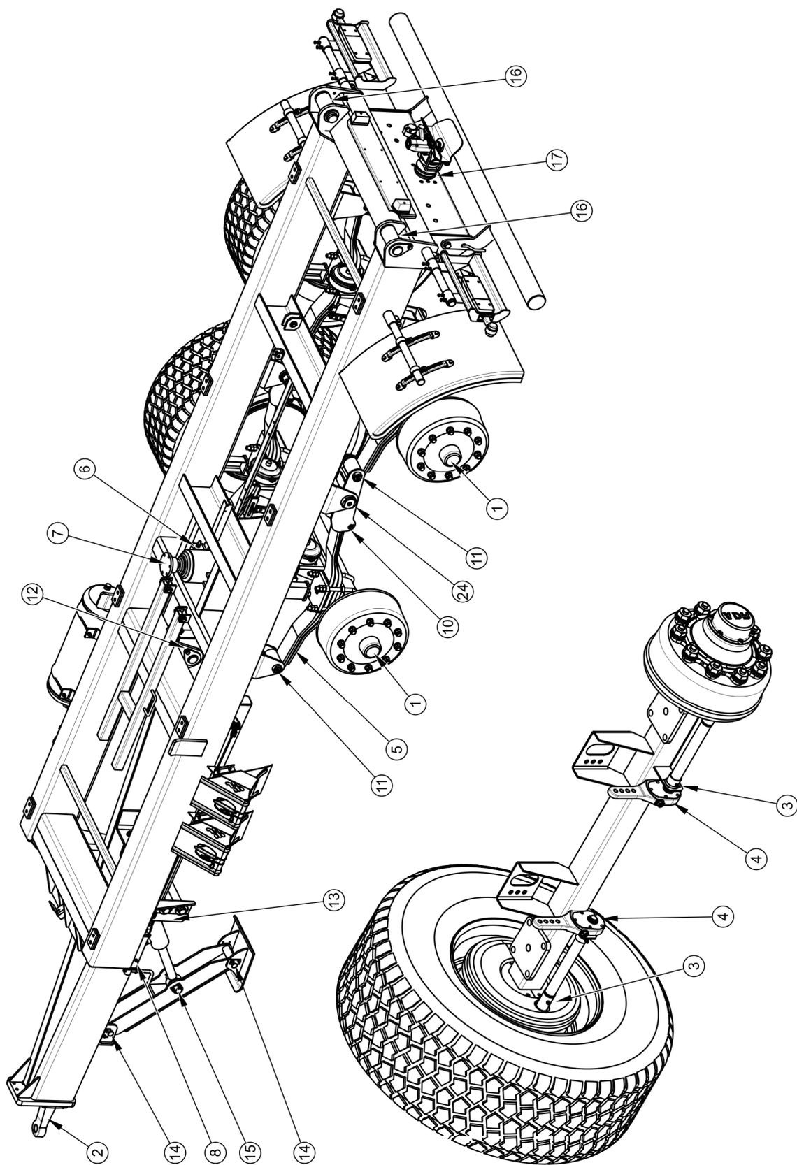
РИСУНОК 5.12 Точки смазки прицепа, часть 2
