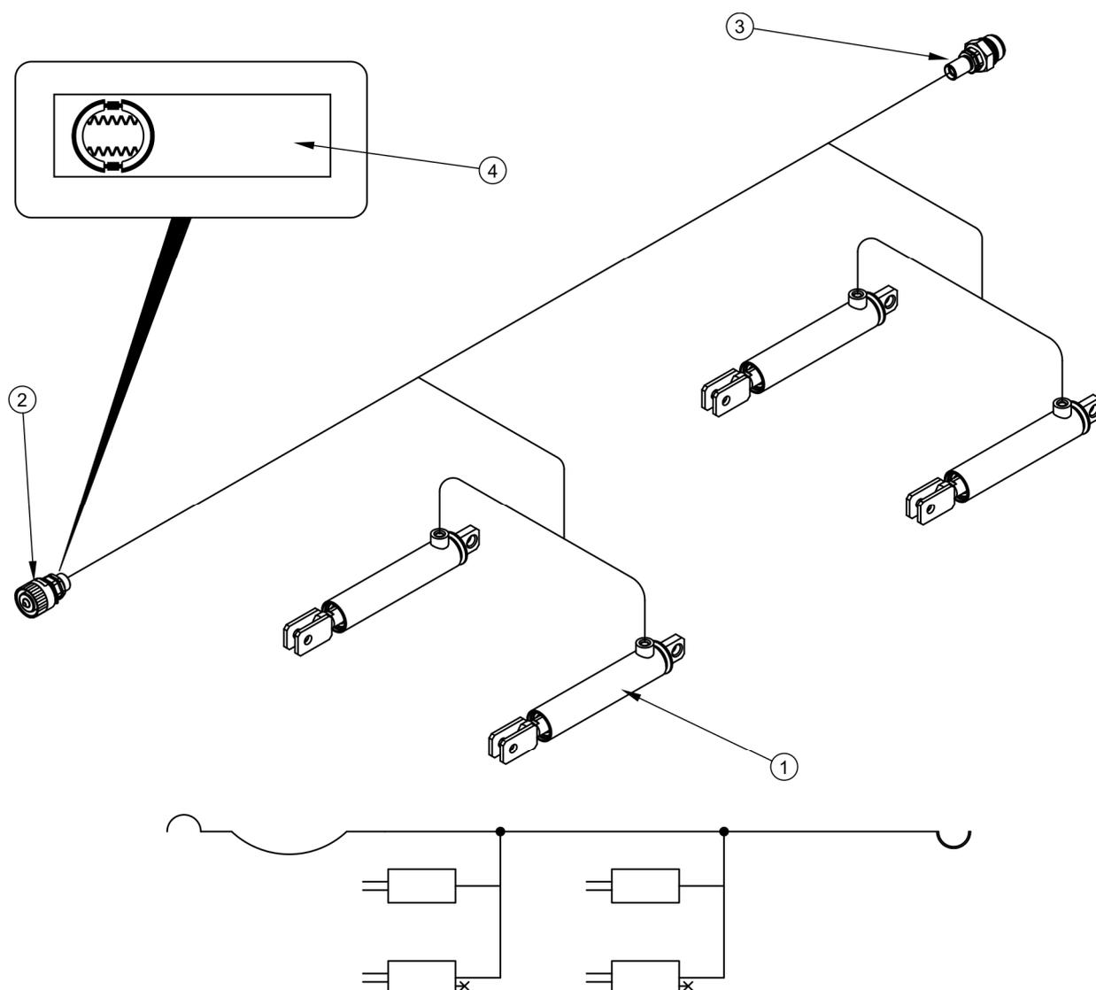
**РИСУНОК 3.7 Устройство и схема гидравлической тормозной системы**
