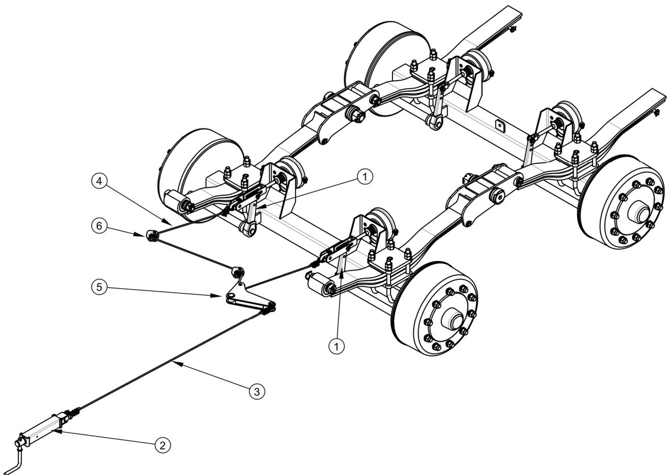
**РИСУНОК 3.13 Устройство стояночного тормоза**
