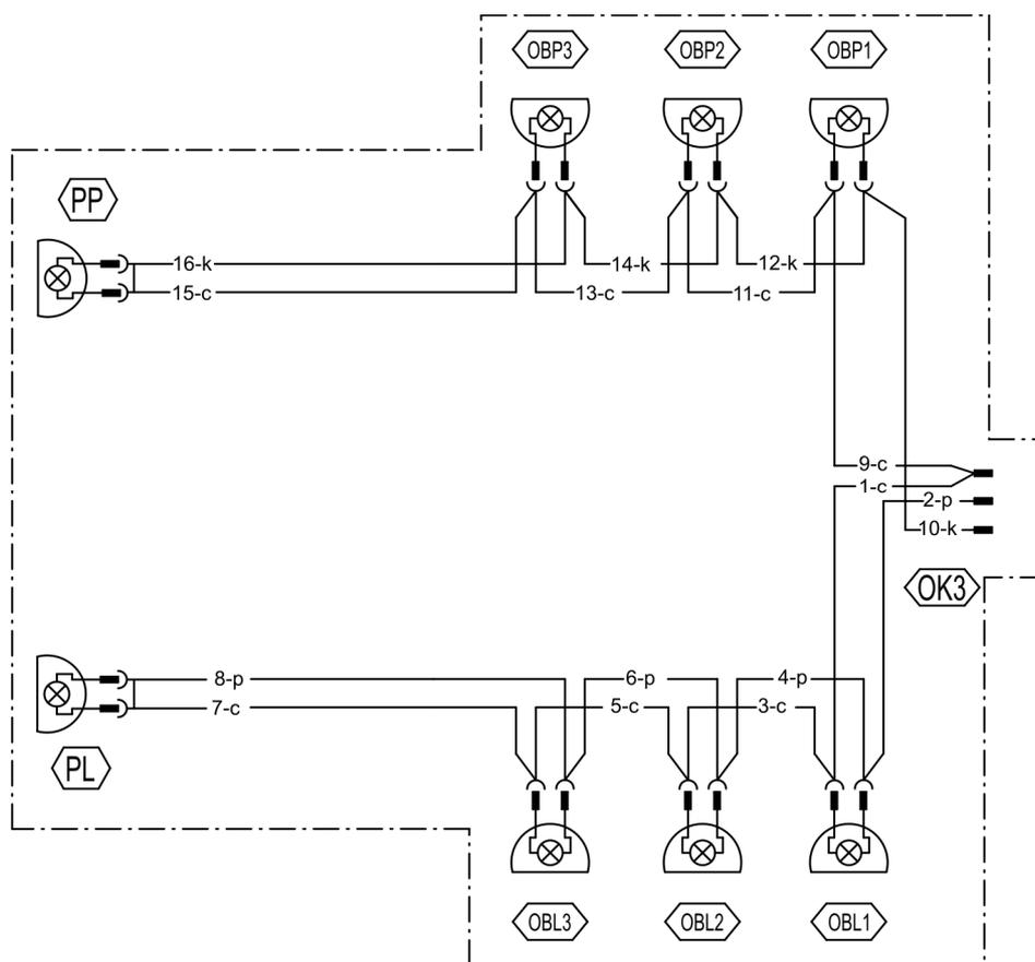
**РИСУНОК 3.16** Принципиальная электрическая схема пучка боковых фонарей
