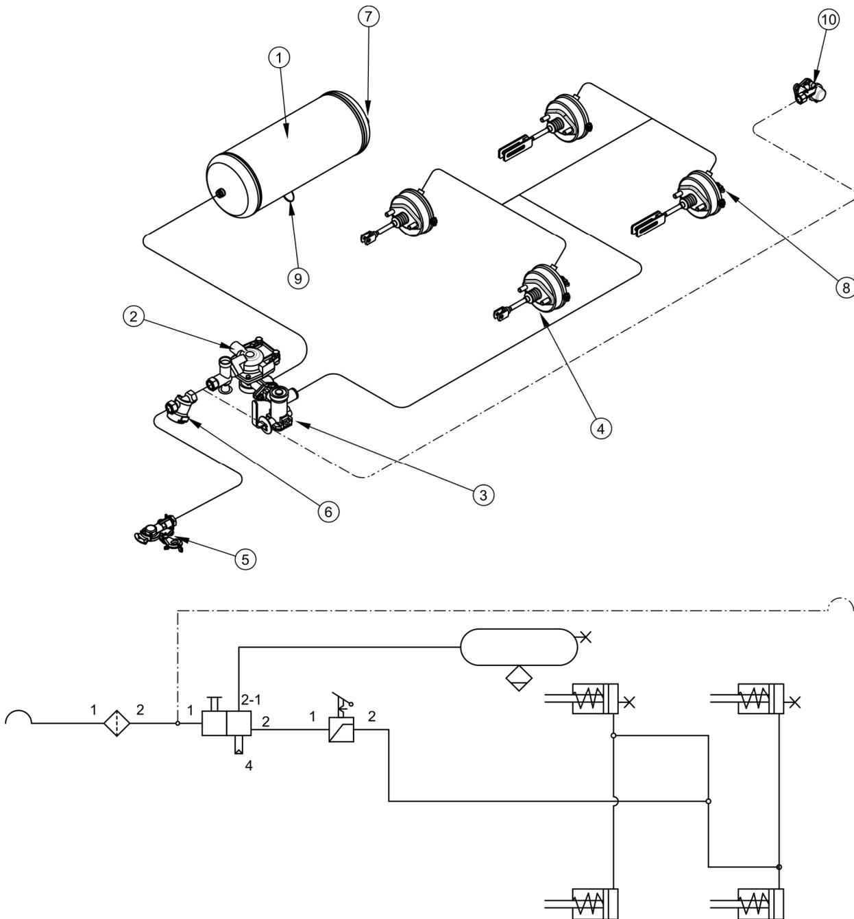
**РИСУНОК 3.4 Устройство и схема однопроводной пневматической тормозной системы**
