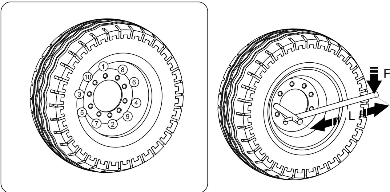
**РИСУНОК 5.4** Очередность затяжки гаек, оси с 10 шпильками M22x1.5
