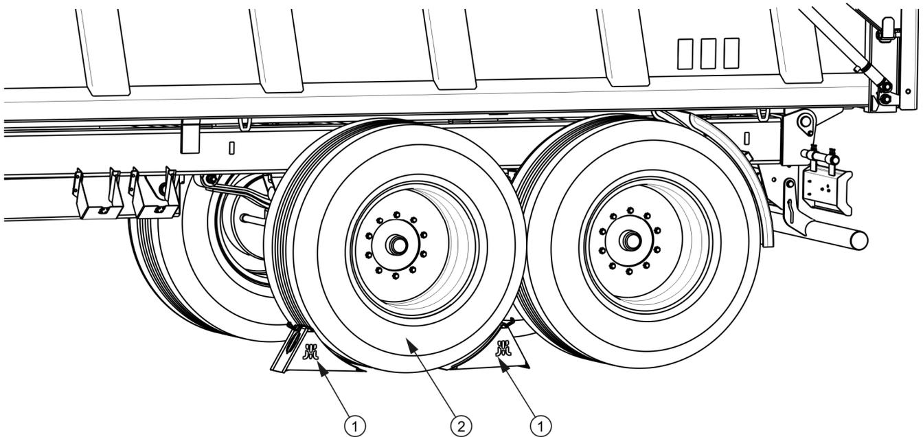
**РИСУНОК 2.1** Способ установки клиньев
