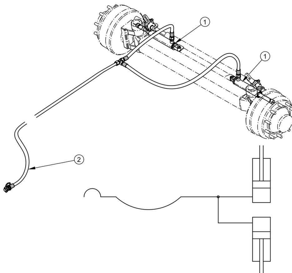
**РИСУНОК 3.12 Устройство и схема гидравлического блокирования поворота**
