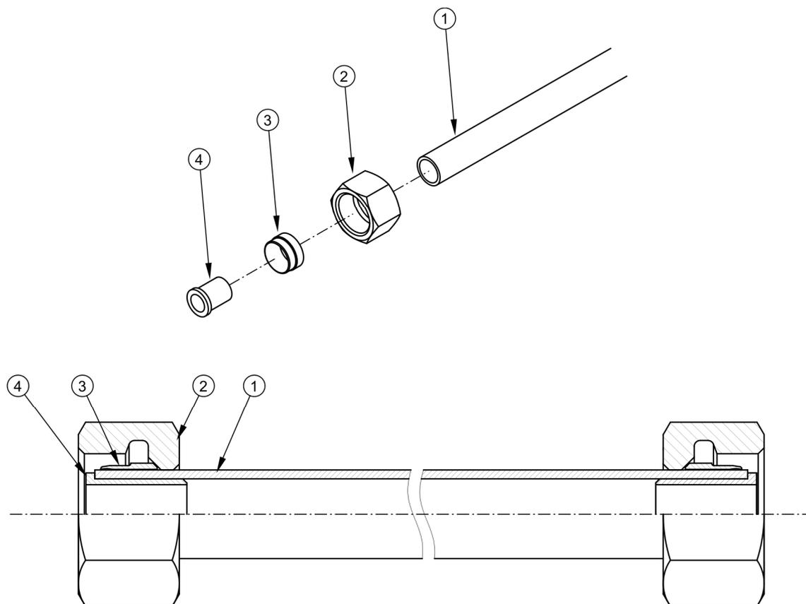
**РИСУНОК 5.10** Монтаж пневмопровода
