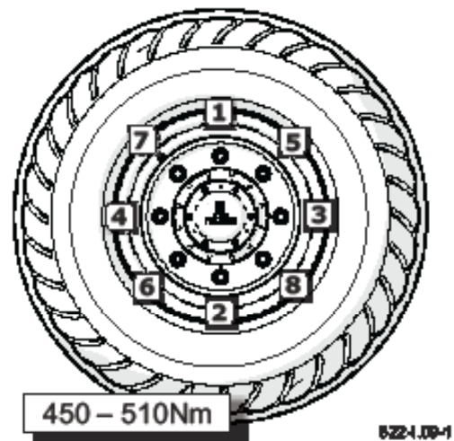
Abbildung 6.16 Die Reihenfolge des Festziehens der Muttern (8 Stück)
