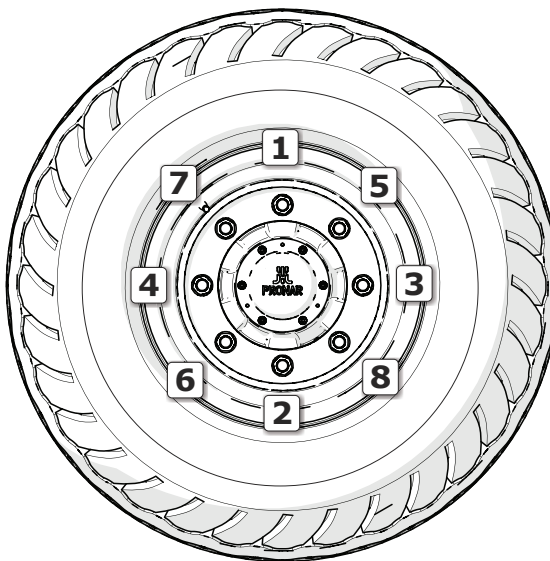
Рисунок 6.1 Очередность затяжки гаек
