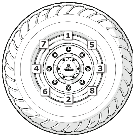
Rysunek 6.1 Kolejność dokręcania nakrętek
