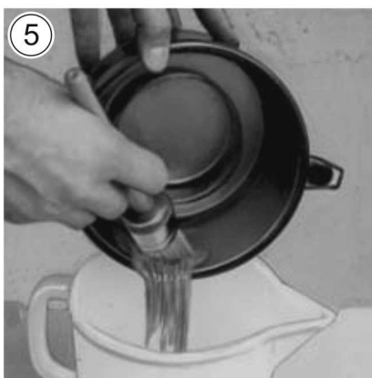
RYSUNEK 5.1 Wymiana oleju i czyszczenie wkładu filtra powietrza
