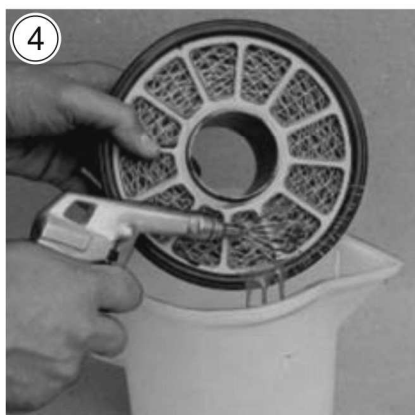
RYSUNEK 5.1 Wymiana oleju i czyszczenie wkładu filtra powietrza
