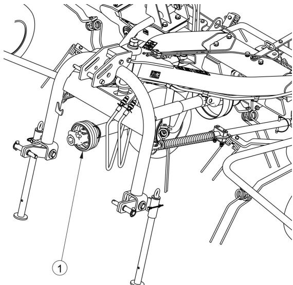
**РИСУНОК 4.6А Телескопический карданный вал с предохранительной муфтой**
