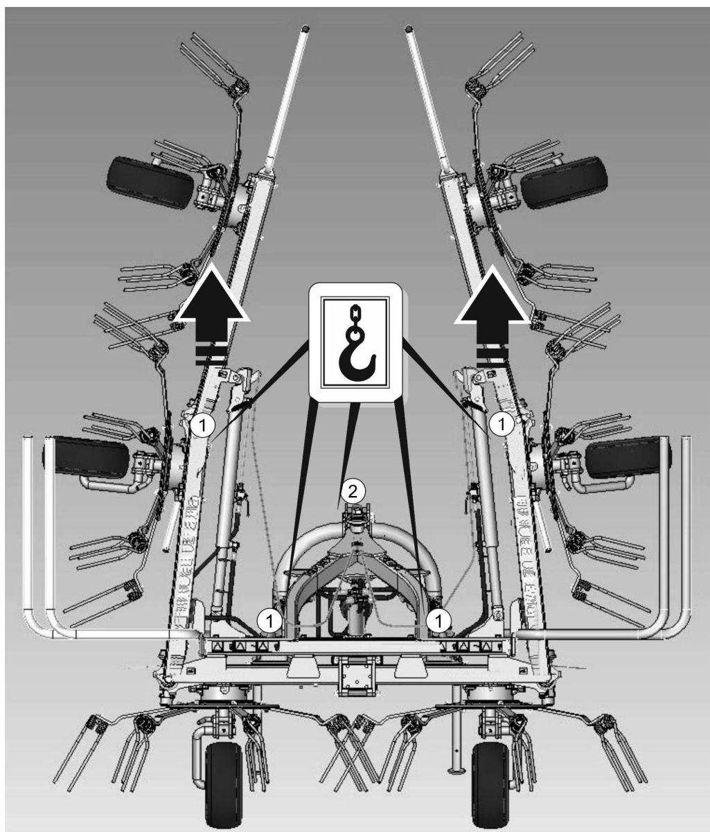
**РИСУНОК 1.2А Места крепления ворошилки-вспушивателя при подъеме**
