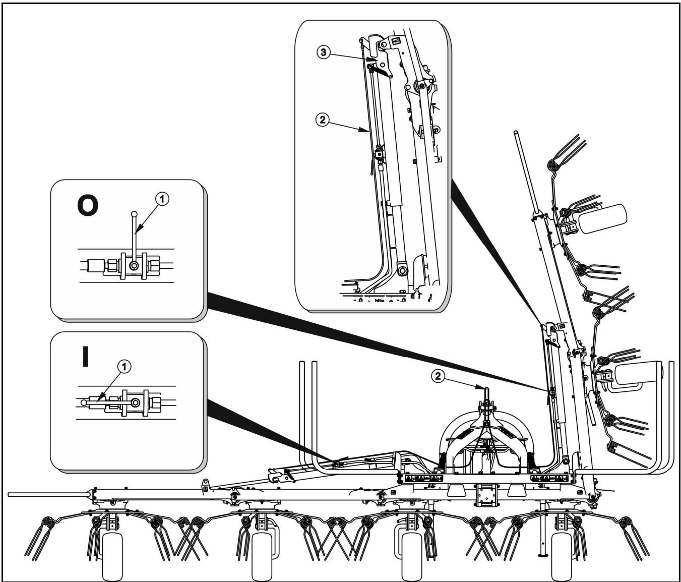
**РИСУНОК 4.3А Установка ворошилки-вспушивателя в рабочее положение**
