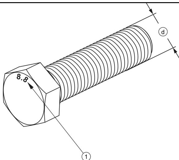
РИСУНОК 5.4А Болт с метрической резьбой
