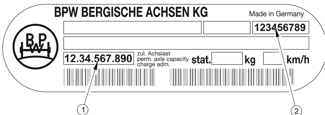
RYSUNEK 1.2 Wzór tabliczki znamionowej osi jezdnej
