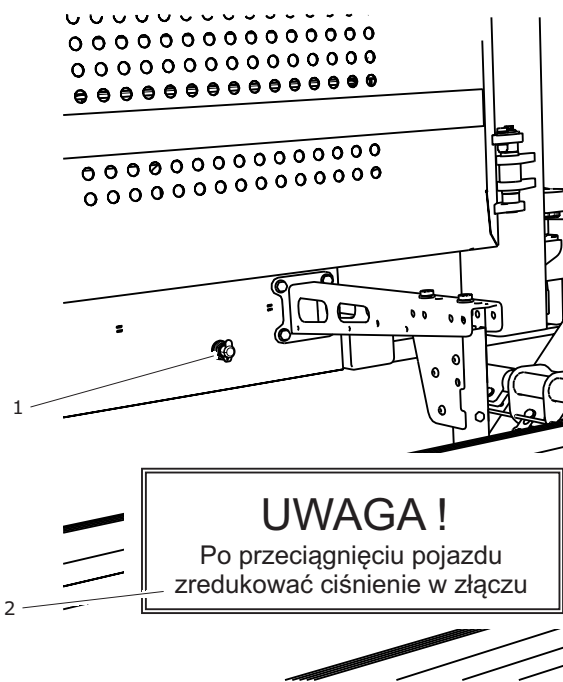
Rysunek 5.47 Zawór napowietrzający (1) zawór (2) naklejka
