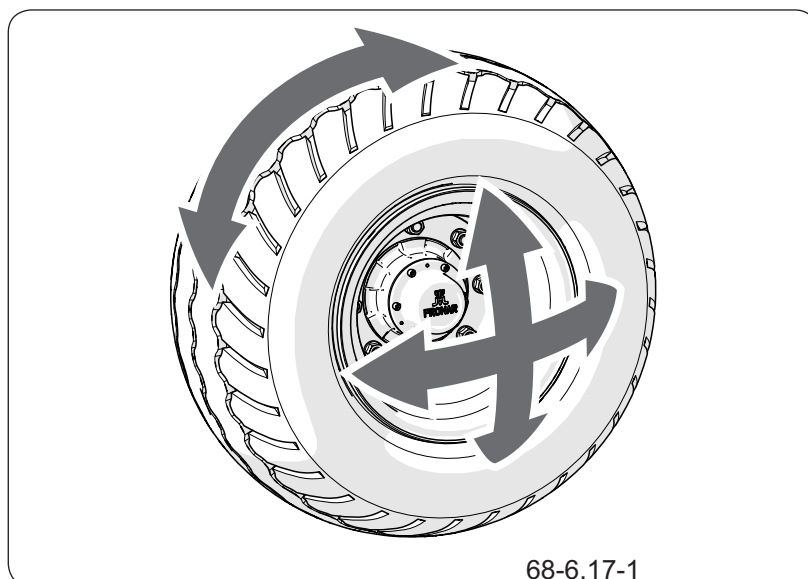
Рисунок 6.6 Проверка люфта подшипников
