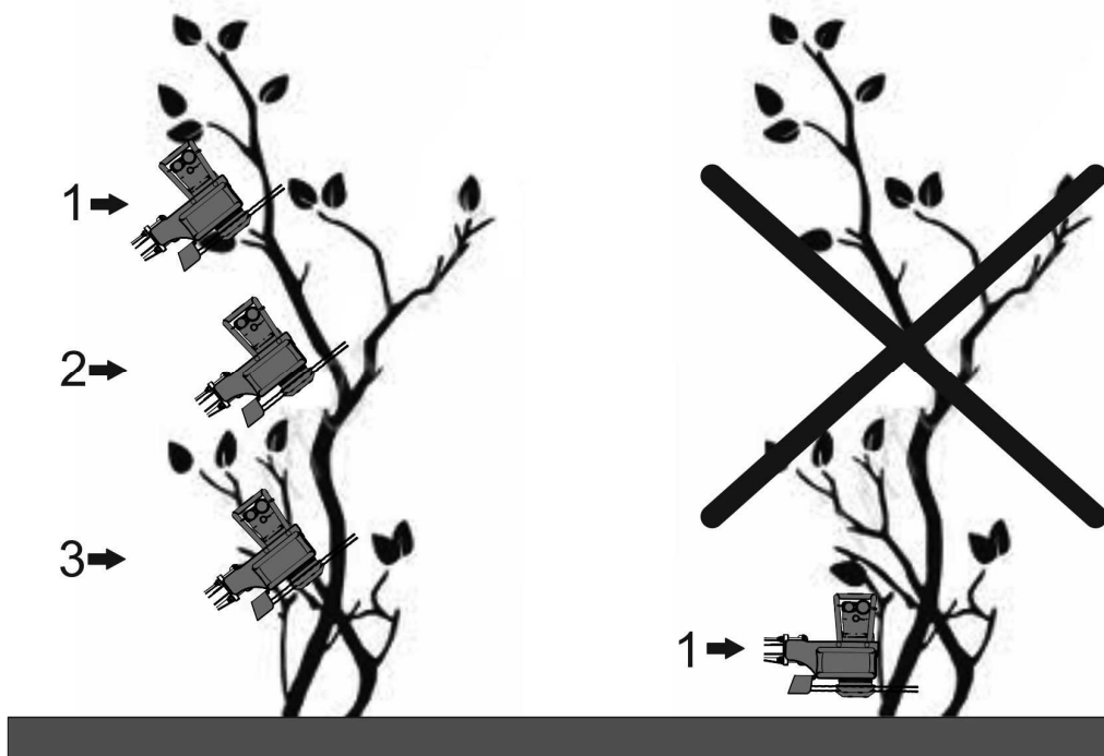
RYSUNEK 4.4 Sposób ustawienia i kolejność przycinania piłą do gałęzi.
