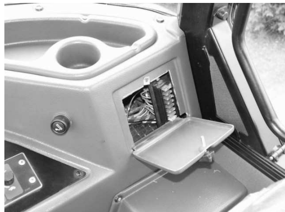
Rys. E-54 Położenie zestawu bezpieczników FB3 na prawym nadkolu. A- śruby; B- pokrywka
