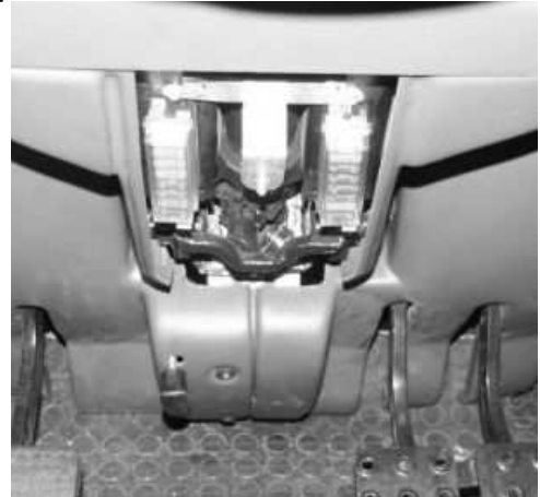
Rys. E-53 Położenie zestawu bezpieczników FB1 i FB2 przy kolumnie kierowniczej. A- śruby; B- pokrywka
