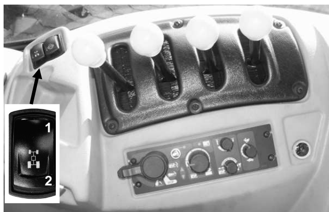
Рисунок 4-26 Выключатель управления приводом переднего моста можно установить в двух положениях: 1 - привод выключен (верхнее положение); 2 - привод включен (нижнее положение).
