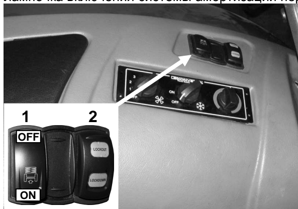
Рисунок 4-33 Переключатели амортизации переднего моста на левом крыле в кабине трактора.
