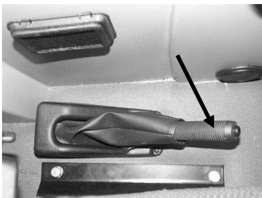
Рисунок 5-2 Стояночный тормоз (аварийный) с левой стороны сиденья.
