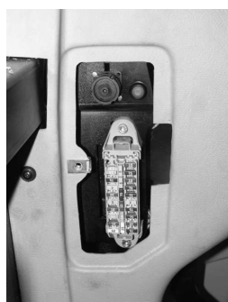
Рисунок 5-32 Расположение комплекта предохранителей с левой стороны рулевой колонки. А- винт; В- крышка
