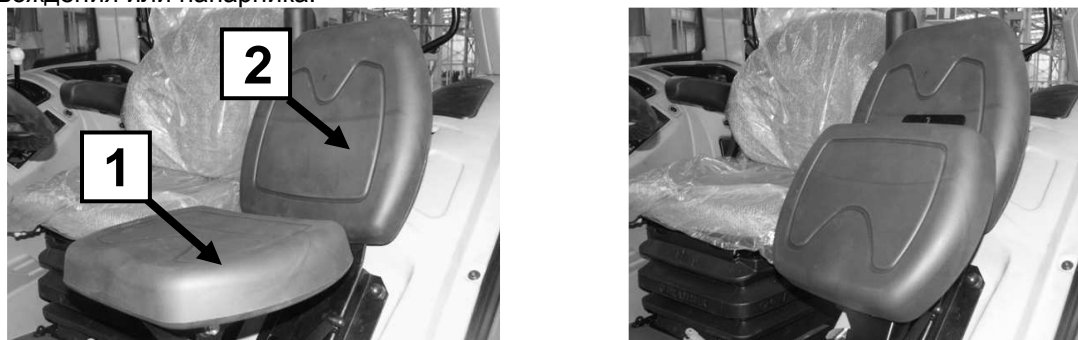
Рисунок 4-20 Дополнительное сиденье. 1 – складная часть сиденья; 2 – спинка сиденья.
