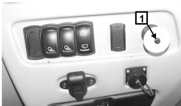
Рисунок 4-30 Выключатели ВОМ в тракторах PRONAR и способ включения привода ВОМ. 1- выключатель заднего ВОМ
