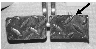
Рисунок 4-24 Планка, блокирующая педали рабочего тормоза.
