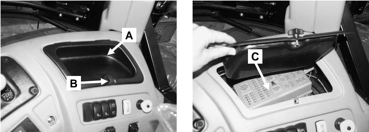
Рисунок 5-33 Расположение комплекта предохранителей и реле на правом крыле. А- крышка; В- болт; С- коробка предохранителей и реле.
