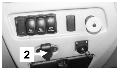
Рисунок 5-29 Присоединение 1 электросети для прицепов и дополнительно гнездо 2 питания +12V 20A для дополнительных устройств, присоединенных к электрической сети трактора.
