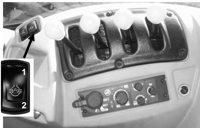
Рисунок 4-27 Управление блокировкой дифференциала переднего моста (находится на панели переключателей с правой стороны сиденья)
