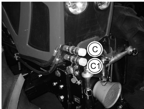
RYSUNEK 4.23 Szybkozłącza hydrauliki zewnętrznej w wersji standardowej i opcjonalnej.
