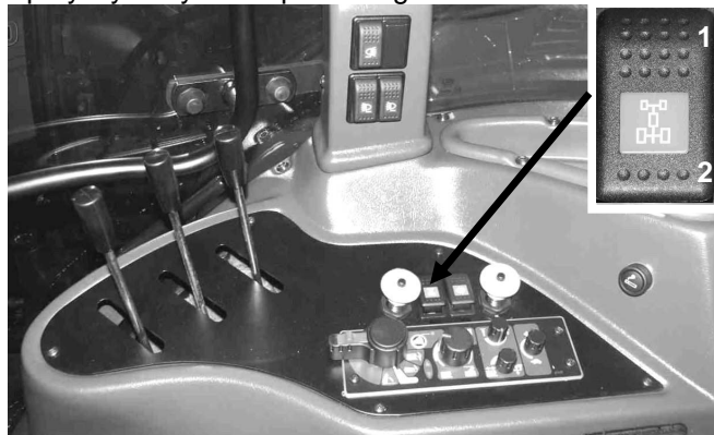
Rysunek 4-27 Włącznik sterowania napędem przedniego mostu można ustawić w dwóch położeniach: 1 - napęd wyłączony (górne); 2 - napęd włączony (dolne).
