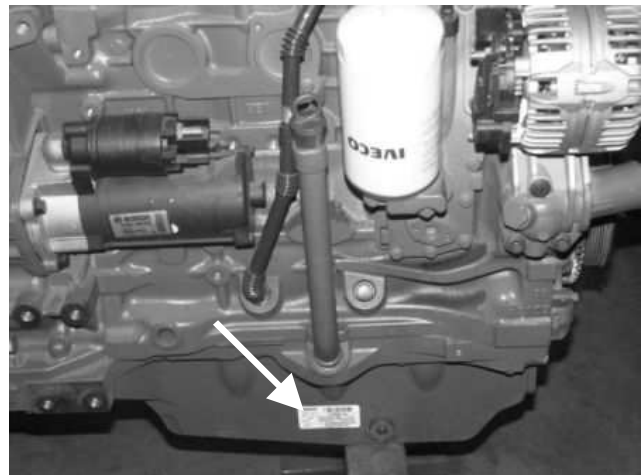
Rysunek 3-2a Położenie tabliczki silnika IVECO (na misie olejowej z prawej strony silnika)
