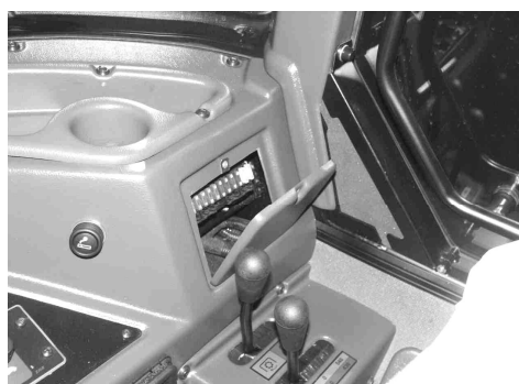
Rysunek 5-35 Położenie zestawu bezpieczników FB3 na prawym nadkolu. A - śruba; B - pokrywka
