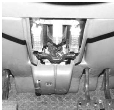
Rysunek 5-34 Położenie zestawu bezpieczników FB1 i FB2 przy kolumnie kierowniczej. A - śruby; B - pokrywka
