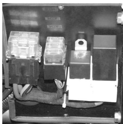
Rysunek 5-36 Położenie zestawu bezpieczników FB4, FB5, FB6. A - śruba; B - pokrywka
