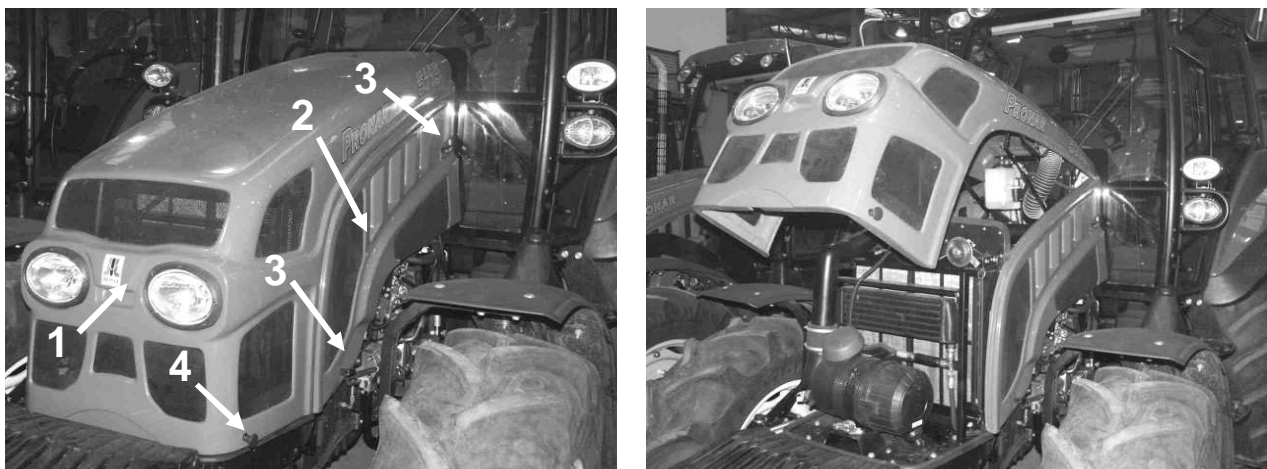
Rysunek 5-41 Maska i osłony boczne silnika. 1 - maska silnika; 2 - osłona boczna; 3 - zatrzaski mocujące osłonę boczną; 4 - ciągiel zamka maski
