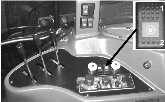
Rysunek 4-28 Sterowanie blokadą mechanizmu różnicowego tylnego mostu (znajduje się na panelu włączników z prawej strony siedziska)
