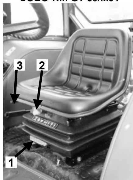
Рис. С-22 Сидение водителя 1-выключатель регулировки жесткости амортизации (в зависимости от веса водителя); 2-вертикальная регулировка; 3-горизонтальная регулировка.
