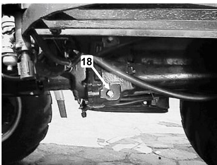
Рис. Е-13 Расположение сливной пробки коробки передач. (18).
