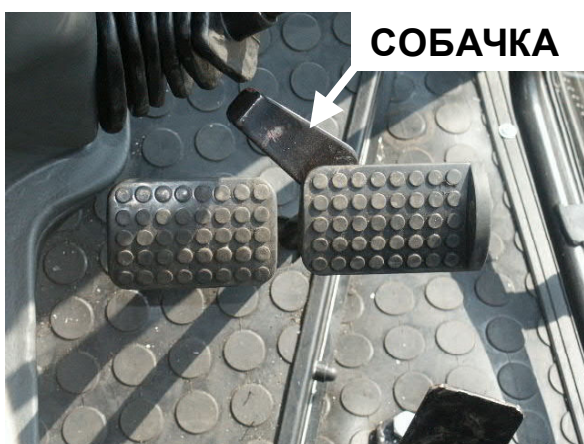
Рис. F-28. Соединить педали тормоза собачкой перед включением „блокады”.
