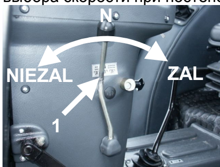
Рис. F-32а Рычаг заднего ВОМ (ЗАВИСИМЫЙ-НЕЗАВИСИМЫЙ) (с левой стороны рулевой колонки) и пиктограмма
