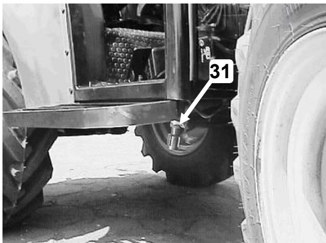
Рис. Е-25 Сливная пробка отопителя кабины (31) - шт. 2 с правой и левой стороны кабины.
