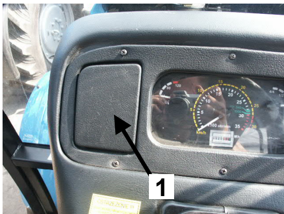
Рис. F-89 Расположение предохранителей в консоли. 1- защита; 2- коробка предохранителей; 3- реле.
