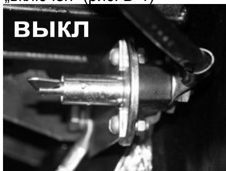
Рис.D-1 Положения выключателя „массы”
