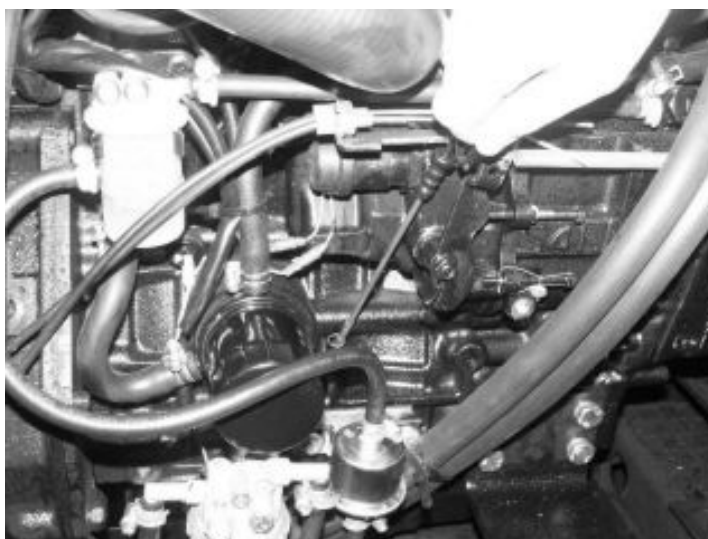
Рис. Е-5 Щуп измерения уровня масла. Расположен с правой стороны трактора. Уровень масла нужно удерживать в пределах L - H.
