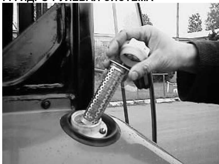
Рис. Е-18 Пробка налива масла гидравлической и рулевой систем и наливной фильтр.
