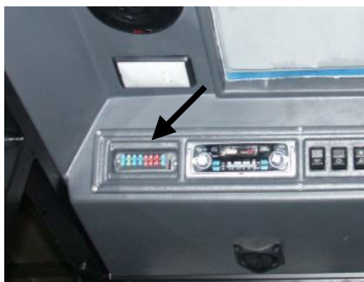
Рис. F-90 Схема и описание предохранителей, расположенных в консоли.
