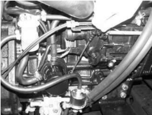
Abb. E-5 Stabanzeiger des Ölstands. befindet sich an der rechten Seite des Schleppers. Ölstand soll zwischen Markierungen L - H gehalten werden.
