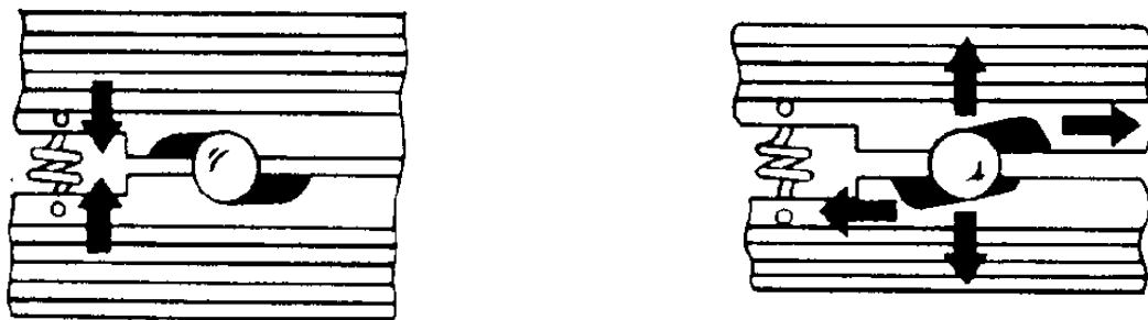
Abb. F-59 Funktionsprinzip der Scheibenbremsen A- Ruhelage; B- Betriebslage
