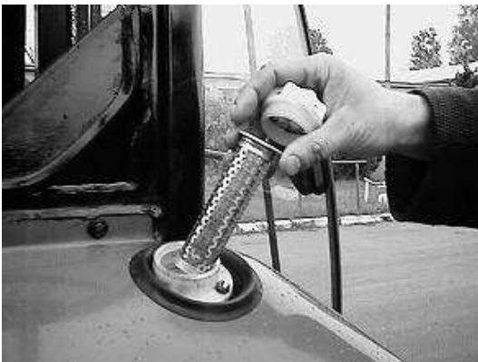
Abb. E-18 Öleinfülldeckels der Hydraulikanlage und Lenkung samt mit dem Einfüllfilter.
