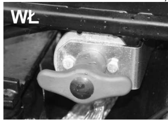
Abb.D-1 Stellungen des Einschater der „Masse“
