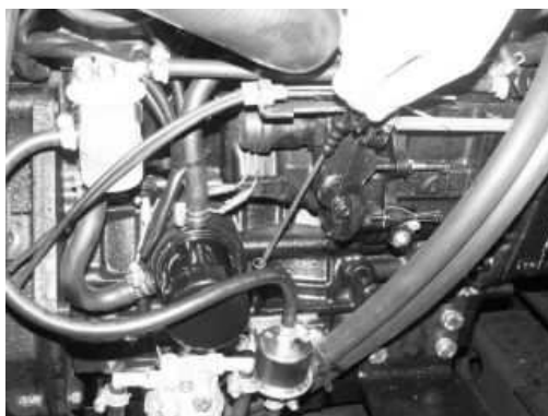
Rys. E-5 Wskaźnik prętowy poziomu oleju. Położony jest z prawej strony ciągnika. Poziom oleju utrzymać między wycięciami L - H.
