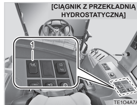
(1) Przełącznik zmniejszający obroty silnika podczas pokonywania zakrętów
