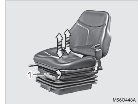
(1) Dźwignia regulacji twardości siedziska
