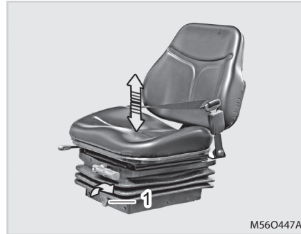
(1) Dźwignia regulacji wysokości siedziska
