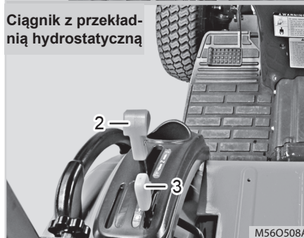
(1) Główna dźwignia zmiany biegów (2) Dźwignia zmiany zakresu przełożeń przekładni (3) Dźwignia zmiany trybu pracy WOM
