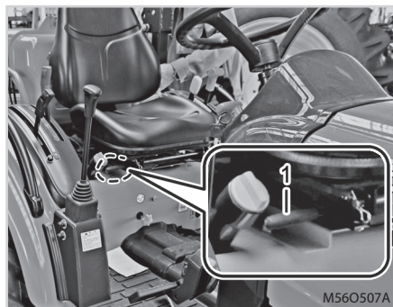
(1) regulacja równowagi poziomej (przód / tył)
