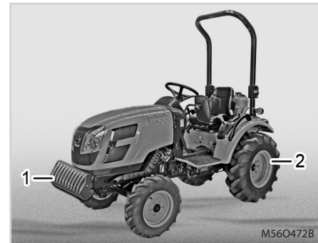
(1) Obciążnik przedni (2) Tylny obciążnik
