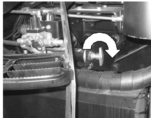
Rysunek 4-2 Włącznik akumulatora na zewnątrz ciągnika z prawej strony.
