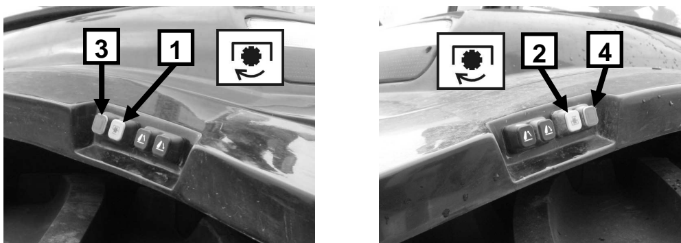
Rysunek 3-31 Włacznik WOM-u na lewym 1 i prawym 2 tylnym błotniku ciągnika oraz wyłącznik WOM-u na lewym 3 i prawym 4 tylnym błotniku ciągnika.
