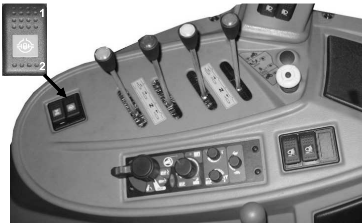
Rysunek 3-27 Sterowanie blokadą mechanizmu różnicowego przedniego mostu (znajduje się na panelu włączników z prawej strony siedziska)
