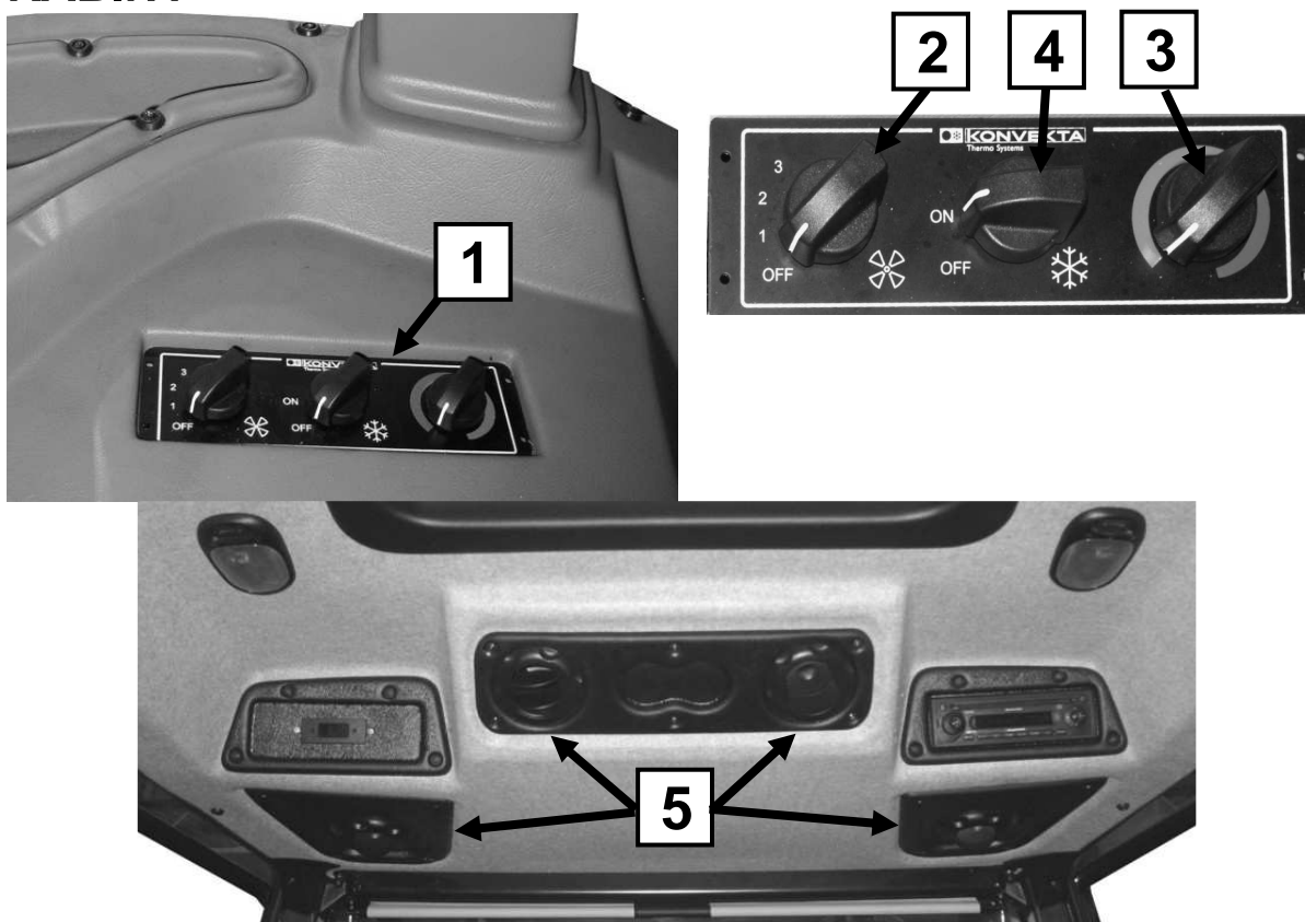
Rysunek 3-21 Układ wentylacji, ogrzewania i klimatyzacji kabiny.
