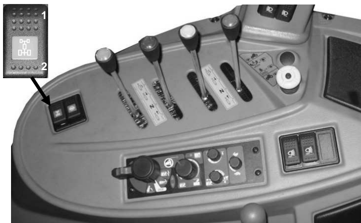
Rysunek 3-26 Włacznik sterowania napędem przedniego mostu można ustawić w dwóch położeniach: 1 - napęd wyłączony (górne); 2 - napęd włączony (dolne).
