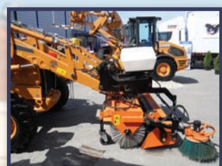
Zamiatarka na ładowaczu czołowym, który może pracować na różnych ciągnikach
