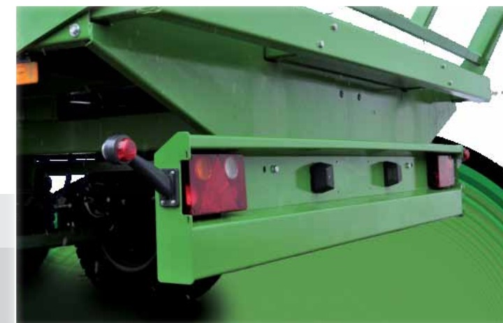
Protection anti-encastrement arrière avec éclairage arrière intégré
