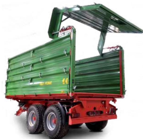
Châssis SILO avec paroi arrière hydrauliquement relevable disponibles pour les modèles : T663/1, T663/2, T663/3, T663/4. Hauteur des parois de la caisse : 600 + 500 + 500
