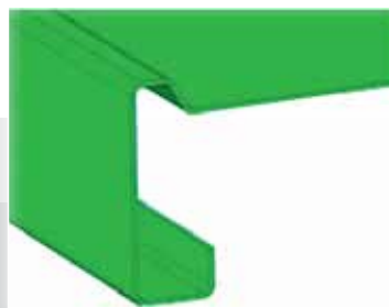
Rebords latéraux profilés et arrondis : empêchent la charge de glisser de la remorque et n'endommagent pas les balles enrubannées
