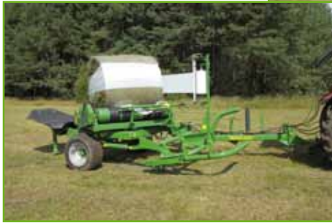
Chargement frontal en avançant vers le côté de la balle
