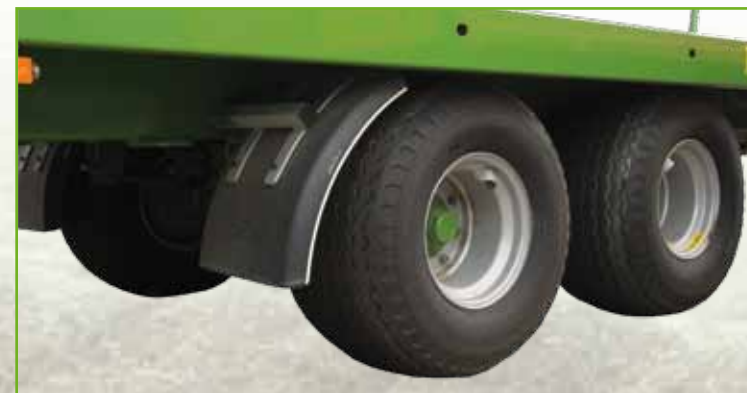
Construite sur un châssis de type tandem
