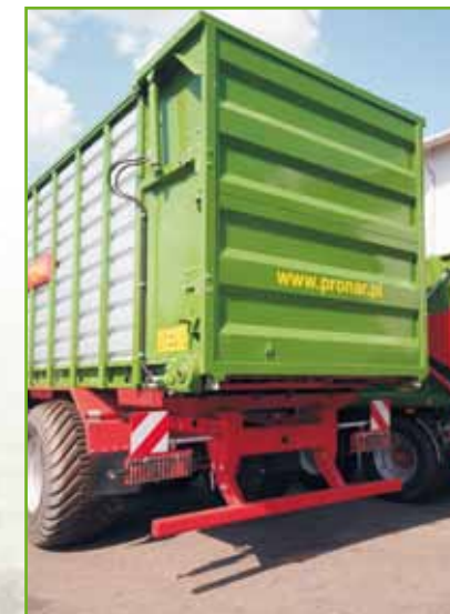
Paroi arrière à relevage hydraulique
