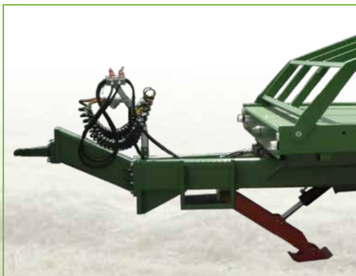
Béquille du timon hydraulique « ciseaux »
