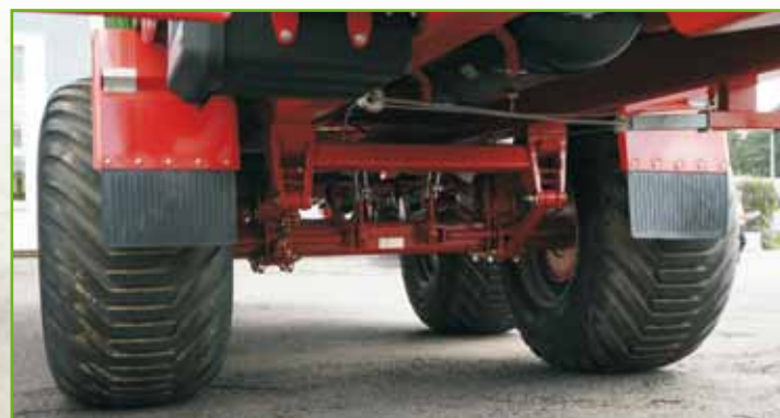
Tandem sur ressorts paraboliques avec essieux suiveurs forcés
