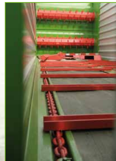
Plaque de plancher en bois avec glissières métalliques pour les chaînes du convoyeur
