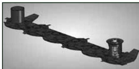
Protections amovibles du raccord à cardans
