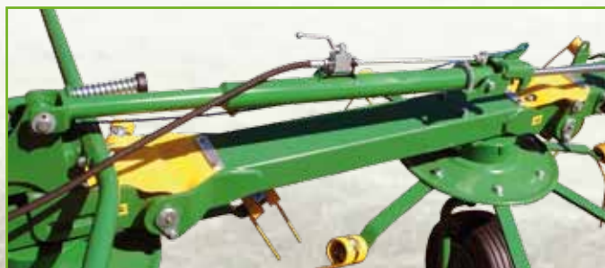
Dépliage et repliage des toupies synchronisé - système hydraulique
