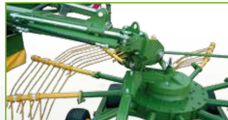
Vérins hydrauliques réglant la largeur de travail de la machine – 7-8 m
