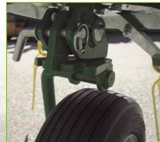
Réglage de l'angle de fanage - inclinaison f3, f6, 19
