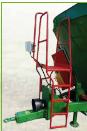
Échelle avec marches d'accès
