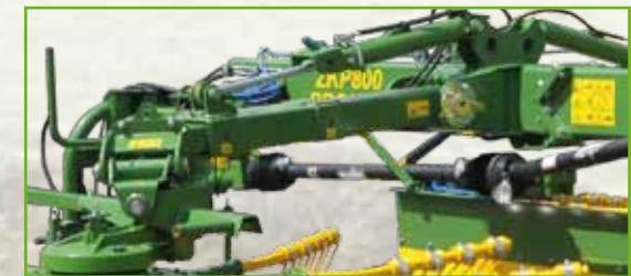
Levage et abaissement des bras de l'andaineur synchronisés, à commande hydraulique.
