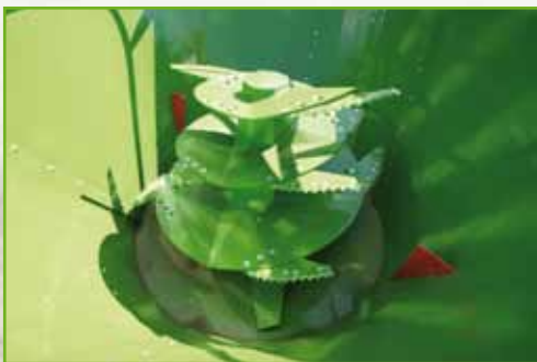
Mélangeur à vis quatre couteaux
