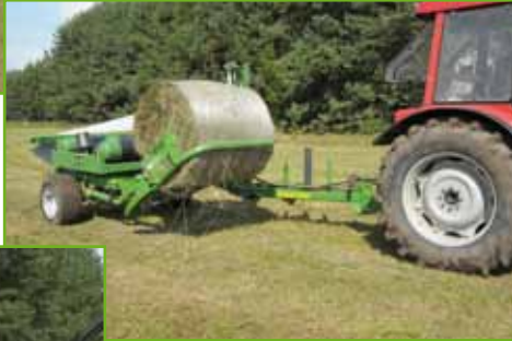
Chargement frontal en avançant vers le côté de la balle
