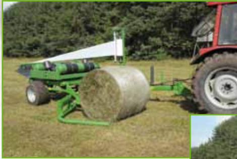
Chargement frontal en avançant vers le côté de la balle
