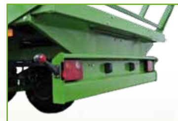
Protection anti-encastrement arrière avec éclairage arrière intégré
