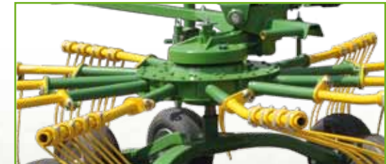
Boîtier de transmission toupie « à sec »
