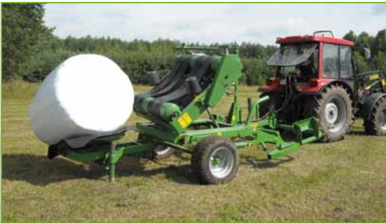
Possibilité de déposer les balles sur le côté ou à l'avant
