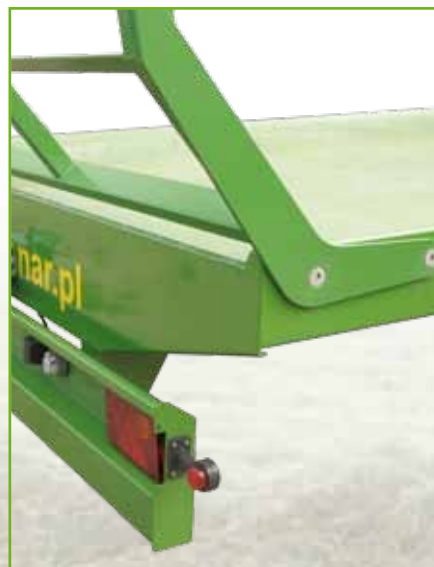
Installation d'éclairage avec feux de gabarit latéraux
