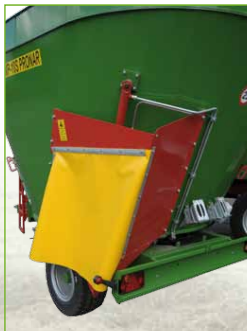
Trappes de vidange disposées en diagonale
