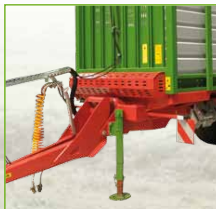
Béquille du timon droite, mécanique, télescopique
