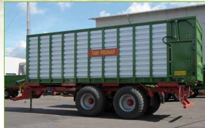
Parois en profilés trapézoïdaux avec revêtement ALU-ZINC
