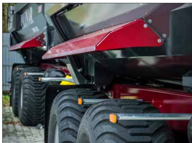
Garde-boue en plastique derrière la roue arrière et avant + un couvercle en métal au-dessus des roues (standard)
