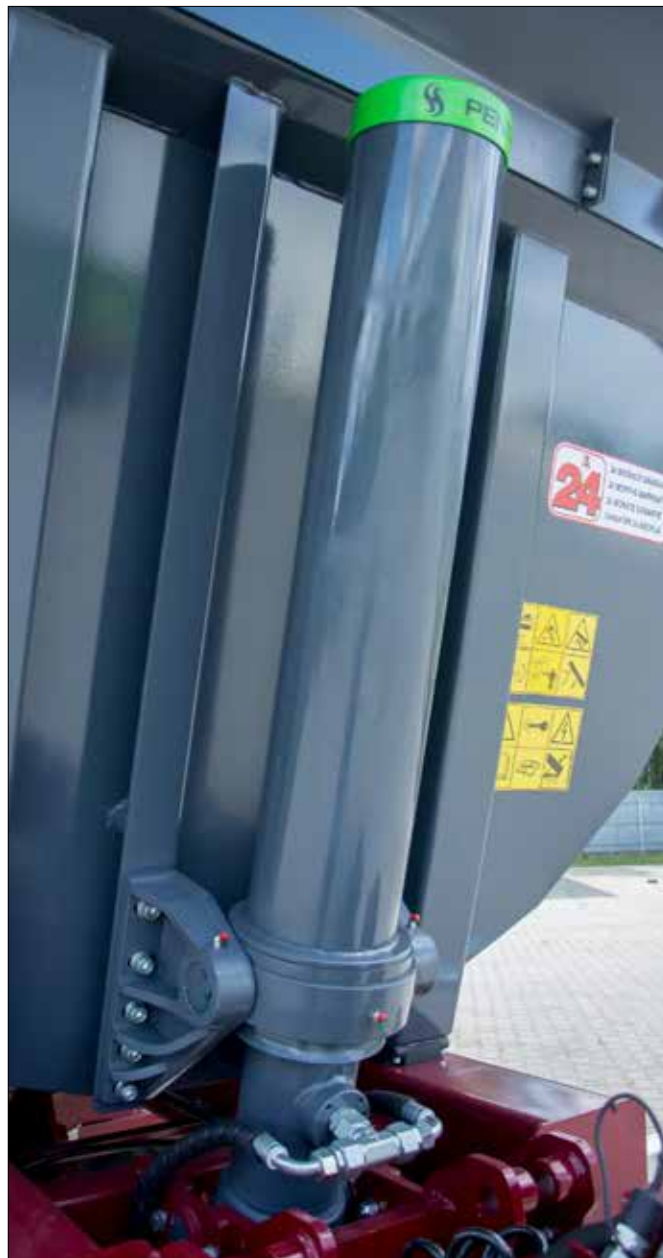
Vérin de basculement avant télescopique
