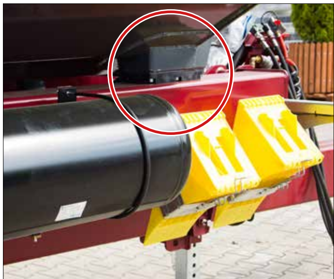
Amortissement en caoutchouc de la caisse de chargement
