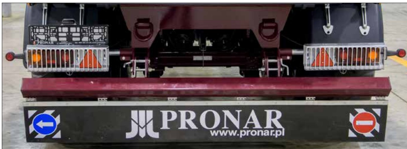
Tablier arrière (standard) + 2 Anneaux d'attelage sur la poutre arrière du châssis (standard) Installation d'éclairage 12V (LED), avec connexions hermétiques, avec éclairage d'encombrement
