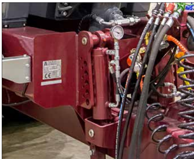
Flèche amortie par 2 vérins hydrauliques (option)
