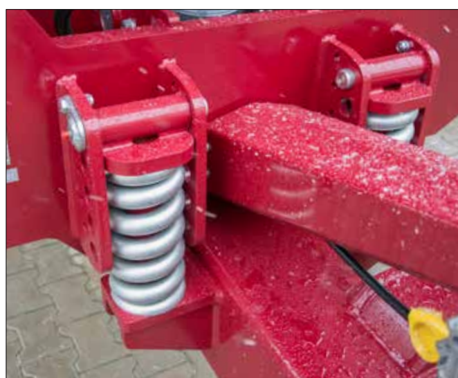
Flèche amortie par 2 ressorts en acier (standard)
