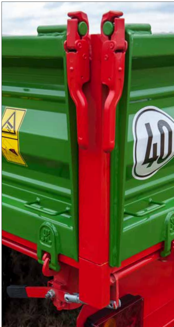
Verrouillage des parois latérales et arrières
