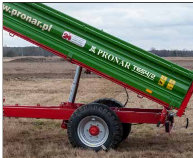
La caisse descend sous son propre poids
