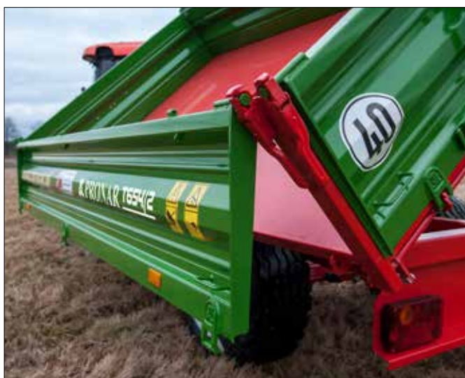
Parois profilées soudées au laser PF500 mm
