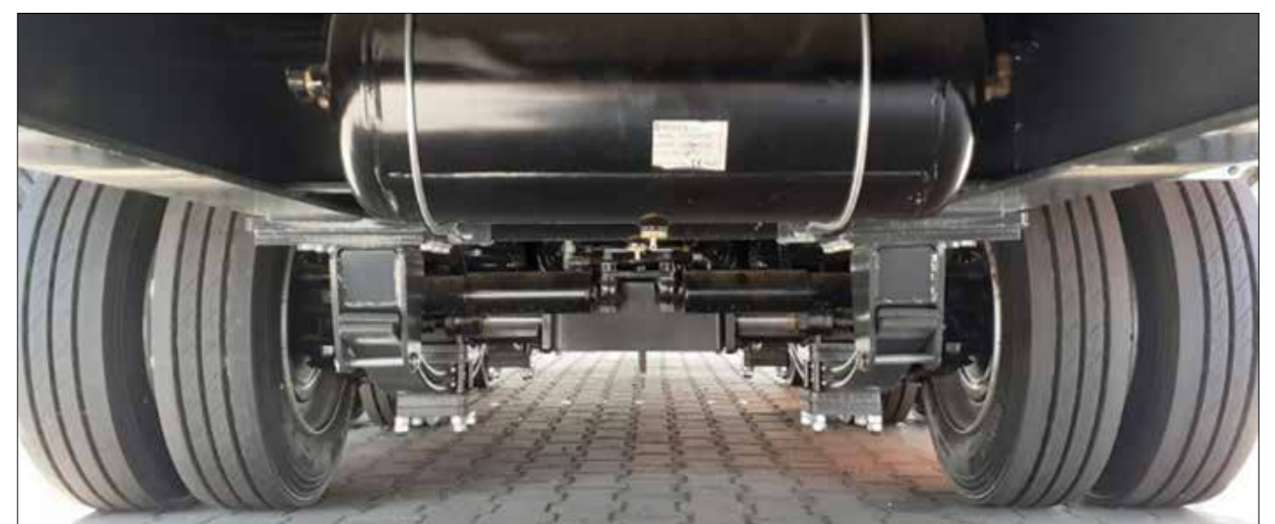
Suspension mécanique à ressorts paraboliques avec essieu suiveur arrière (standard)
