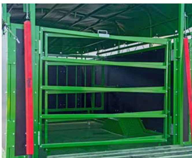
Barrières internes fixes
