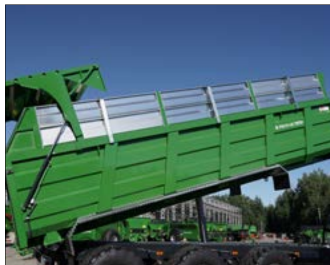
Cinq renforts latéraux inclinés de chaque côté, avec un rebord supérieur renforcé
