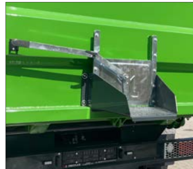
Gouttière à la trappe aux grains
