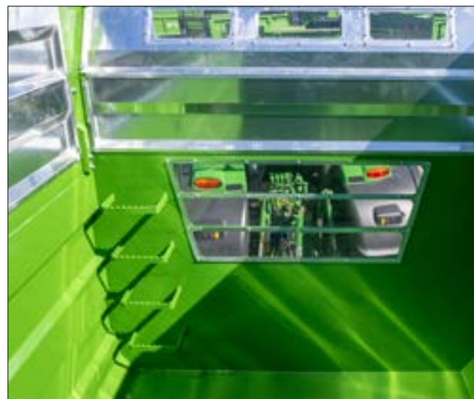
Échelle à l'intérieur de la caisse
