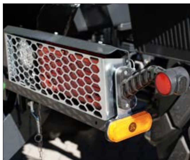
Grilles de protection
