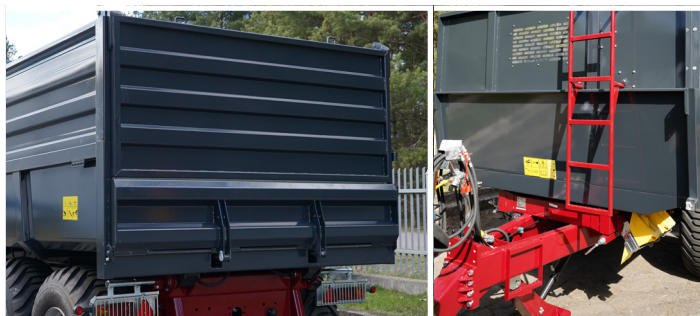
Rehausses de 800mm disponibles en option pour augmenter le volume de chargement
