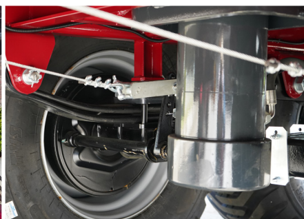
Suspension tandem avec bras longitudinaux; équipé de demi-essieux avec freins à tambour
