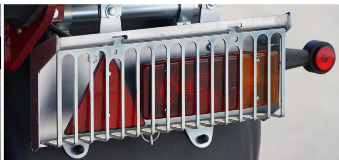
Feux arrière avec de grilles de protection pour garantir la sécurité
