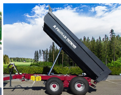
Un angle de basculement élevé permet un déchargement rapide
