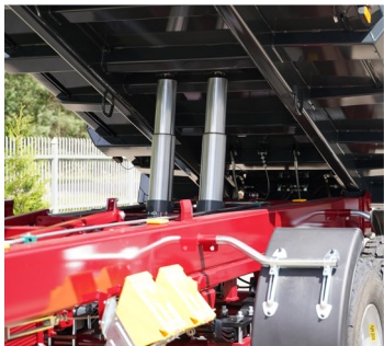
Deux vérins télescopiques pour une sécurité de déchargement optimisée
