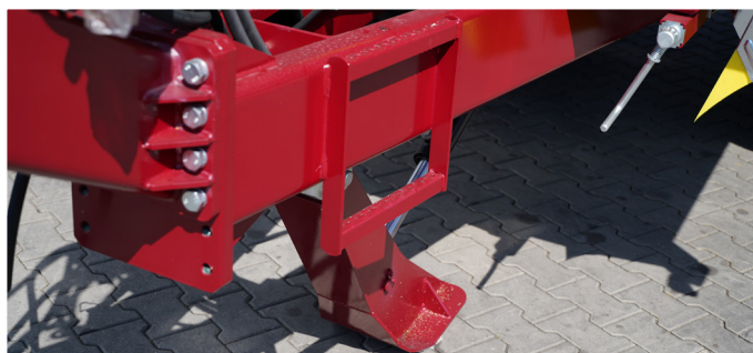
Béquille hydraulique inclinable disponible en série, en option béquille hydraulique avec vanne à bille sans supplément de prix
