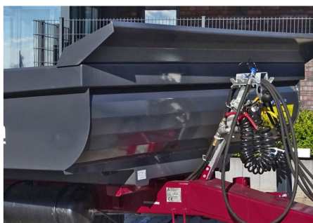
Paroi avant arrondie de la benne de chargement pour une déchargement facilité par un godet de fouille
