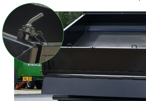
Hayon oscillant pour un déchargement plus confortable
