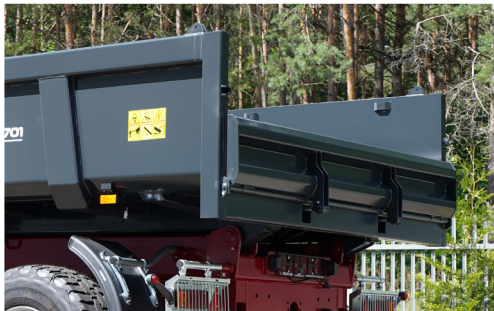
Hayon hydraulique d'une hauteur de 370 mm
