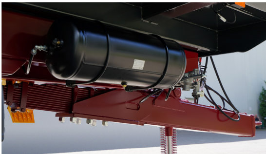
Le timon à suspension augmente le confort de conduite
