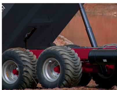
Châssis tandem avec freins à tambour 300x90mm
